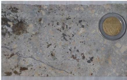
**Fotografía 13.** Venilla de magnetita de 0.2 cm., pirita, calcopirita y bornita de manera diseminada.
