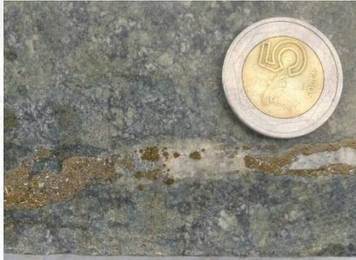
**Fotografía 12.** Venilla de sílice de 0.7 cm con pirita, pirrotita y calcopirita, patinas de clorita epidota.
