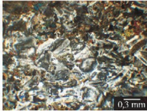
**Figura 4. Textura equigranular (monzonita, Nx). Minerales según Kretz (1983)**
