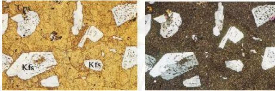
*Figura 3b. Textura merocrystalina Fenocristales de Feldespato Potásico (Kfs) y pequeños cristales de clinopiroxenos (Cpx) en una matriz microcrystalina a vítrea con textura perlítica (riolita x7, N// y Nx). Minerales según Kretz (1983)*
