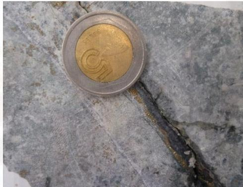
**Fotografía 11. Muestra de mano, venilla de magnetita de 0.5 cm., pirrotita y pirita en los bordes de la venilla y de manera diseminada, pátinas de epidota y clorita en una matriz silicificada.**
