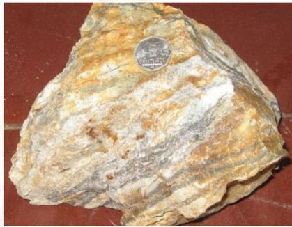
**Fotografía 17.** Muestra MM-11, venillas de Silice Gris, presencia de limonita, hematita.
