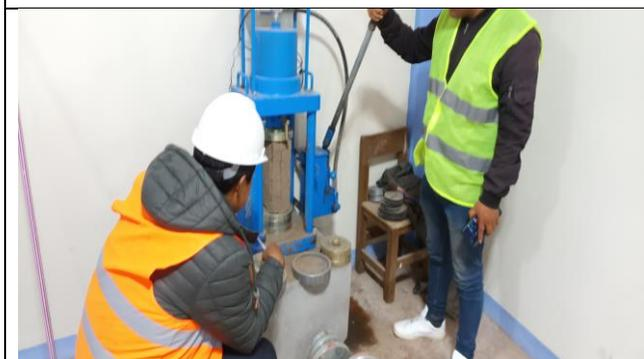
Ensayo de resistencia a la compresión.
