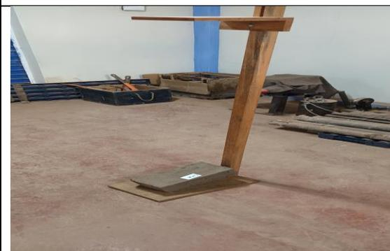
Ensayo de erosion acelerada.
