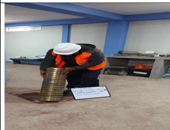
Ensayo de tamizado del material.
