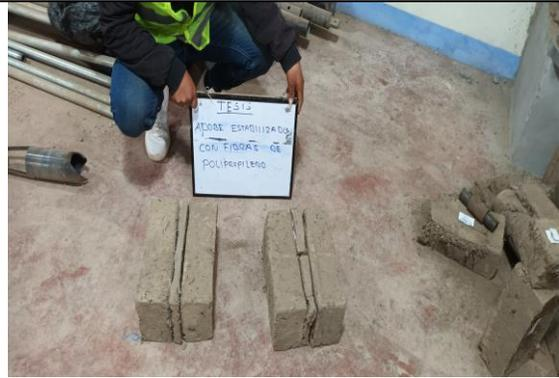
Ensayo de resistencia a la compresión del mortero
