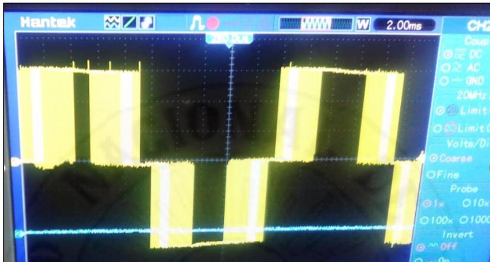
Figura N° 4. 21 Conformación alternada de pulsos SPWM con FPGA, a) En modo de simulación. b) En modo real medido en el osciloscopio.
