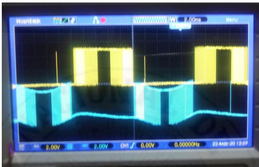
Figura N° 4. 20 Conformación de pulsos SPWM con FPGA. Color amarillo (Pulsos SPWM comba positiva); Color celeste (Pulsos SPWM comba negativa).
