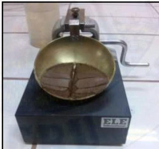
**Fotografía 8:** Cierre de ranura en (1/2pulg.) y cuarteo de muestra.
