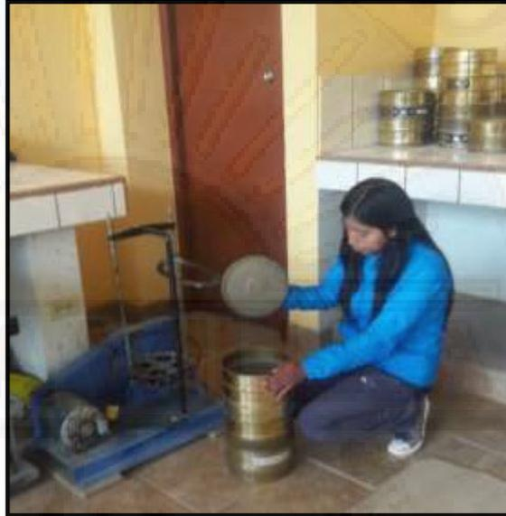
**Fotografía 15:** Realización del Análisis Granulométrico.
