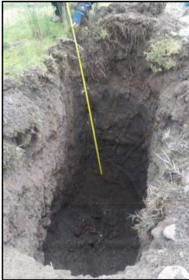
**Fotografía 22:** Medición de la profundidad de la calicata.
