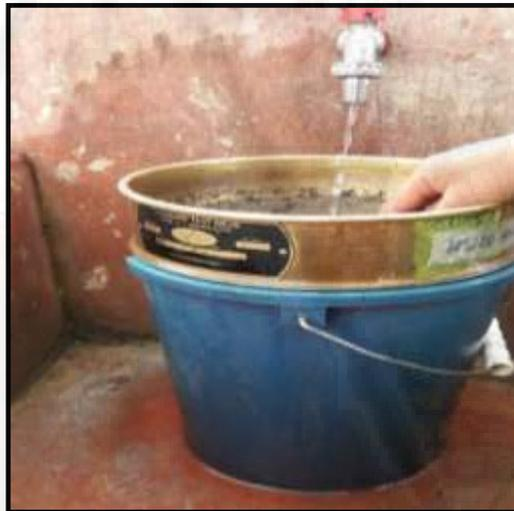
**Fotografía 14:** Lavado de muestra seca a través del tamiz N° 200.
