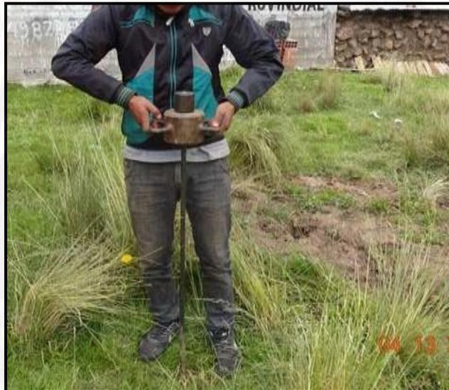
**Fotografía 3:** Se visualiza la realización del ensayo DPL.
