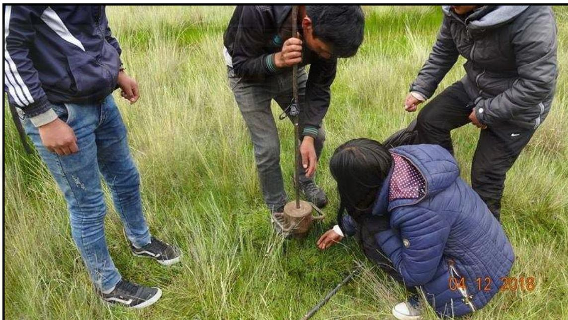
**Fotografía 31:** Se visualiza la ejecución del ensayo DPL-17
