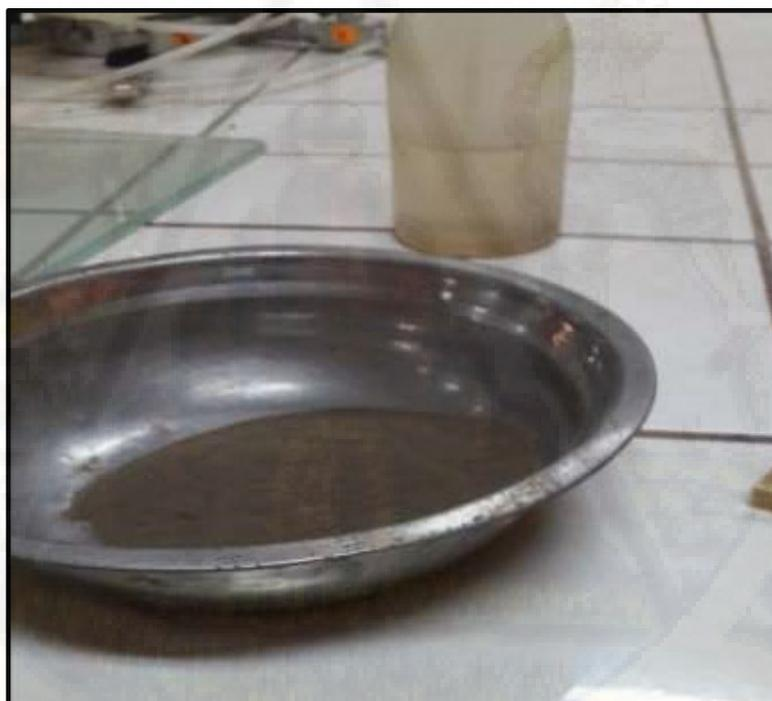
**Fotografía 42:** Preparación de muestra para la elaboración de Límites de Atterberg.
