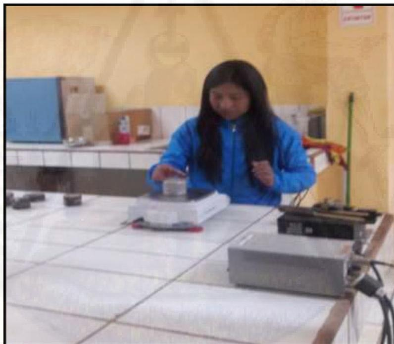
**Fotografía 48:** Peso de Límite Líquido y Límite Plástico para la obtención del contenido de humedad.
