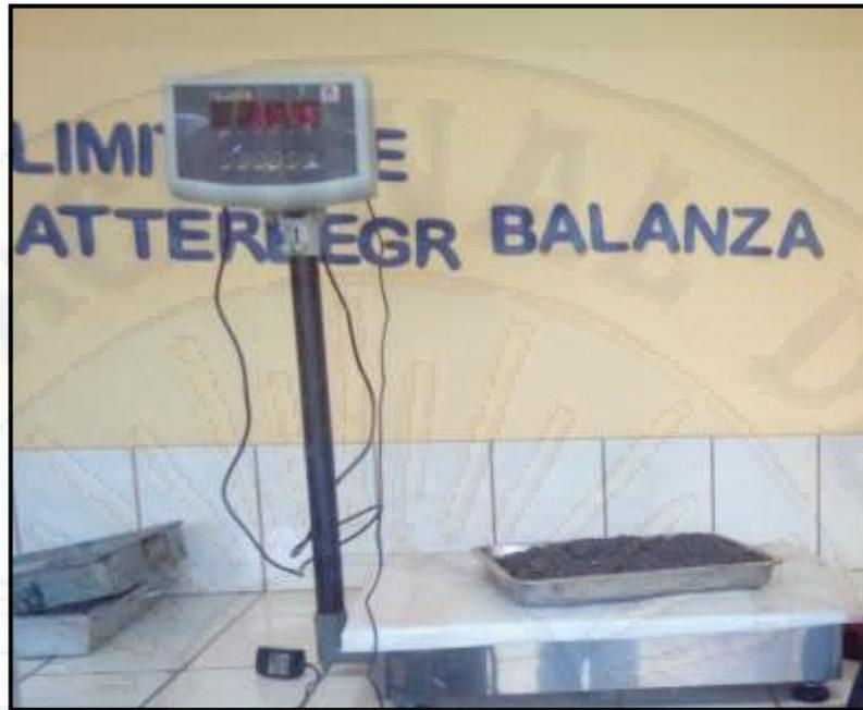
**Fotografía 39:** Peso de muestra seca para el tamizado.
