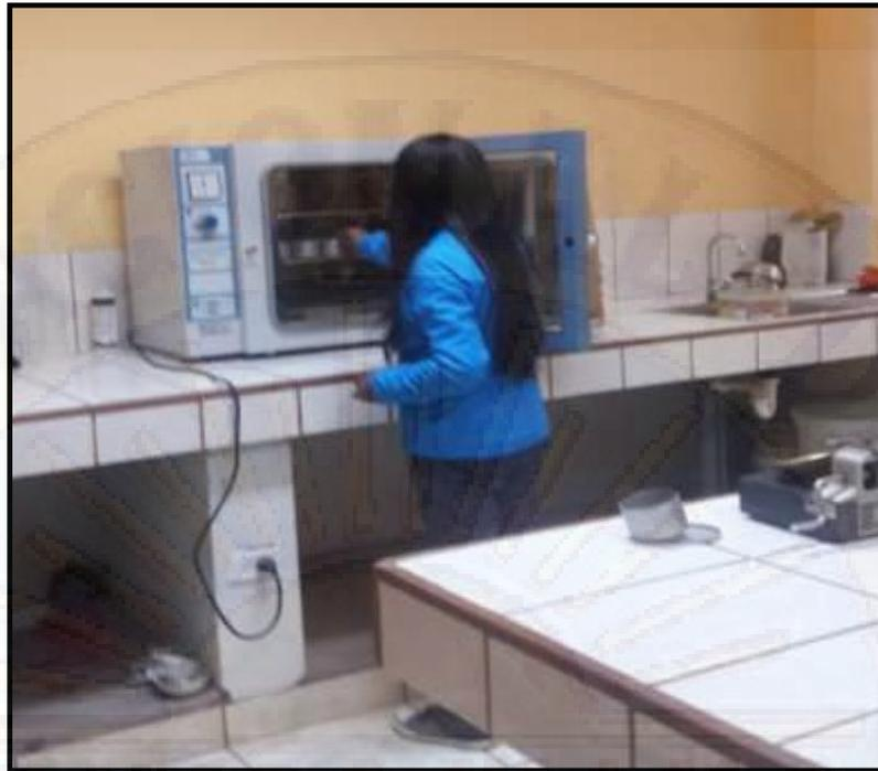
**Fotografía 47:** Secado de Límite Líquido y Límite Plástico en horno (24 horas).
