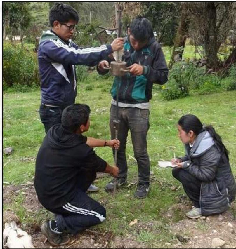
**Fotografía 30:** Ejecución del ensayo DPL-9
