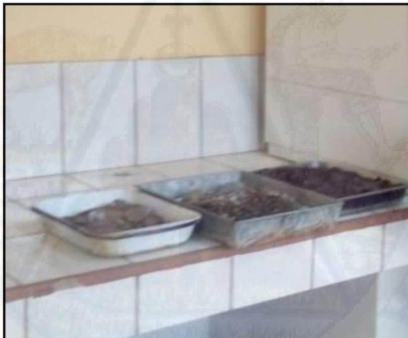
**Fotografía 36:** Muestra secada en horno (24 horas).
