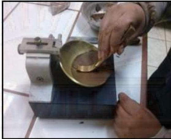
**Fotografía 7:** Muestra ranurada en dos con el acanalador.
