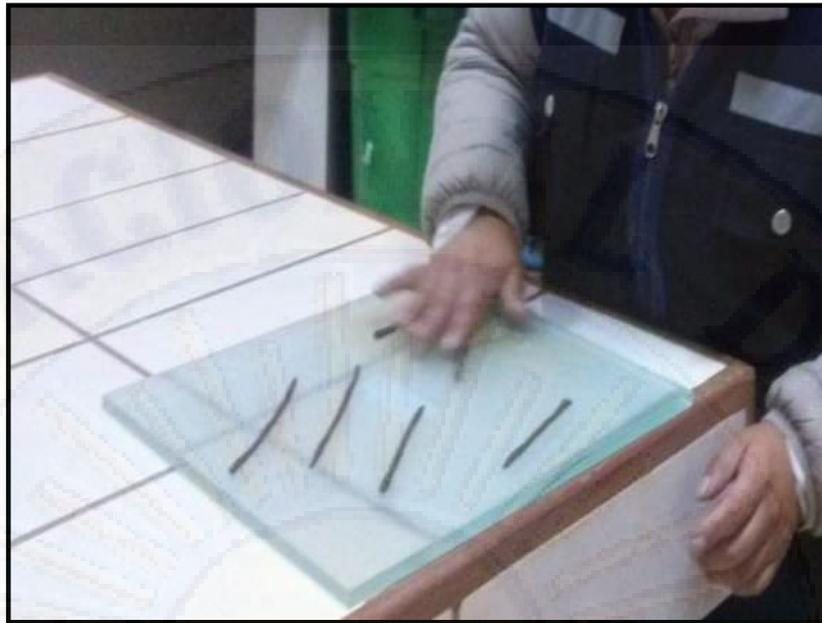
**Fotografía 43:** Realización de ensayo de Límite Plástico.
