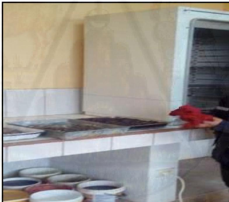
**Fotografía 38:** Secado de muestra lavada en horno (24 horas).
