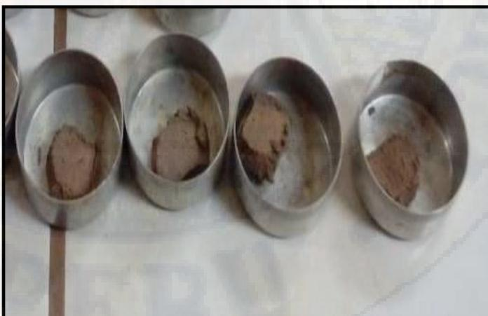
**Fotografía 10:** Muestra seca y pesada para hallar el contenido de humedad.
