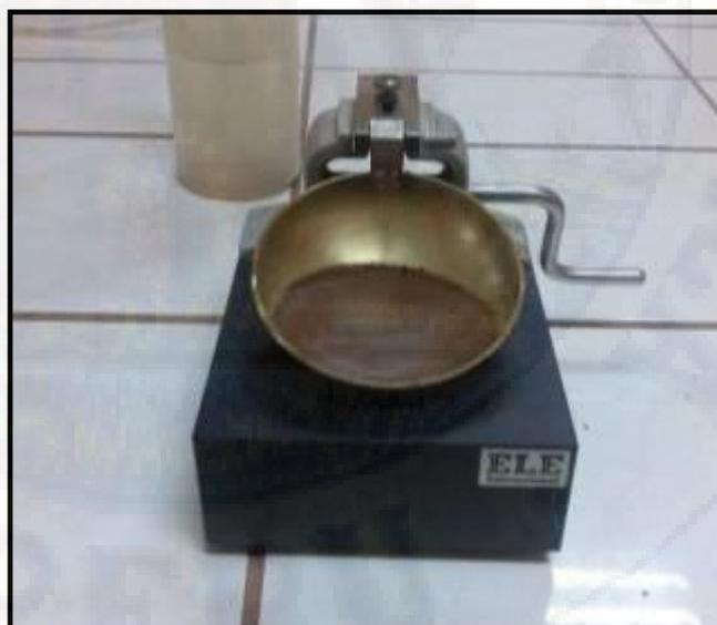
**Fotografía 6:** Muestra húmeda nivelada en la Copa Casagrande.
