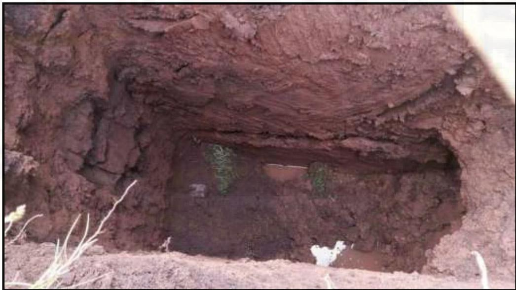
**Fotografía 25:** Se visualiza la presencia de nivel freático en calicata C5.
