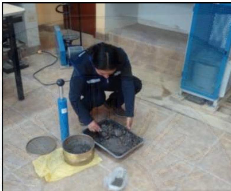
**Fotografía 41:** Tamizado de muestra seca por la malla N° 40 para la realización de Límites.
