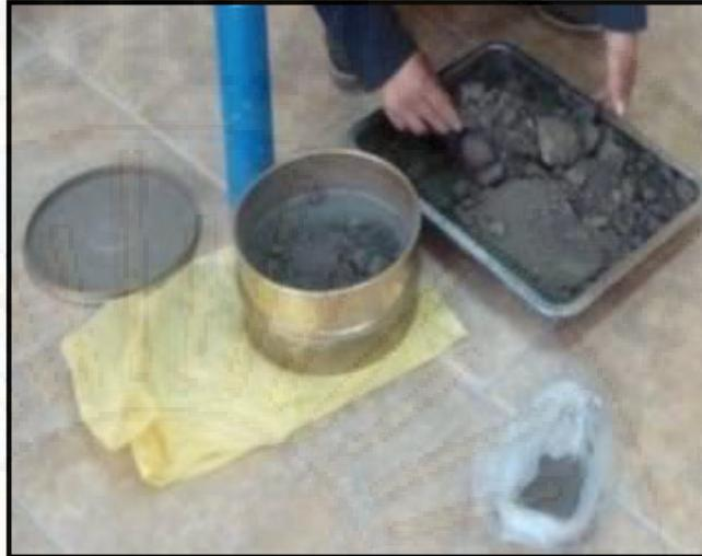
**Fotografía 5:** Tamizado de muestra seca por el tamiz N° 40.
