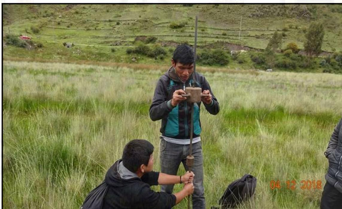
**Fotografía 32:** Se visualiza la ejecución del ensayo DPL-16
