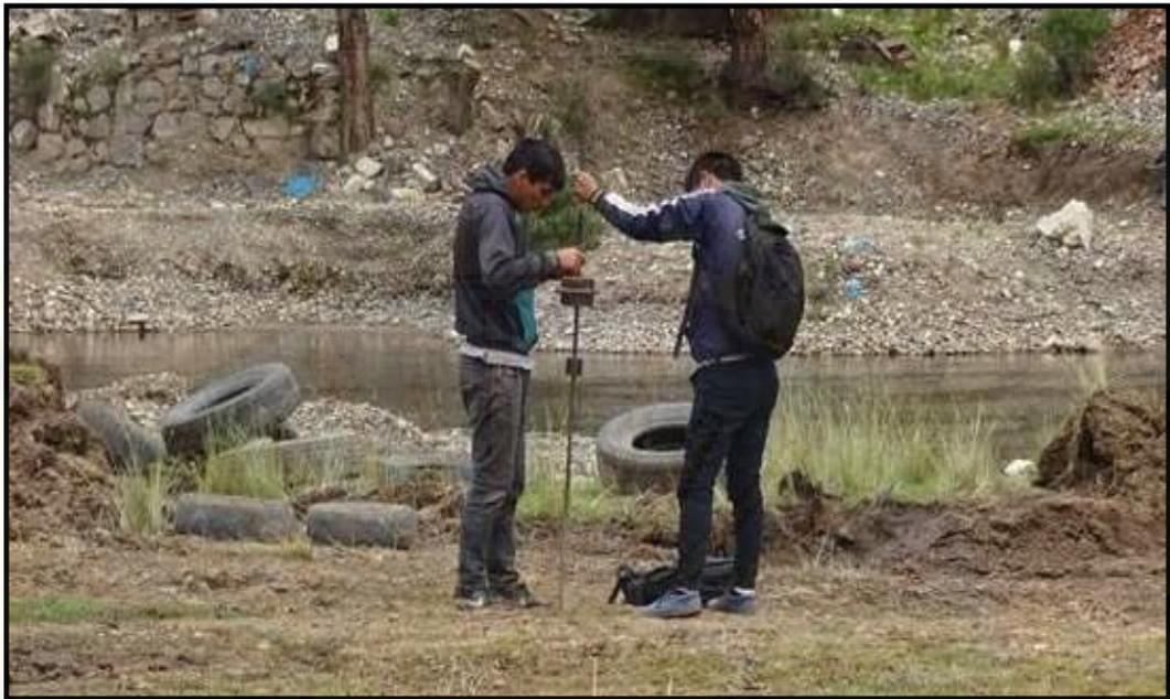
**Fotografía 33:** Se visualiza la ejecución del ensayo DPL-6.
