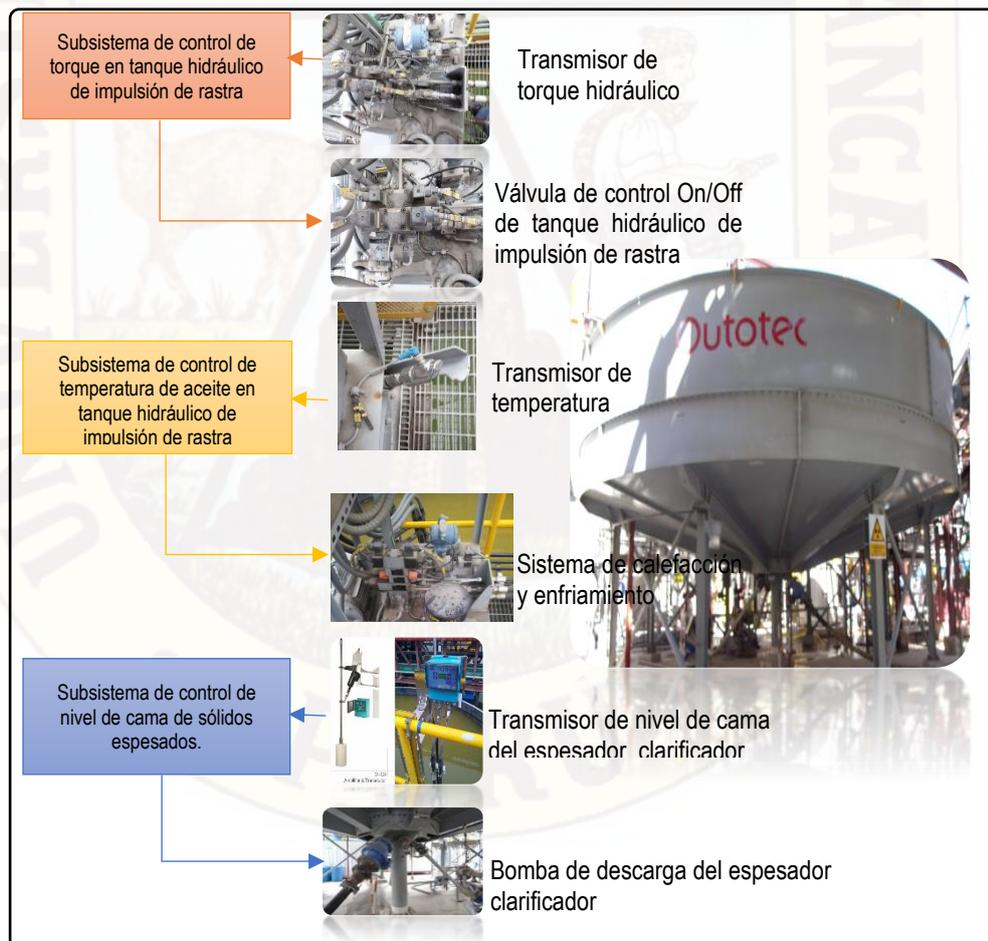
**Figura 4.1.** Diagrama general del sistema de control automático para mejorar la operación de la rastra del espesador clarificador de molibdeno.
