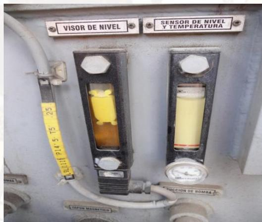
**Figura 2.7.** Switch de nivel de aceite del tanque hidráulico de la rastra<sup>17</sup>
