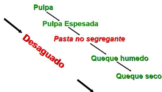
**Figura 2.15.** Diagrama simplificado de los rangos de espesamiento. (Golder 2005)
