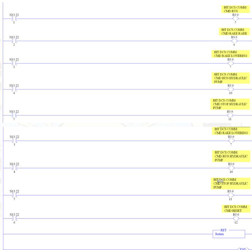
**Figura 4.20.** Mapeo de señales a sala de control principal (continuación).
