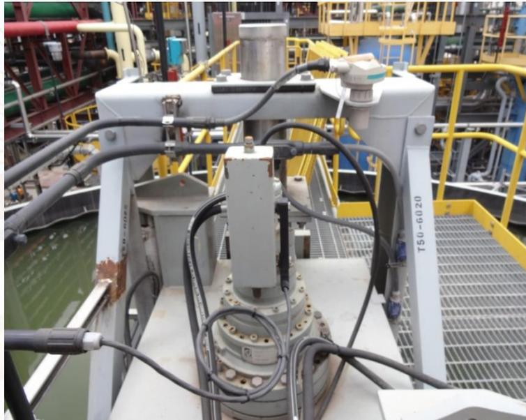
Figura 2.11. Instrumentación del indicador de posición de la rastra<sup>21</sup>
