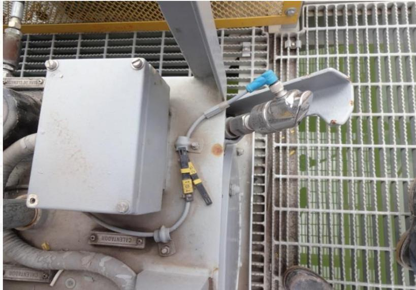
**Figura 2.8.** Switch de temperatura alta y baja del tanque hidráulico de la rastra<sup>18</sup>
