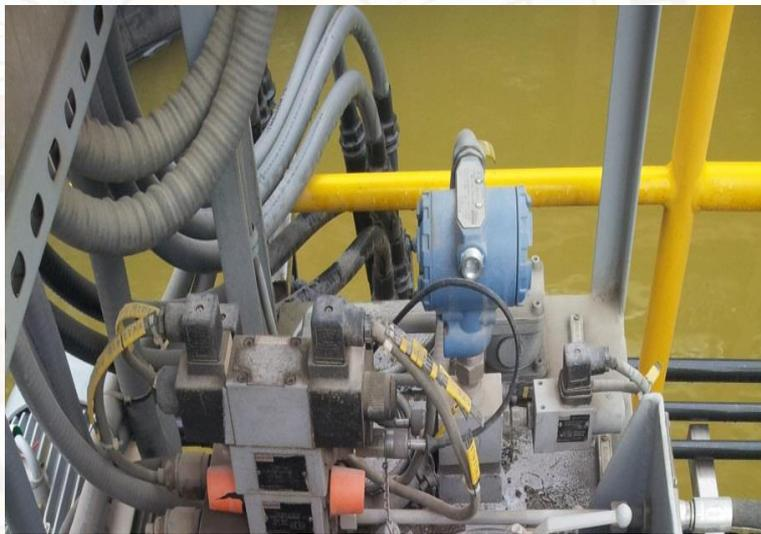
**Figura 2.6.** Trasmisor de torque del tanque hidráulico de la rastra<sup>16</sup>
