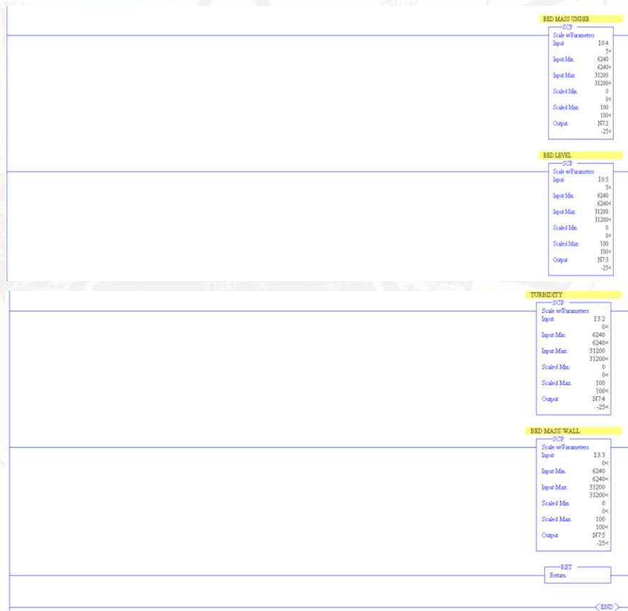
Figura 4.14. Escalamiento de Nivel de cama y turbidez.
