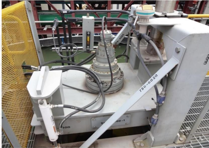
**Figura 2.4.** Motor hidráulico de la rastra<sup>12</sup>
