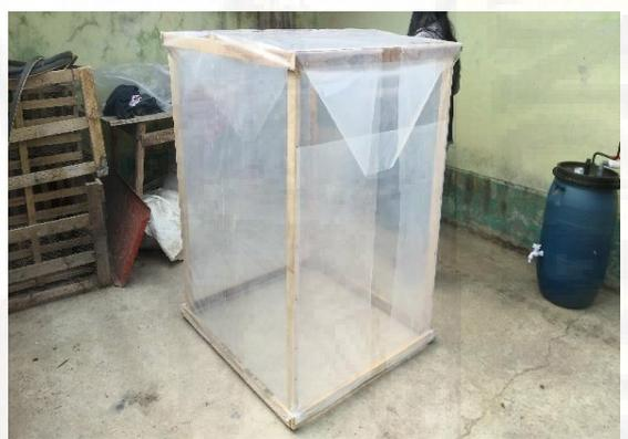
*Fotografía 19.* Presentación de la estructura completamente forrado, que fue realizado con chinchos – clavos.
