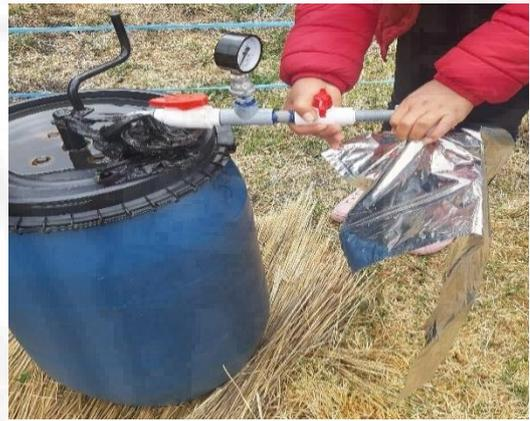
*Fotografía 13. Presentación del prototipo con la llave para la salida de biol y la colocación de la bolsa para el almacenamiento de biogás.*
