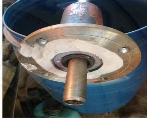
*Fotografía 6. La paleta fue soldada a un tubo, para luego colocarlo en los rodajes así pueda girar dentro del prototipo.*
