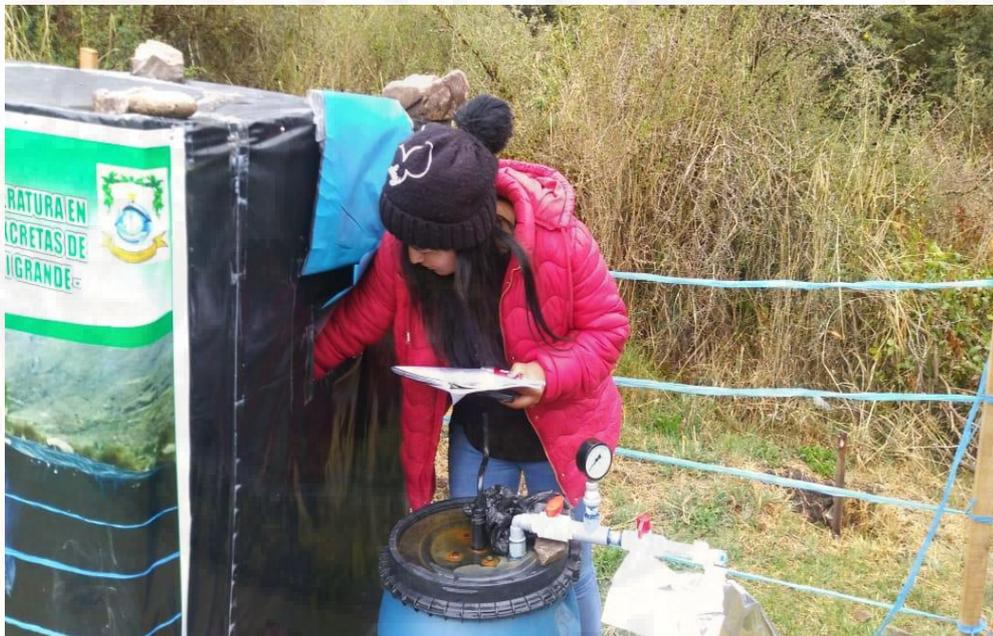
*Fotografía 32. Recolección de datos de presión y temperatura en la estructura con acondicionamiento.*
