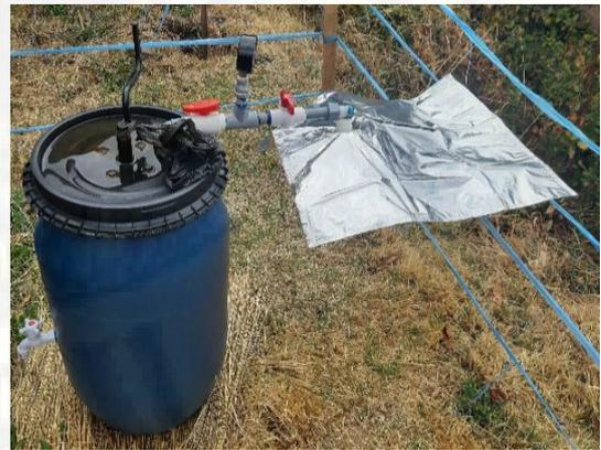
*Fotografía 14. La colocación de la bolsa de almacenamiento se hizo con teflón y pegamento, evitando fugas de biogás durante todo el proceso de recolección de datos.*
