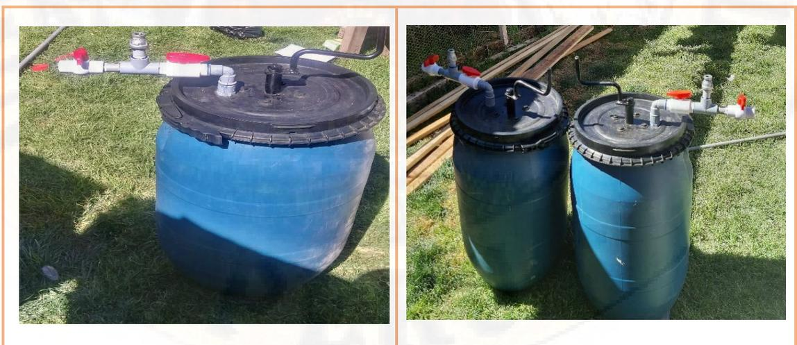
*Fotografía 11. Presentación de los dos biodigestores con todos los accesorios.*
