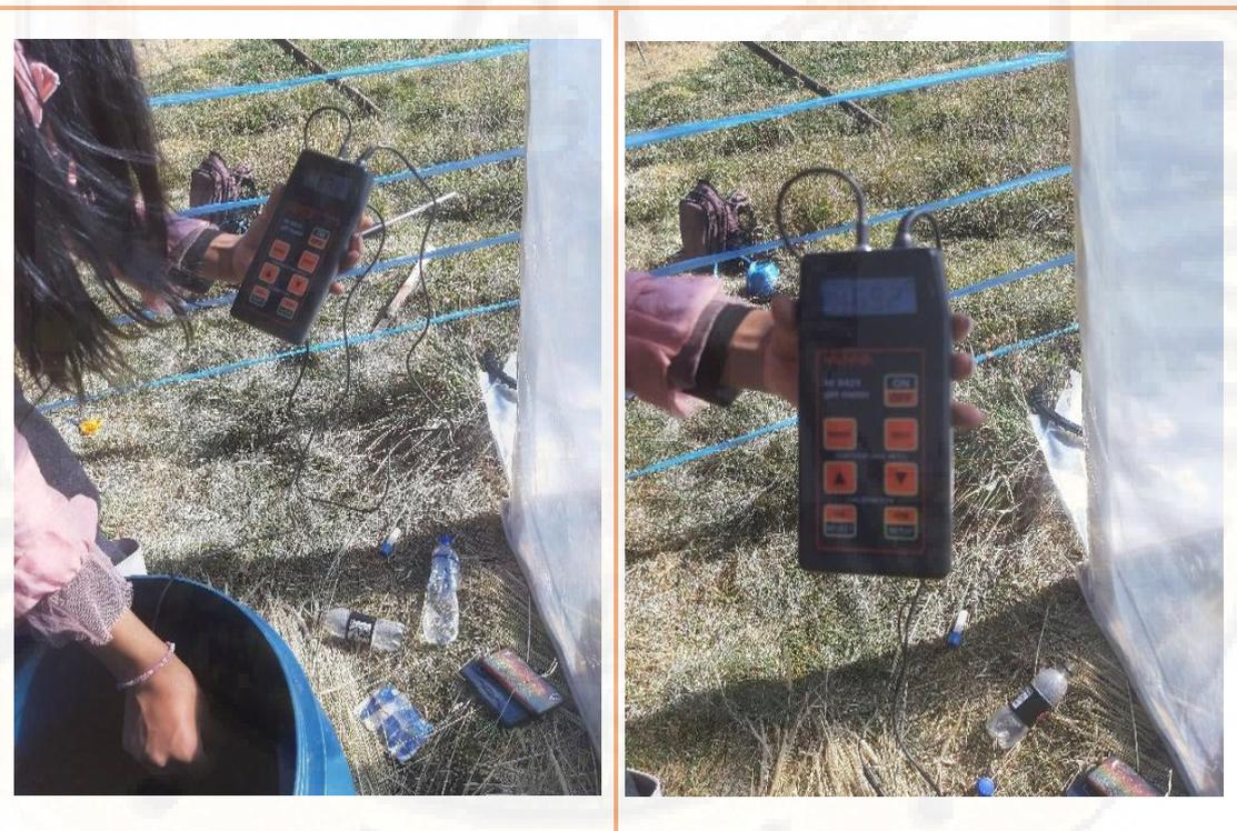
*Fotografía 28. Medición del pH dentro del biodigestor para ya poner en funcionamiento y realizar la recolección de datos*
