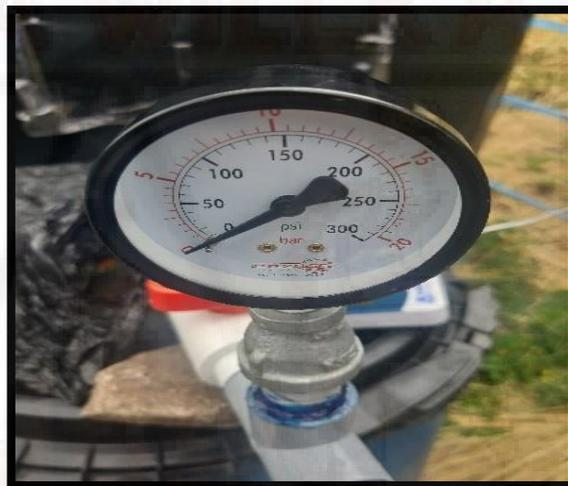
*Figura 16. Manómetro de aire (enzo-sf).*
