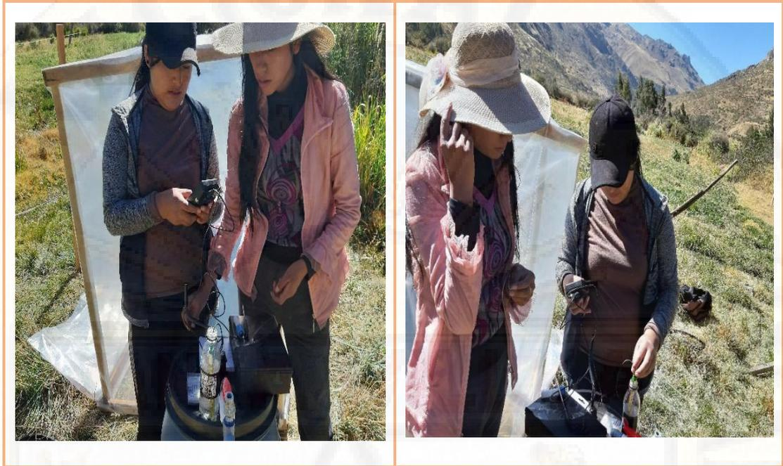
*Fotografía 27. Calibración del pH metro para proceder a medir el sustrato dentro del biodigestor.*
