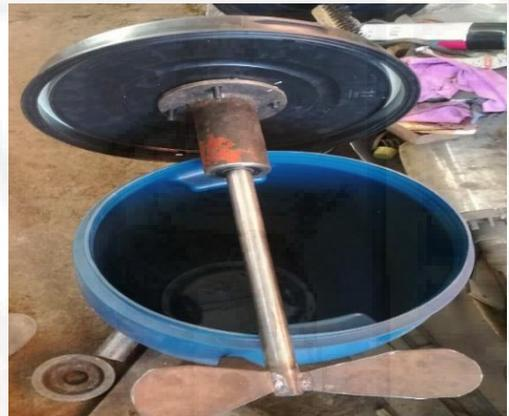
*Fotografía 7. Se realizó 4 agujeros en la tapa del biodigestor para colocar la paleta ya unida con la manija.*
