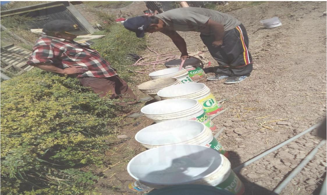
Fotografía N° 7. Medir con una regla los lisímetros, (25m, 30m, 35m.).
