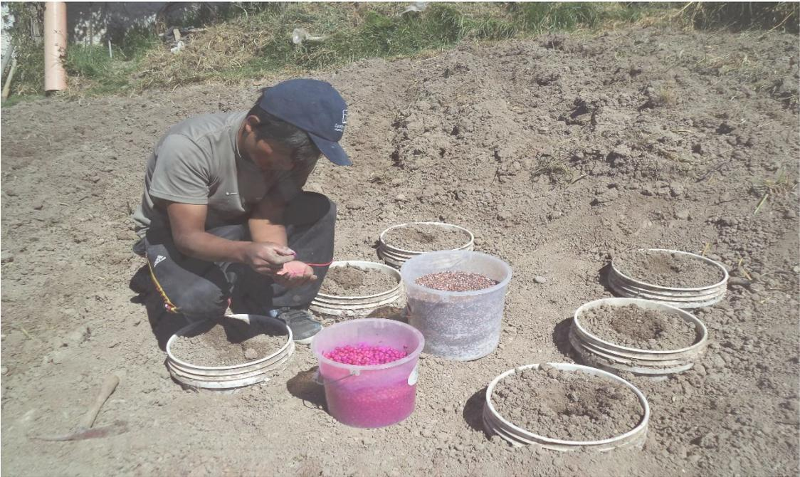
Fotografía N° 6. Incorporar agua en los lisímetros a (25 m, 30 m, 35 m).
