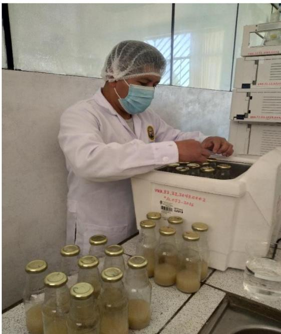
*Fotografía 2.* Preparación de la muestra para el ultrasonicador
