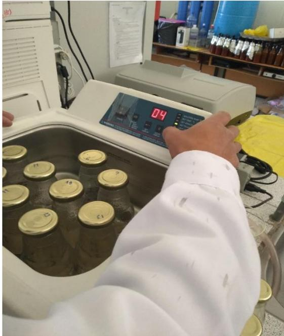
*Fotografía 3.* Programación del ultrasonificador
