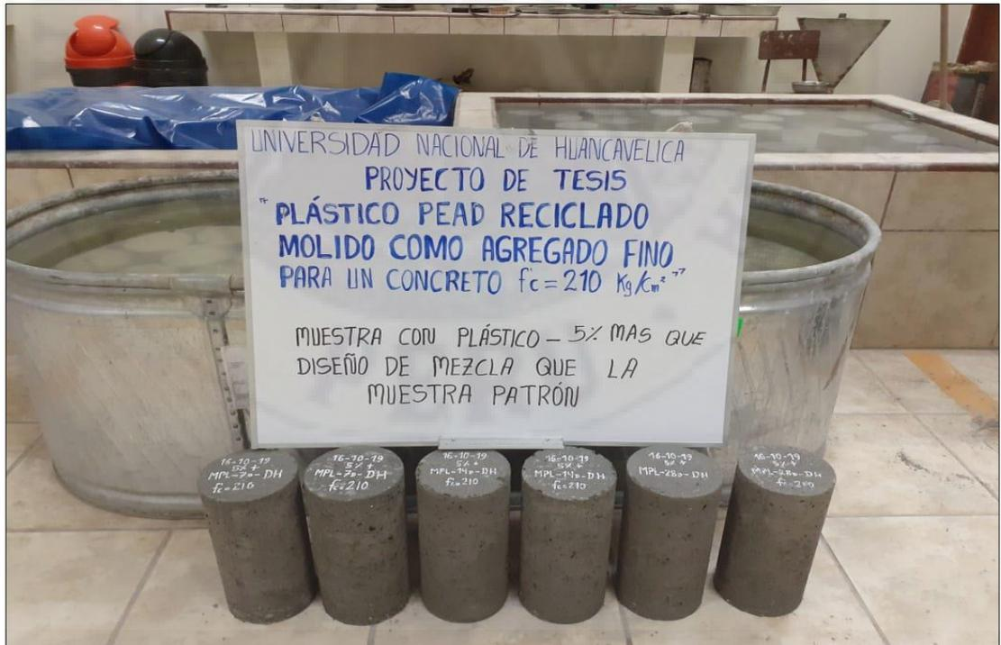
Figura 24. Muestras de concreto con el mismo porcentaje de peso del agregado fino.
