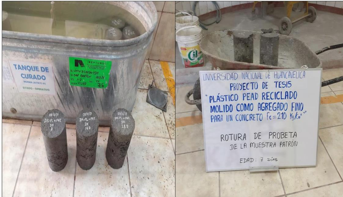
**Figura 29.** Ensayo de rotura de las muestras de concreto (5% menos de plásticos PEAD) a fin de determinar la resistencia a la compresión.
