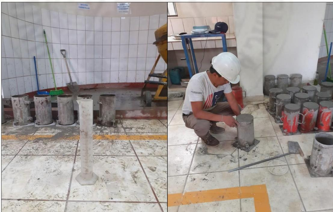
Figura 22. Curado de los testigos de concreto.
