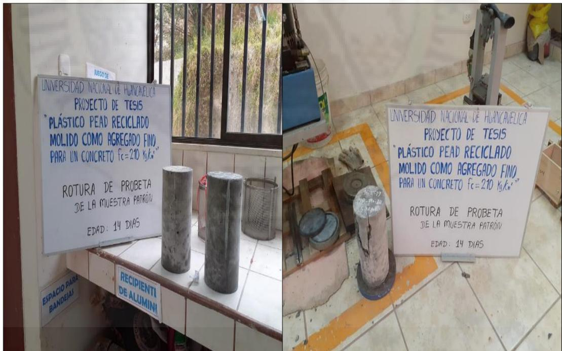
**Figura 28.** Ensayo de rotura de las muestras de concreto (muestra patrón) a fin de determinar la resistencia a la compresión.
