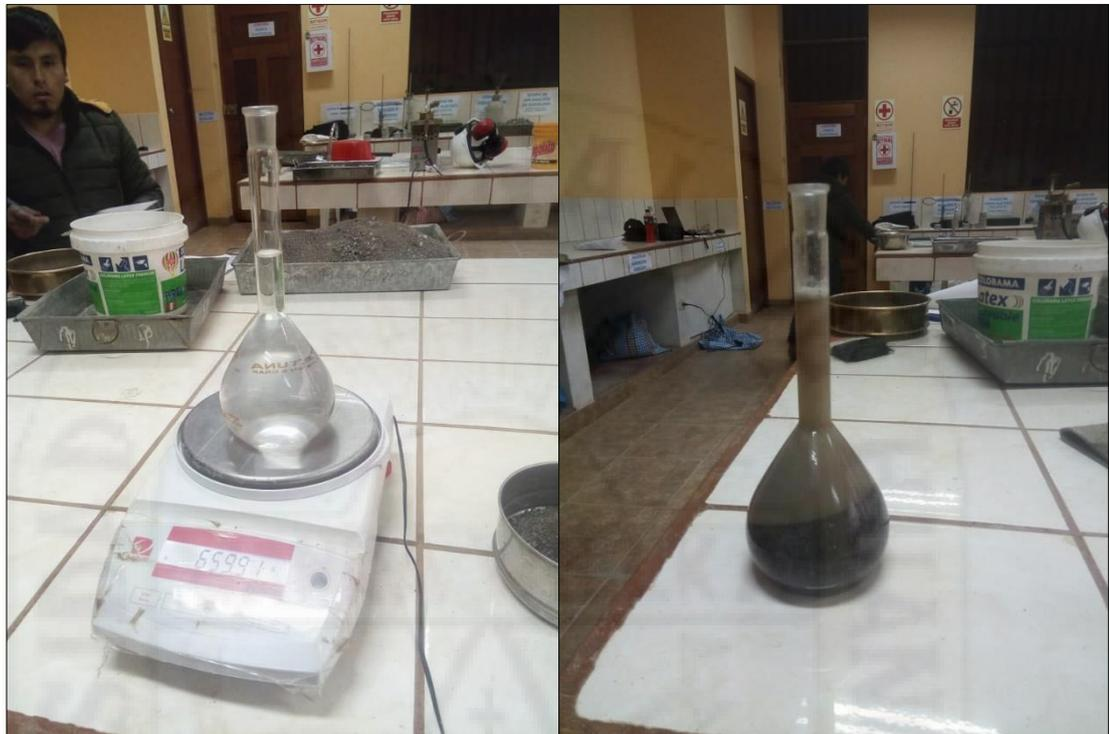
**Figura 17.** Ensayos a fin de determinar el peso específico del plástico PEAD.
