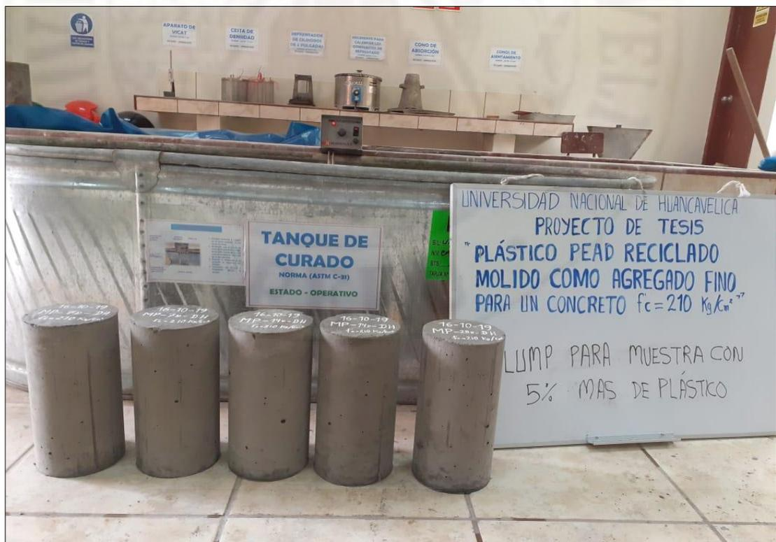
**Figura 26.** Muestras extraídas del tanque de curado en los tiempos estimados de 7, 14 y 28 días respectivamente.
