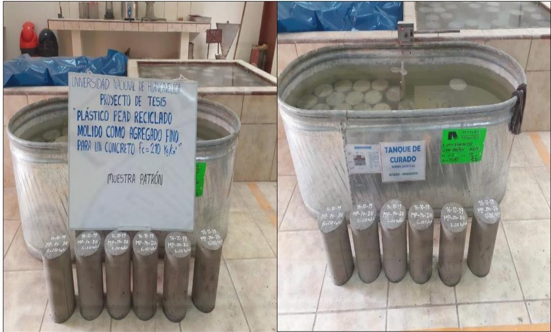
Figura 23. Muestras de concreto con un porcentaje de menos 5% del peso del agregado fino.
