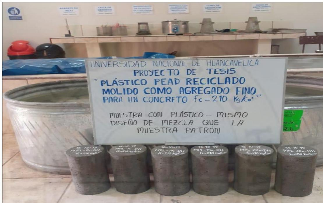
Figura 25. Muestras de concreto con un porcentaje de 5% más del peso del agregado fino.
