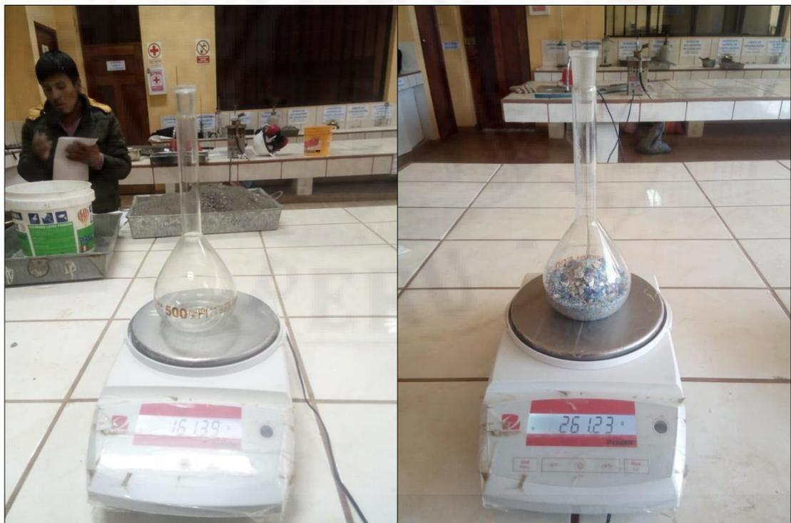
**Figura 18.** Ensayos a fin de determinar el peso específico del plástico PEAD.
