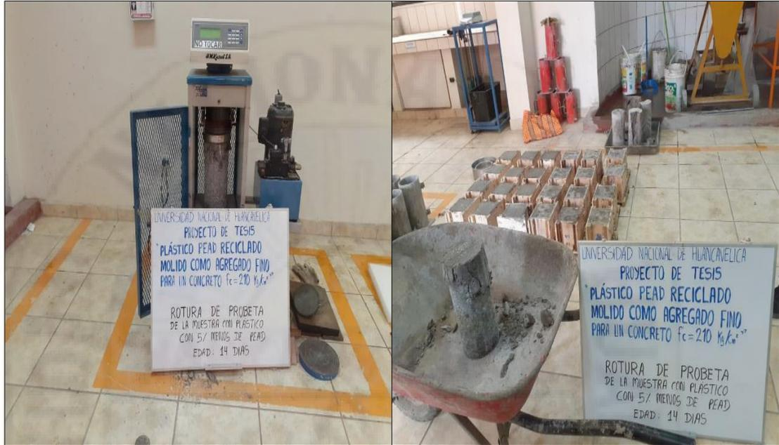
**Figura 31.** Ensayo de rotura de las muestras de concreto (5% más de plásticos PEAD) a los 7 y 14 días a fin de determinar la resistencia a la compresión.
