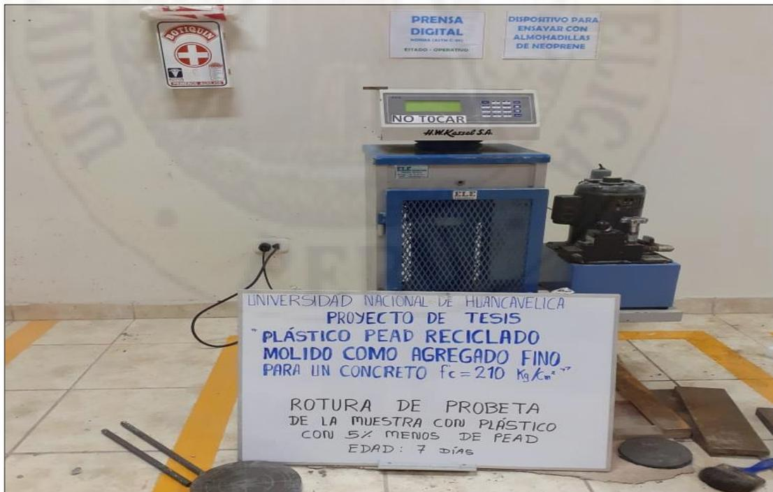
**Figura 30.** Ensayo de rotura de las muestras de concreto (5% menos de plásticos PEAD) a los 14 días a fin de determinar la resistencia a la compresión.
