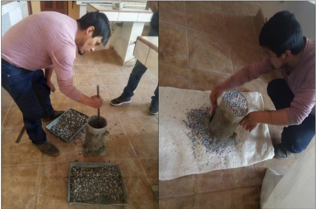
**Figura 19.** Ensayo de granulometría de los materiales.
