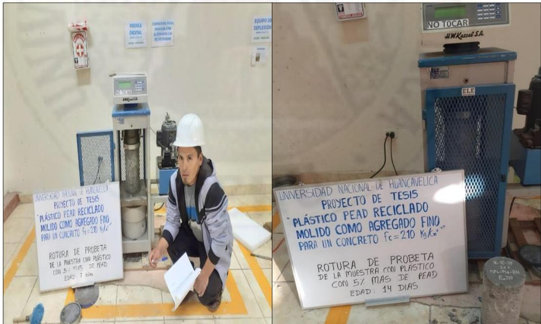
**Figura 32.** Ensayo de rotura de las muestras de concreto (con igual porcentaje de plásticos PEAD que la muestra patrón) a los 14 días a fin de determinar la resistencia a la compresión.
