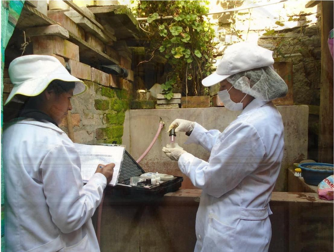
**Figura 80.** Muestra de agua potable que se torna de color rosado bajo después de la medición de cloro residual libre con el equipo fotómetro por el método colorimétrico perteneciente al barrio Miraflores.
