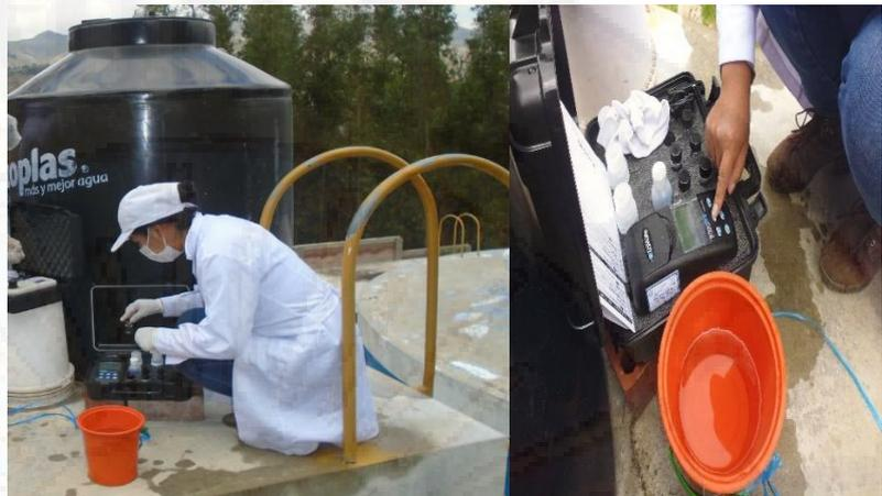
**Figura 23** Se llena en la celda de vidrio la muestra de agua a analizar hasta un volumen de 10ml, presione ENTER para seleccionar la opción de escanear muestra.
