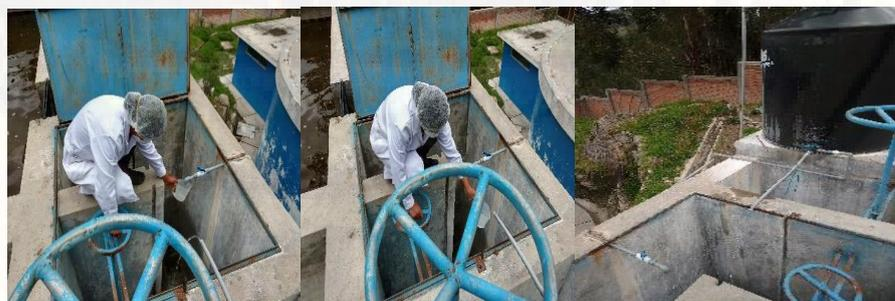
**Figura 17** Aforamiento de caudal de dosificación de solución madre de cloro aplicado en unidad de mezcla rápida.
