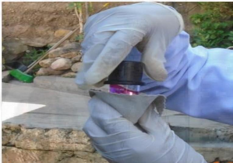
**Figura 32.** Se sacude a muestra suavemente hasta que desaparezca los cristales de DPD, luego se las paredes exteriores de la cubeta.
