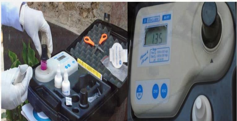
**Figura 33.** Se coloca la muestra con reactivo y se presiona el botón de lectura, luego el resultado se añota en ficha de registro.
