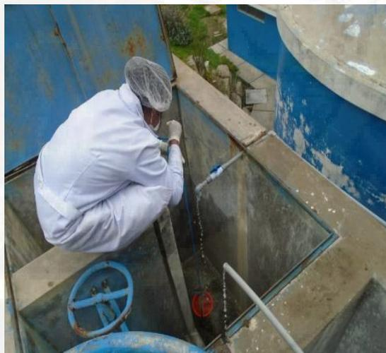
**Figura 22.** Se recolectó la muestra de agua clorada de la unidad de mezcla rápida de PTAP, utilizando un balde de 2 L.
