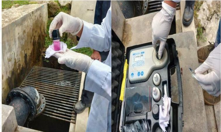
**Figura 39.** Se diluye la muestra hasta desaparecer los cristales de reactivo DPD, se coloca a la porta cubeta y se presiona la opción de lectura del fotómetro.
