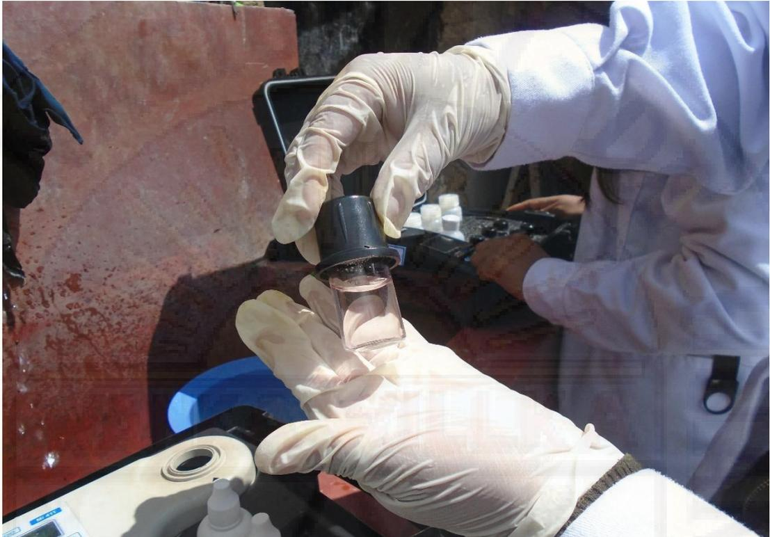
**Figura 84.** Muestra de agua potable que se torna de color rosado muy bajo después de la medición de cloro residual libre con el equipo fotómetro perteneciente al barrio Ccescehuaycco.
