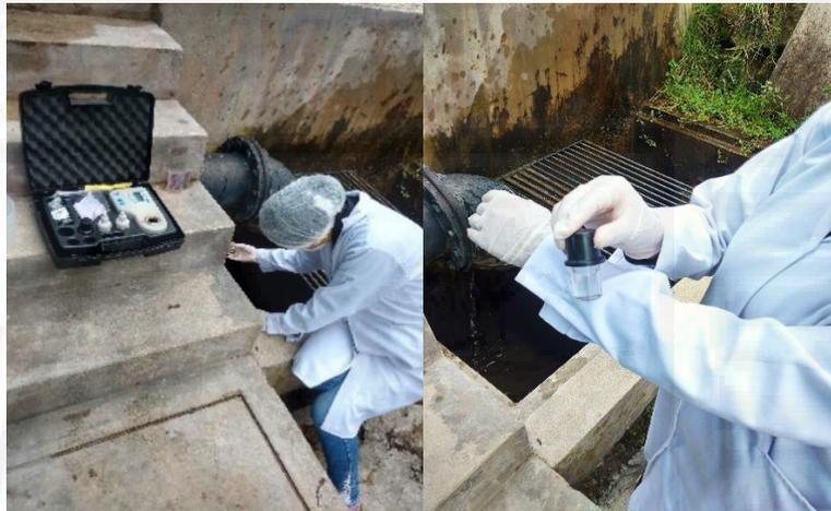
**Figura 37.** Recolección de muestra en la salida de tubería de rebose del reservorio.
