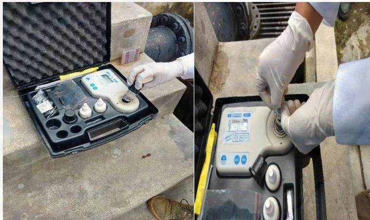
**Figura 38.** Se adiciona el reactivo DPD a la muestra de agua de 10 mL contenida en la celda de muestra.
