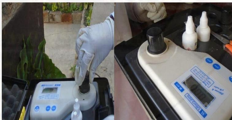
**Figura 30.** La muestra de agua se inserta a la porta cubeta, luego presiona ZERO y unos segundos se visualice 00.00, esto indica que el equipo está listo para medir el cloro residual libre.
