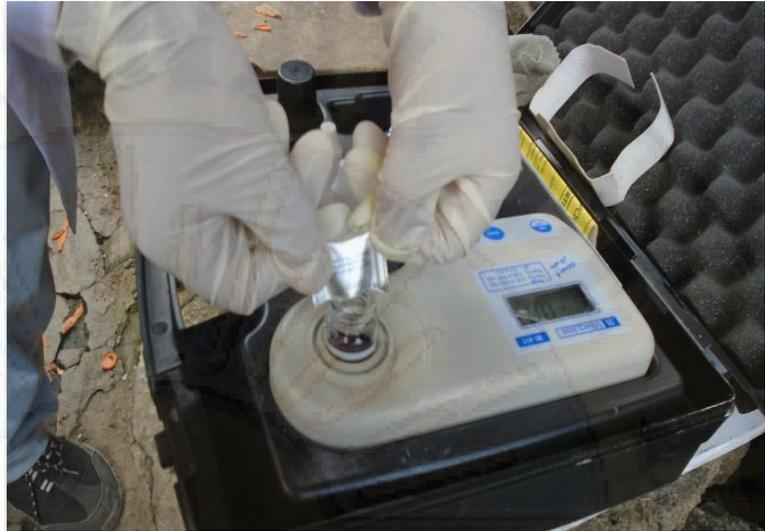
**Figura 31.** Se retira la tapa de la cubeta y se adiciona el sobre de reactivo DPD de 10ml.
