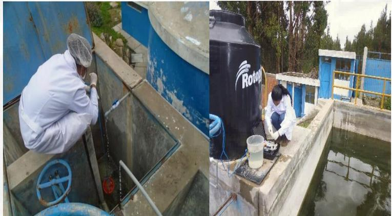
**Figura 35.** Recolección de muestra de agua de la unidad de mezcla rápida utilizando un balde y extracción de muestra de 10 mL en una cubeta.
