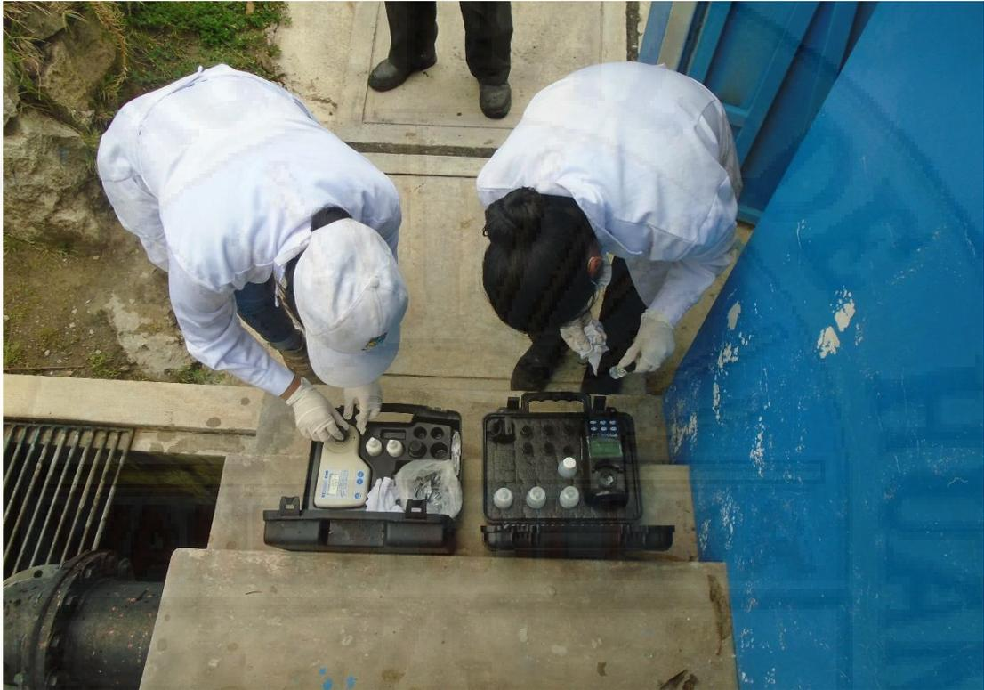
**Figura 74.** Medición de turbiedad y cloro residual libre con sus respectivos equipos, a la salida del reservorio de almacenamiento (en la tubería de rebose) como punto de control 2.
