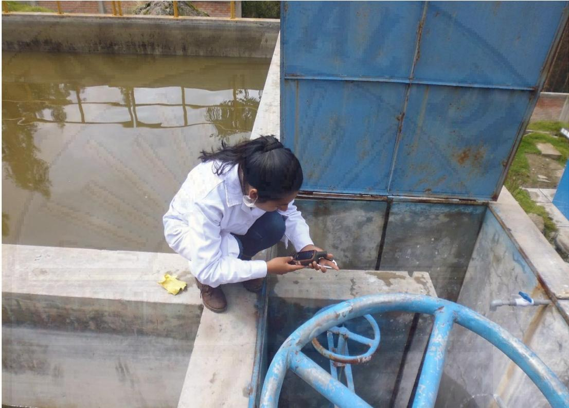
**Figura 72.** Georreferenciación de coordenadas UTM de la mezcla rápida, unidad de dosificación para la cloración del agua.
