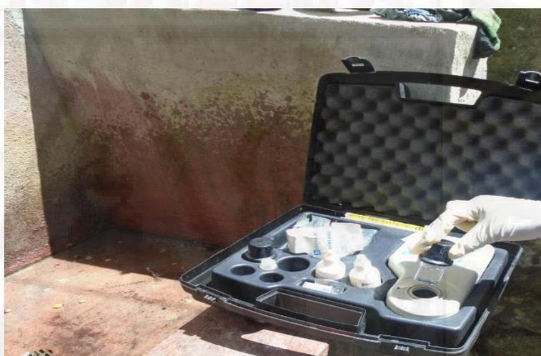
**Figura 29.** Se llena la cubeta de muestra con el agua a analizar hasta los 10 ml, luego se enciende el fotómetro.
