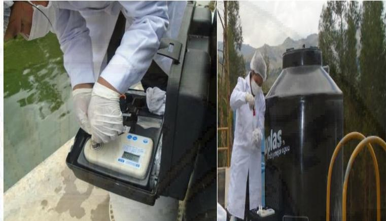
**Figura 36.** Adición sobre de reactivo de DPD para la medición de concentración de cloro con el equipo fotómetro.
