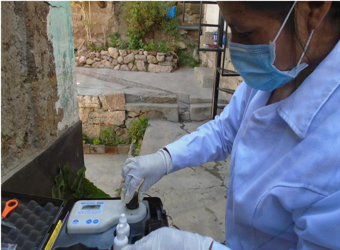
**Figura 77.** Medición con el equipo fotómetro por el método colorimétrico para la determinación de la concentración de cloro residual libre en la primera vivienda.
