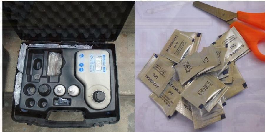
**Figura 10.** Fotómetro digital, cubetas de muestra y sobres de reactivo DPD.
