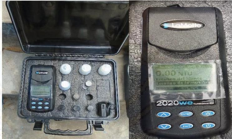
**Figura 11.** Turbidímetro digital, celdas de muestra y solución turbo estándar.
