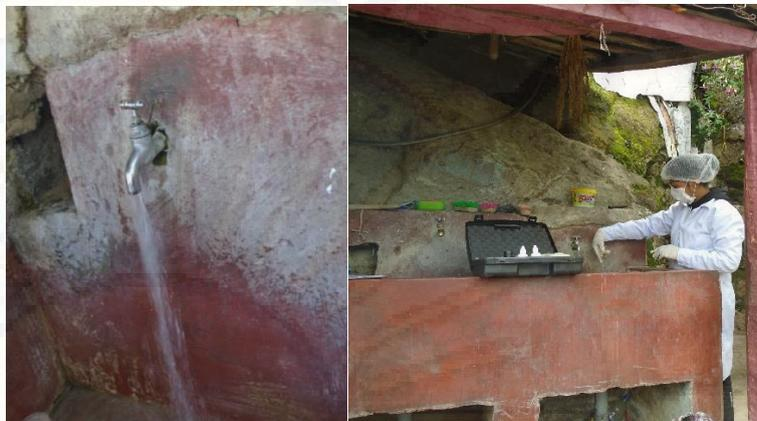
**Figura 28.** Se dejó fluir el agua por cinco minutos y se procedió a enjuagar la cubeta de muestra con el agua a analizar por 3 veces.
