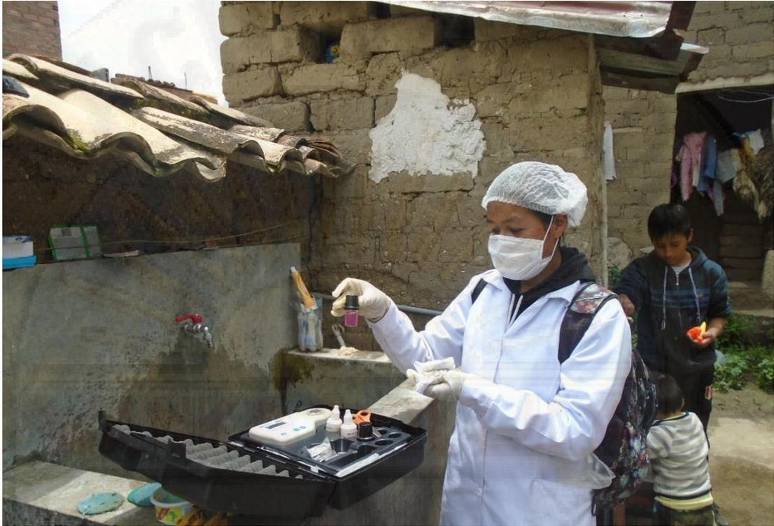
**Figura 78.** Muestra de agua potable que se torna de color rosado fuerte después de la medición con el equipo fotómetro por el método colorimétrico perteneciente al barrio Capillapata.
