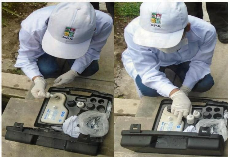
**Figura 27.** Adición solución DPD<sub>3</sub> para calibrar el fotómetro.
