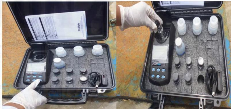
**Figura 20.** Se enciende el equipo, luego se llena la celda de vidrio 10 mL con solución estándar de 0 UNT luego se presiona la opción escaneo del blanco.
