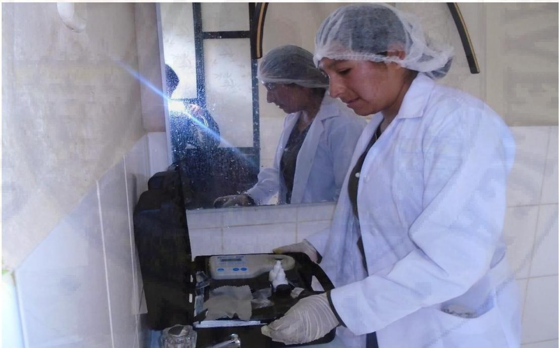
**Figura 81.** Medición de cloro residual libre con el equipo fotómetro por el método colorimétrico perteneciente al barrio Florida.
