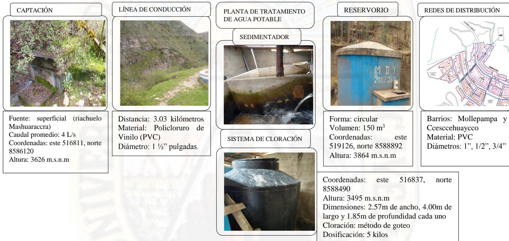
**Figura 16.** Esquema del sistema de agua potable N° 2, administrada por el Área Técnica Municipal.
