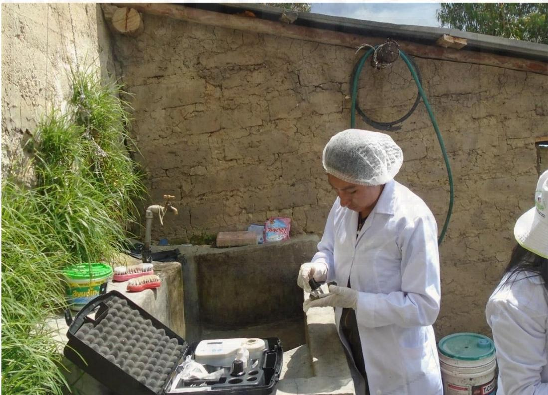
**Figura 83.** Muestra de agua potable que se torna de color rosado muy bajo después de la medición de cloro residual libre con el equipo fotómetro perteneciente al barrio Mollepampa.
