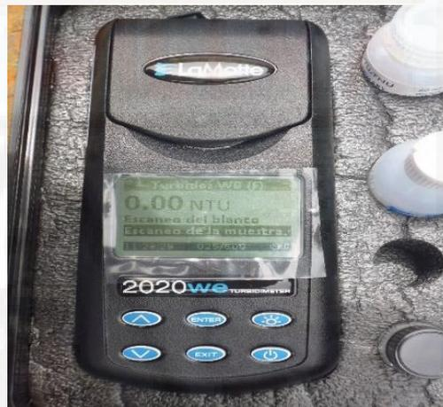
**Figura 21.** Esperar unos segundos se visualice 0.00 UNT, el equipo ya está calibrado y listo para medir.
