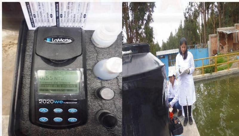
**Figura 24** En la pantalla se visualiza el resultado de turbidez de la muestra analizada, luego se anota en la ficha de registro.
