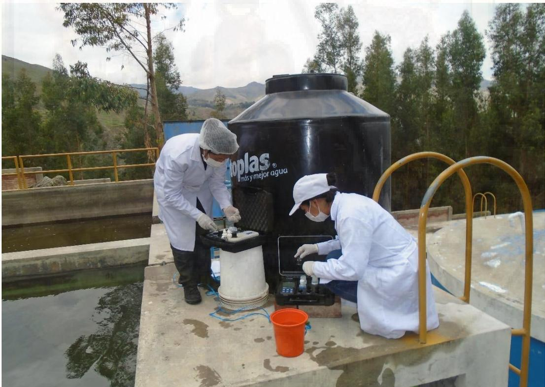
**Figura 73.** Medición de cloro residual libre y turbiedad a la salida de la planta de tratamiento de agua potable como puntos de control 1.
