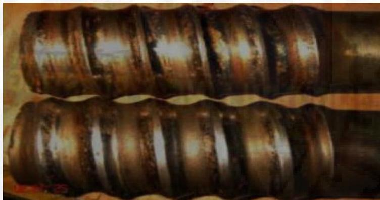
El uso inadecuado de este elemento reduce su vida útil, al trabajar con presiones y RPM deficiente se ve sometido a un esfuerzo distinto al que se enfrenta con el terreno, se generan pandeamientos excesivos y con ellos una rotura. Por ello la asesoría de un personal calificado y cuyas apreciaciones técnicas relacionados a la mejora son importantes.
