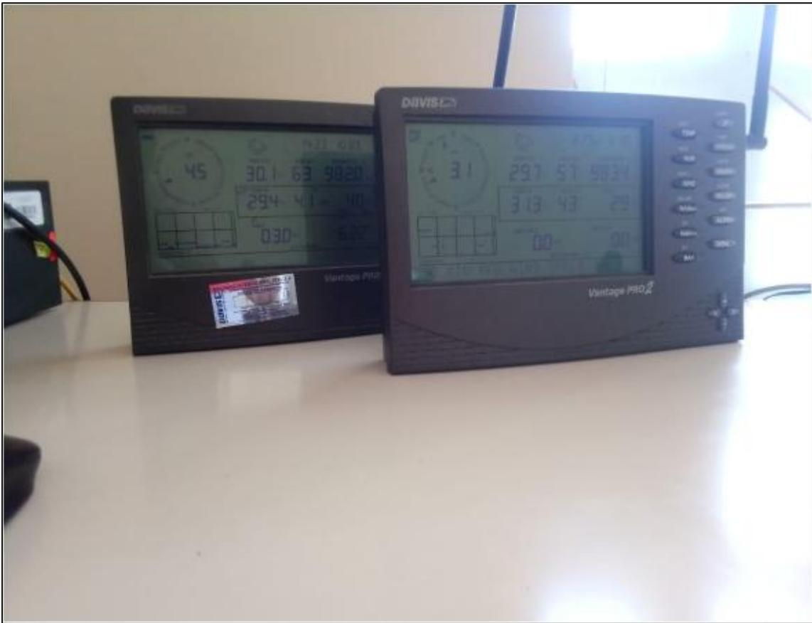
**Fotografías 5.** Equipos de Estación Meteorológica Automática DAVIS modelo Vantage Pro2 de Universidad Nacional de Huancavelica.
