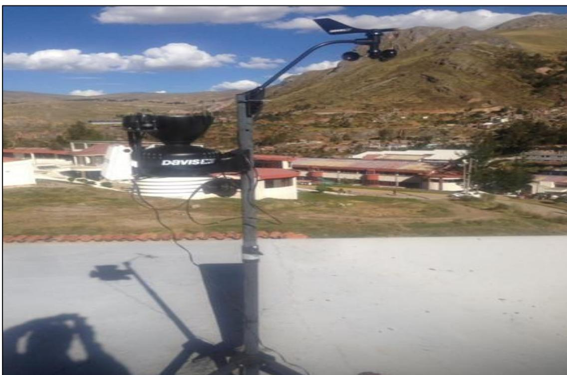
**Fotografías 2.** Estación Meteorológica Automática marca DAVIS modelo Vantage Pro2 de Ingeniería Ambiental y Sanitaria de la Universidad Nacional de Huancavelica.
