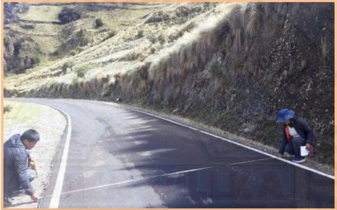
**Figura N° 48:** Hay podemos observar la métrica de calzada 3.80 m en la progresiva N°00+90, con berma de 0.80 m.
