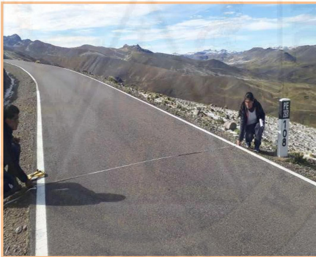
**Figura N° 75:** Hay podemos observar la métrica de calzada 3.90 m en la progresiva N°00+108.
