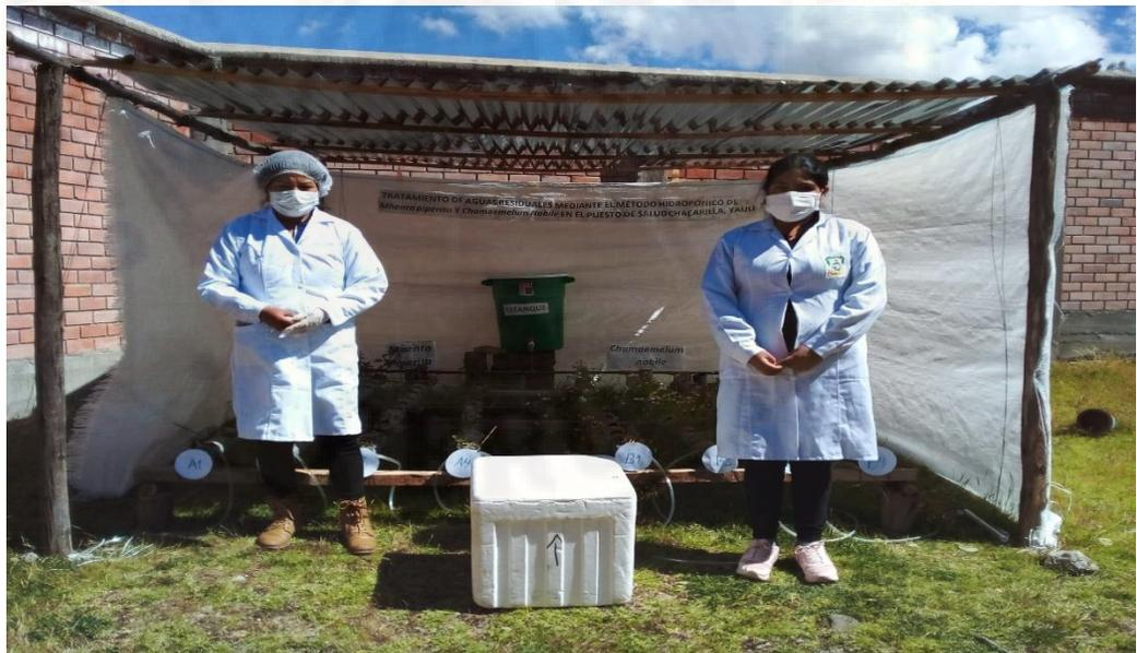
***Recolección de Muestra para Nitratos y Fosfatos.*** Las muestras fueron recolectadas en frascos de plástico de boca ancha con cierre hermético, limpios de un litro de capacidad. Las muestras recolectadas se conservaron en coolers a temperatura indicada disponiendo para ello con preservantes de temperatura Ice pack, enviando al laboratorio dentro de las 24 horas de haber realizado el muestreo.
