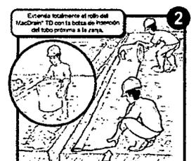
diámetro del tubo a ser utilizarlo en la zanja, siendo que en casos donde no serán utilizados tubos perforados, la excavación podrá ser realizada solo para el recibimiento del geocompuesto; es suficiente no más que 1 cm de espesura.
