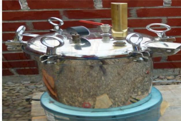
**Ilustración 17.** Solución nutritiva esterilizando en autoclave a 120 °C durante 20 minutos.
