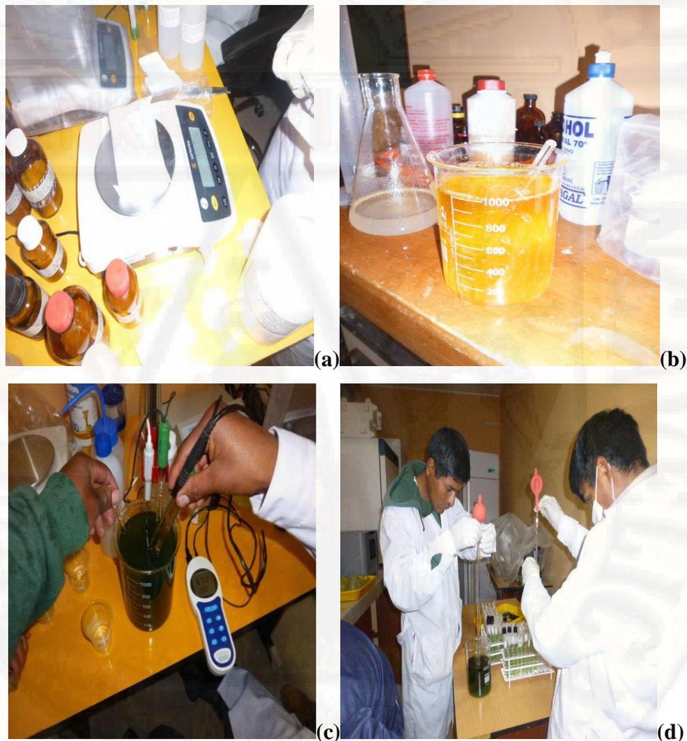
**Ilustración 2.** Proceso de preparación del medio del cultivo para *Azospirillum* spp. (a) Pesado de reactivos sólidos, (b) Cambio de pH del medio de cultivo líquido con KOH, (c) Medio de cultivo con pH 6.7, (d) Proceso de pipeteo de Medios de cultivo, solución salina y tapado de los tubos.
