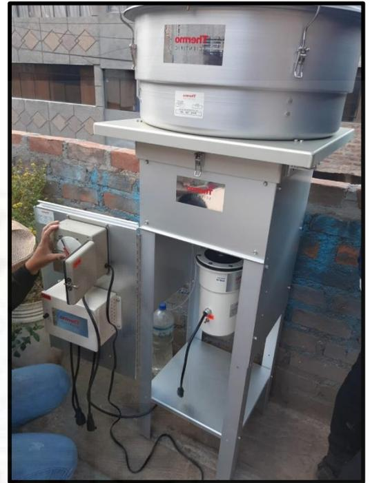
**Figura 8: Insertando el registro de tiempo y la instalación del disco para la medición del flujo**
