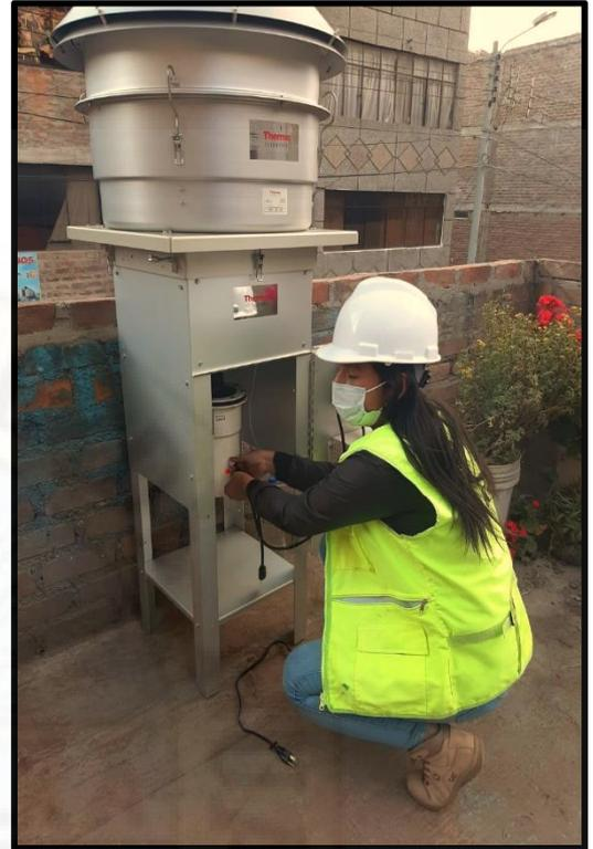
**Figura 6: instalación del motor Venturi y porta filtro**
