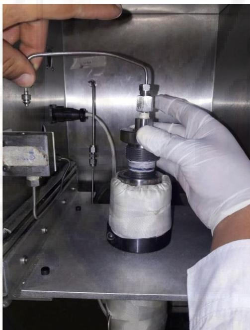
**Fotografía 8.** Preparación del equipo para extracción de aceite.
