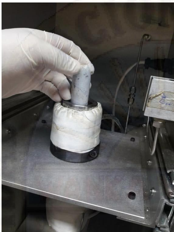
**Fotografía 7.** Puesta de la muestra en el extractor de fluido supercrítico.
