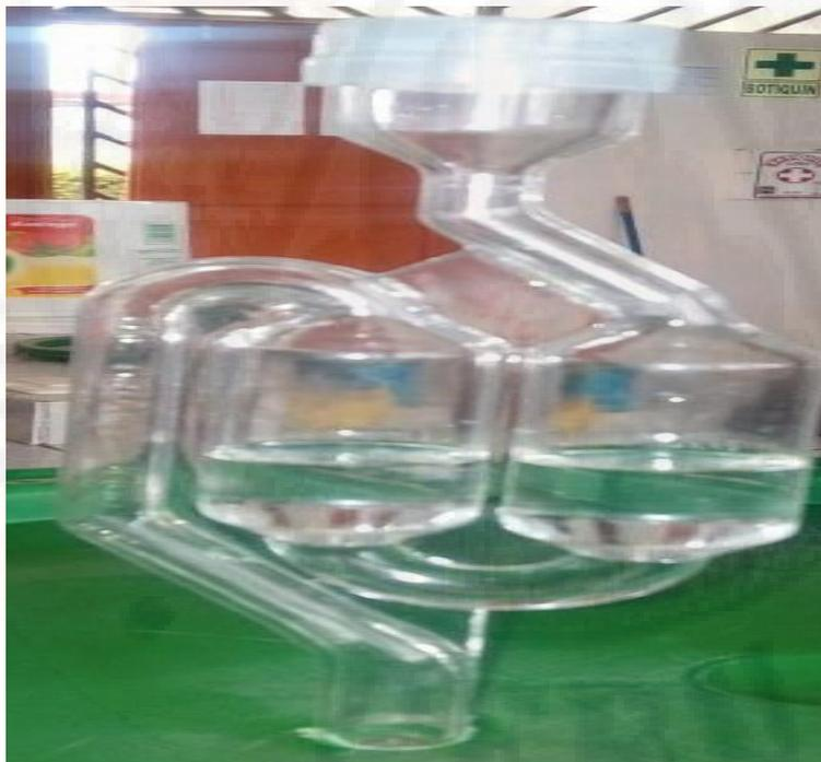
*Fotografía 8.* Airlock adquirido para la fermentación del extracto
