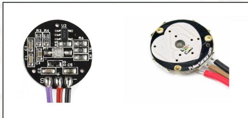
Figura N° 2.- Sensor de pulso cardíaco.
