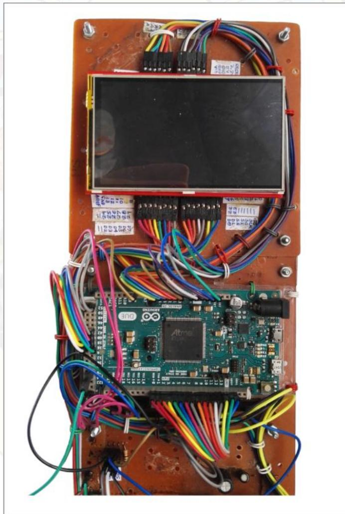
Figura N° 10.- Cableado entre TFT-LCD y el “Arduino Due”.
