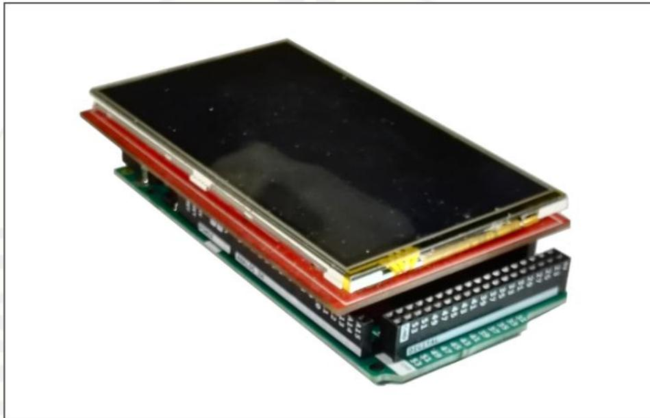
Figura N° 8.- Shield del TFT-LCD sobre el "Arduino Due".
