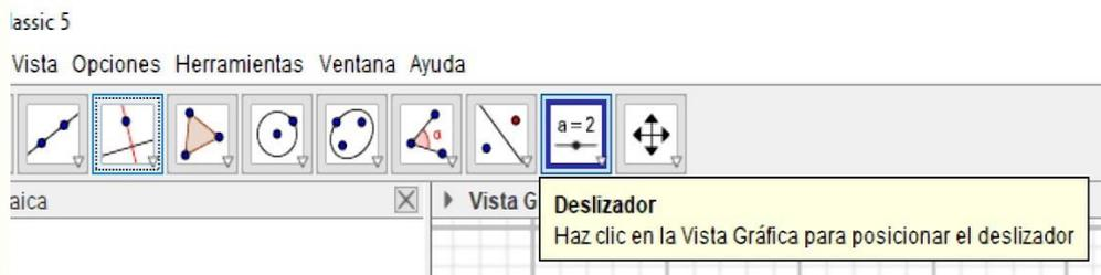
Figura (6) Herramienta “deslizador” sirve para variar un valor.
