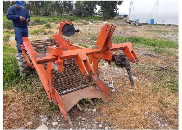
Cosechadora con cardan para TDF (Sr. Aliagatiene un ancho de corte 1.10 m. (mucho daño
