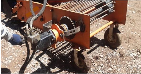
Vista del motor hidraulico de rotación.
