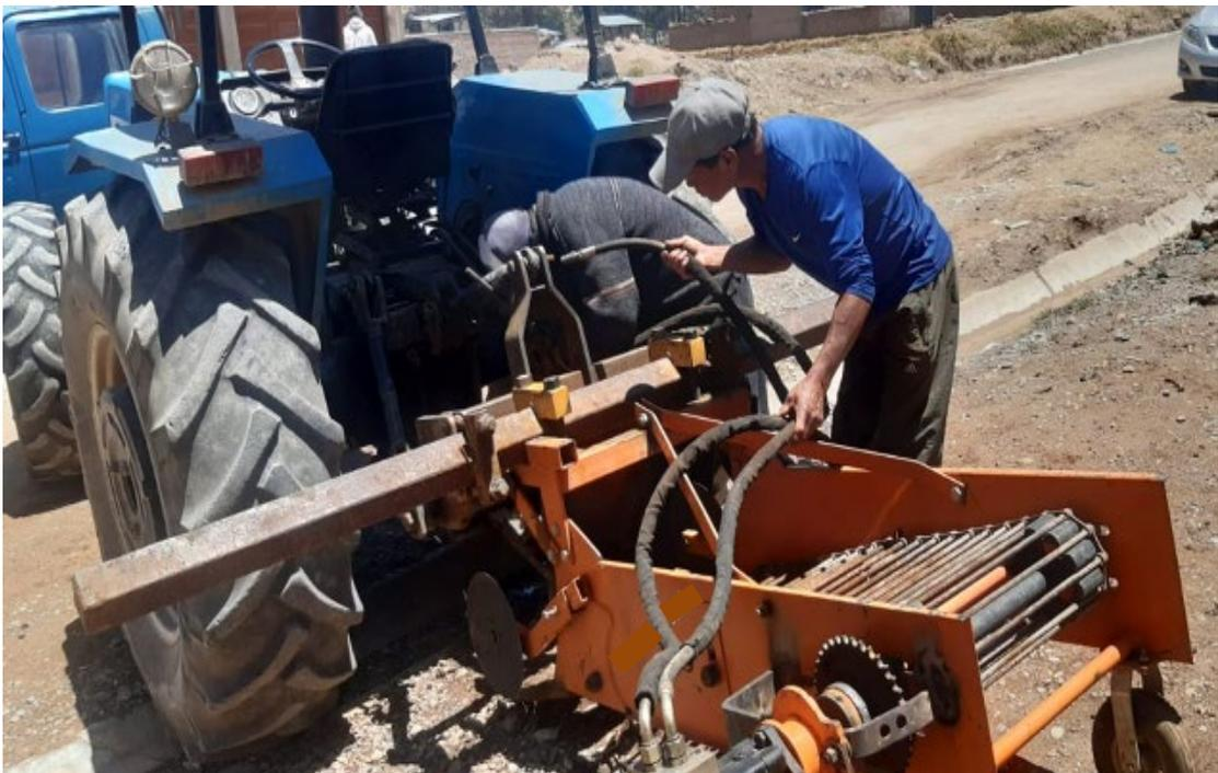
Vista del prototipo de cosechadora de zanahoria acoplado al tractor agrícola en la barra sólida
