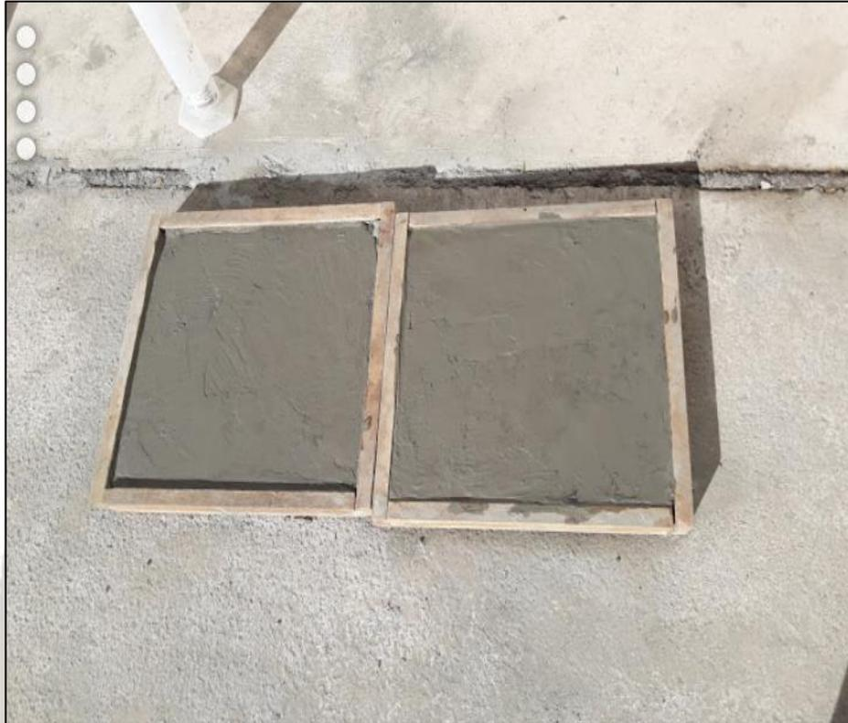
*FIGURA 45. Estado final luego de la aplicación del impermeabilizante.*
