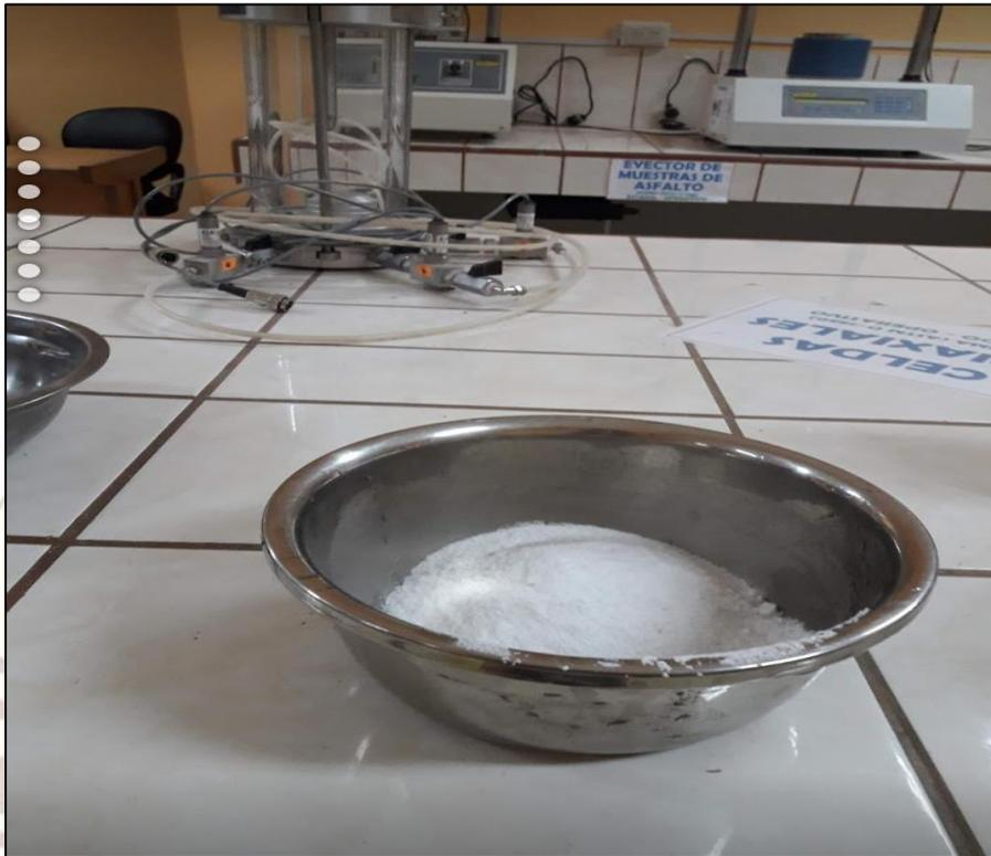
*FIGURA 26. Piedra alumbre molida para el impermeabilizante a base de cal.*
