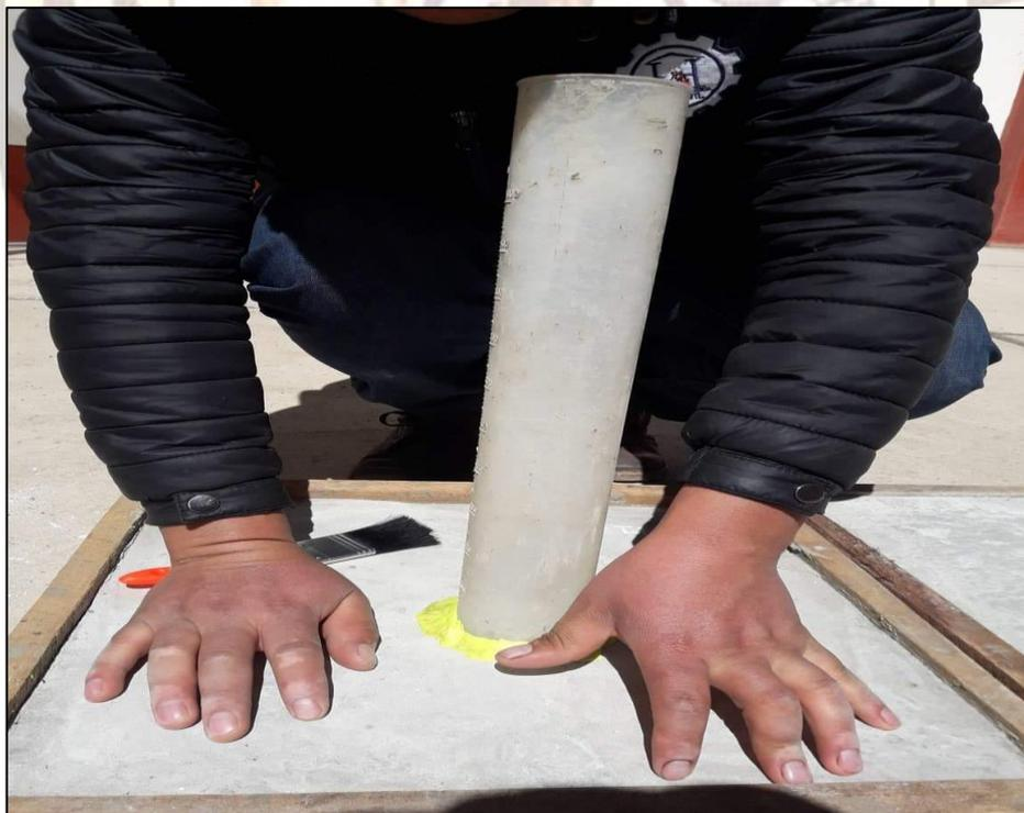
*FIGURA 36. Inicio del ensayo de permeabilidad Muestra 01.*
