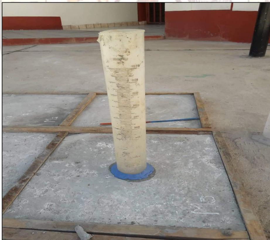
*FIGURA 40. Proceso del ensayo de permeabilidad Muestra 05.*
