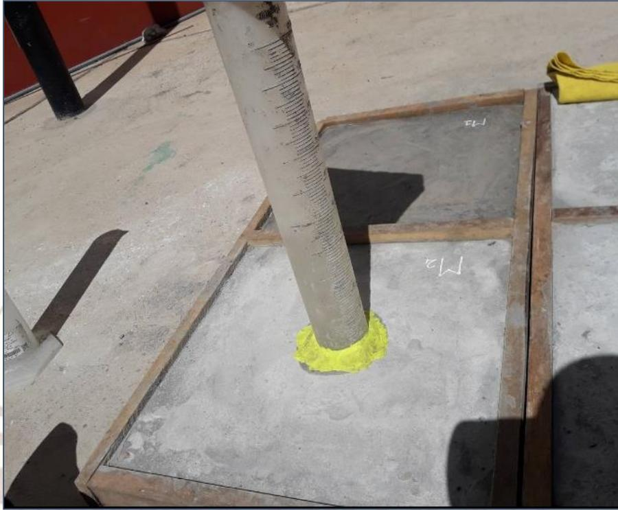
*FIGURA 10. Colocación y fijación del tubo para la iniciación del ensayo en la M2 (Muestra N° 02).*
