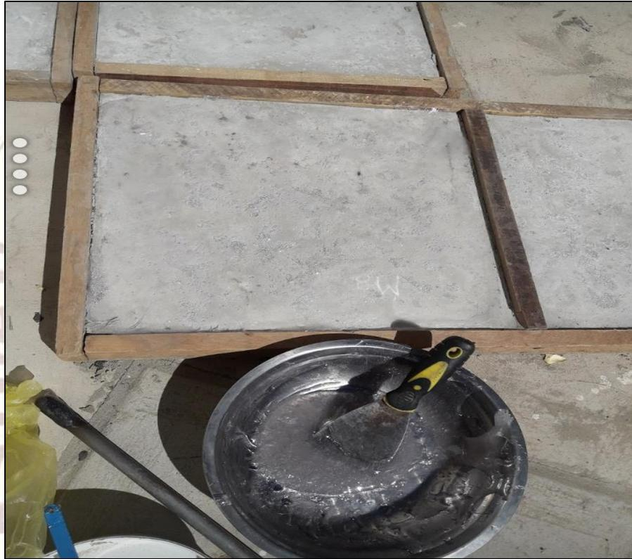
*FIGURA 18. Aplicación del impermeabilizante en la muestra de probeta.*
