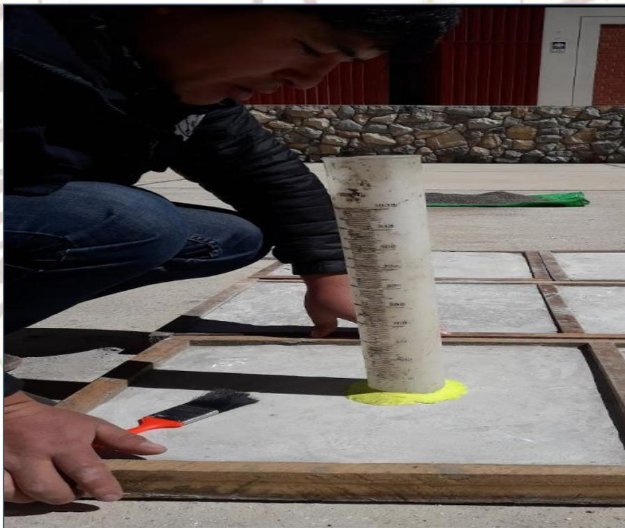
*FIGURA 13. Ensayo de permeabilidad en la Muestra N° 05.*
