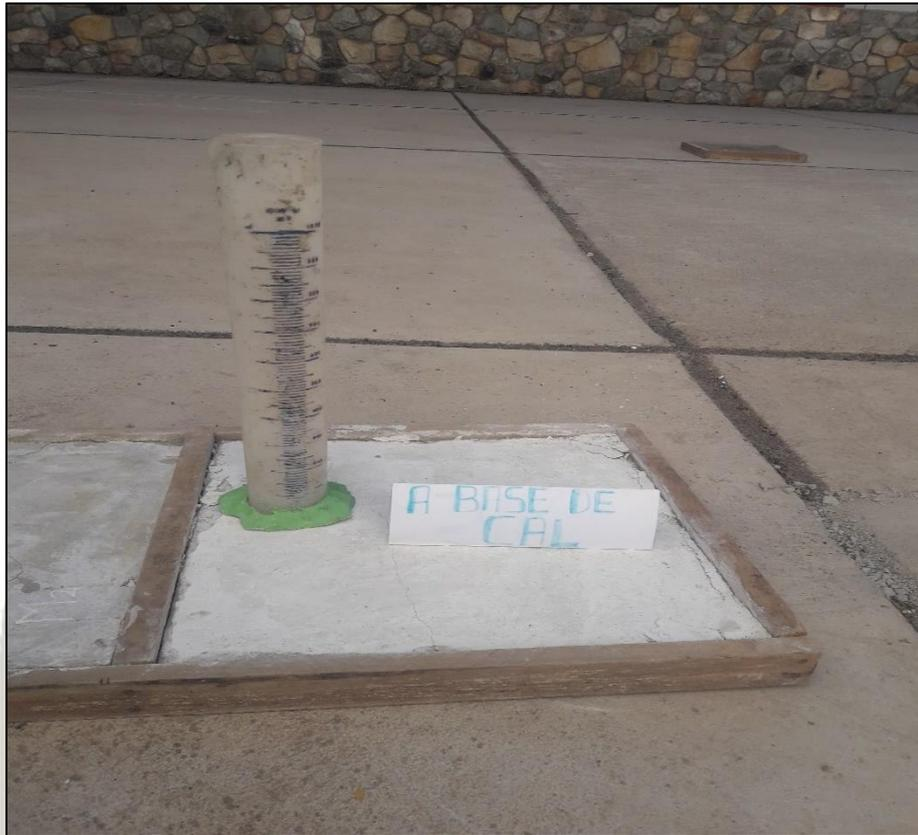
*FIGURA 57. Ensayo de permeabilidad después de la aplicación del impermeabilizante a base de cal.*
