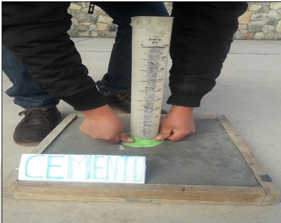
*FIGURA 55. Ensayo de permeabilidad después de la aplicación del impermeabilizante de lechada de cemento.*
