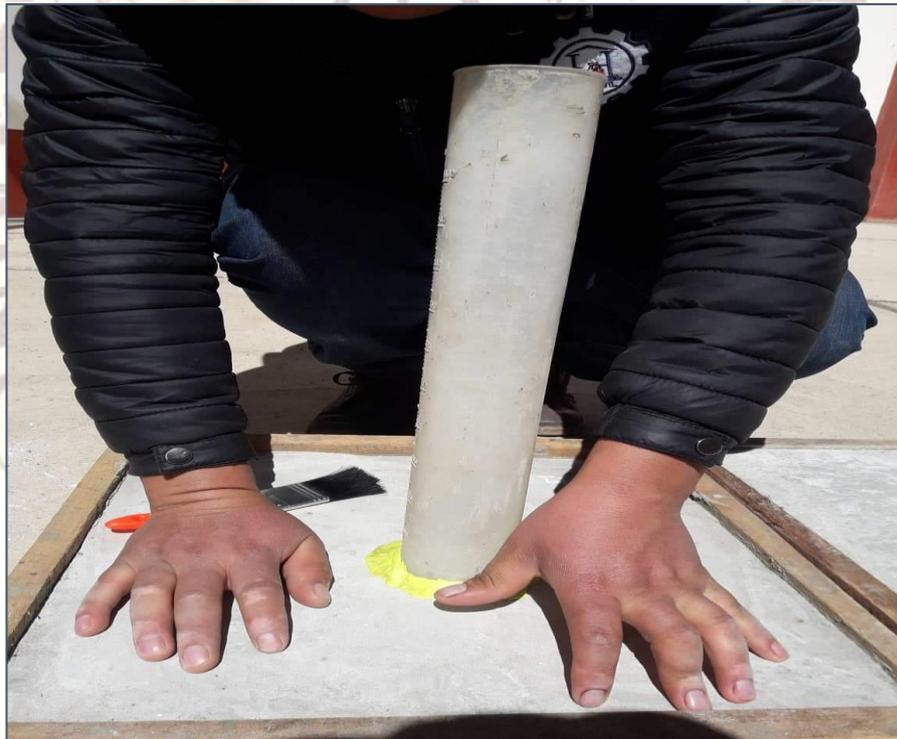
*FIGURA 9. Colocación y fijación del tubo para la iniciación del ensayo en la M1 (Muestra N° 01).*
