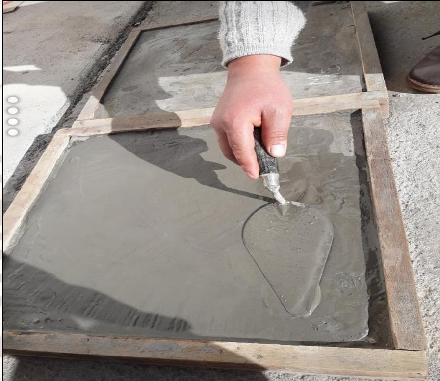
*FIGURA 20. Aplicación del impermeabilizante en la probeta.*
