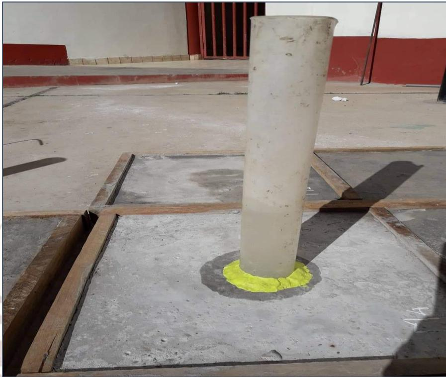
*FIGURA 12. Ensayo de permeabilidad en la Muestra N° 04.*
