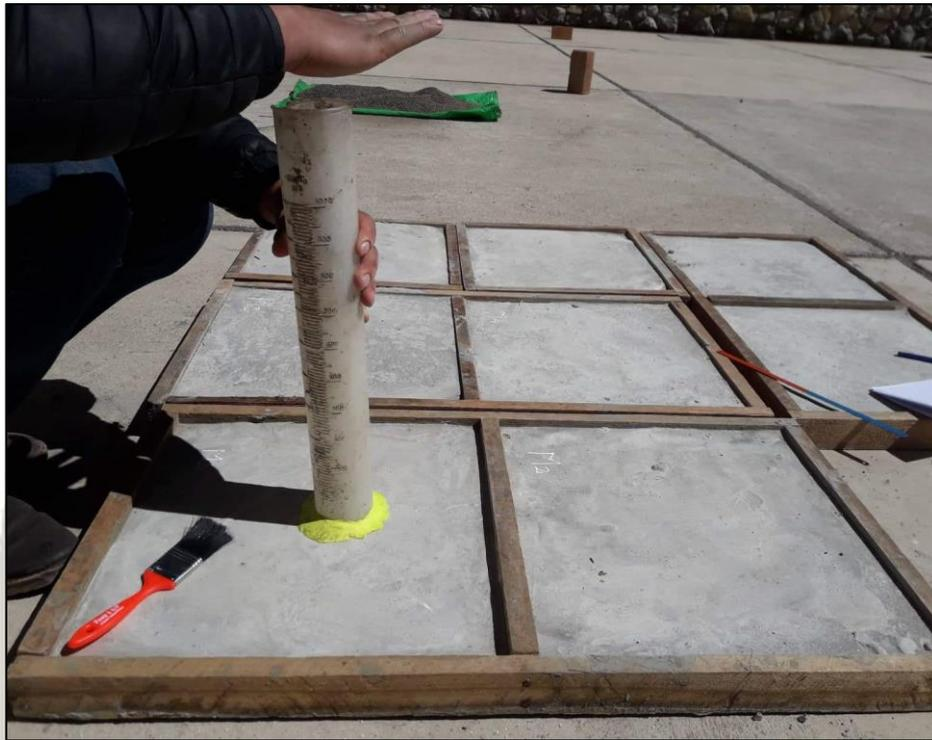
*FIGURA 35. Colocación para el ensayo de permeabilidad Muestra 02.*
