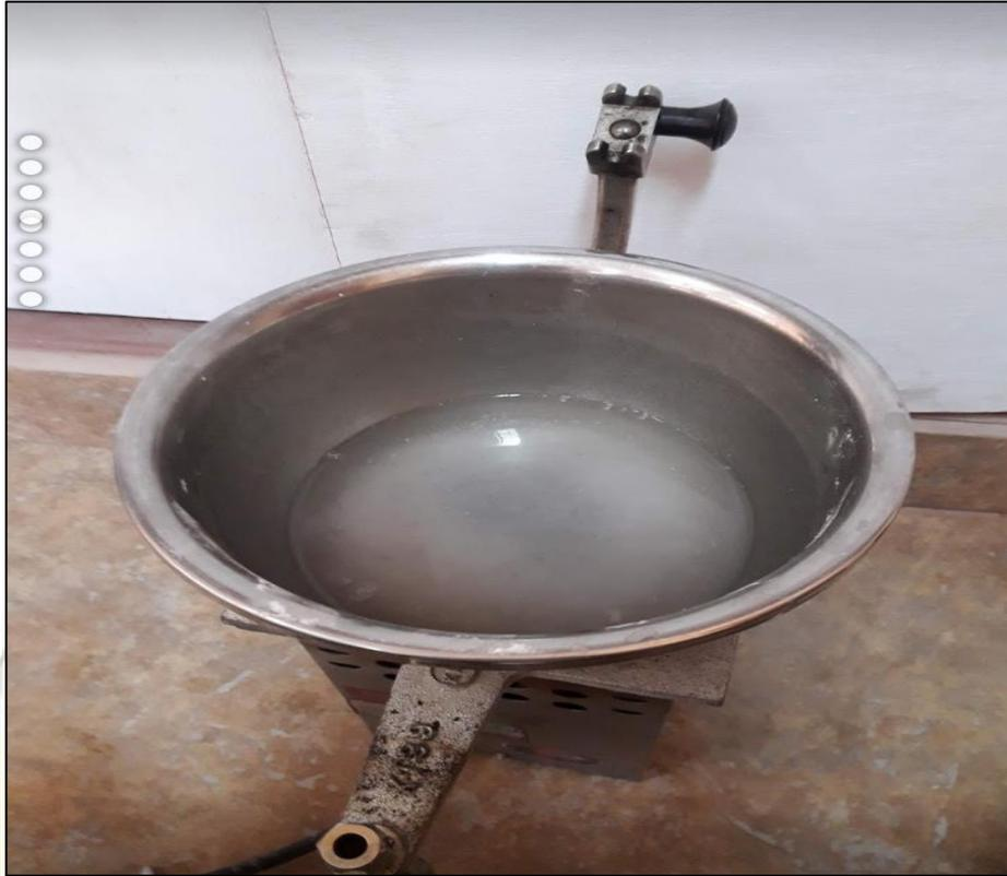
*FIGURA 51. Colocación de la piedra alumbre molida con agua en la estufa.*
