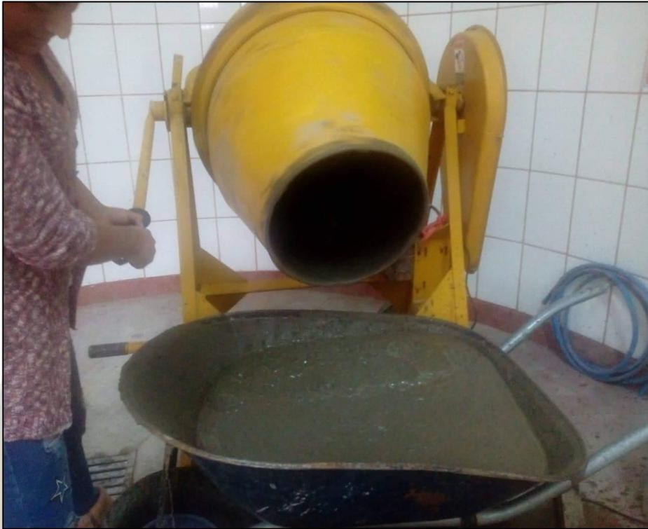
*FIGURA 33. Proceso de mezclado de las probetas.*
