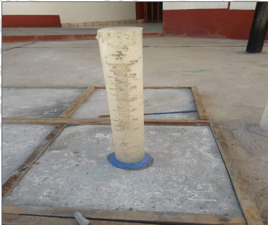
*FIGURA 11. Ensayo de permeabilidad en la Muestra N° 03.*
