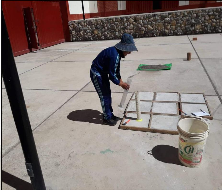
*FIGURA 37. Aplicación de agua para el ensayo de permeabilidad.*
