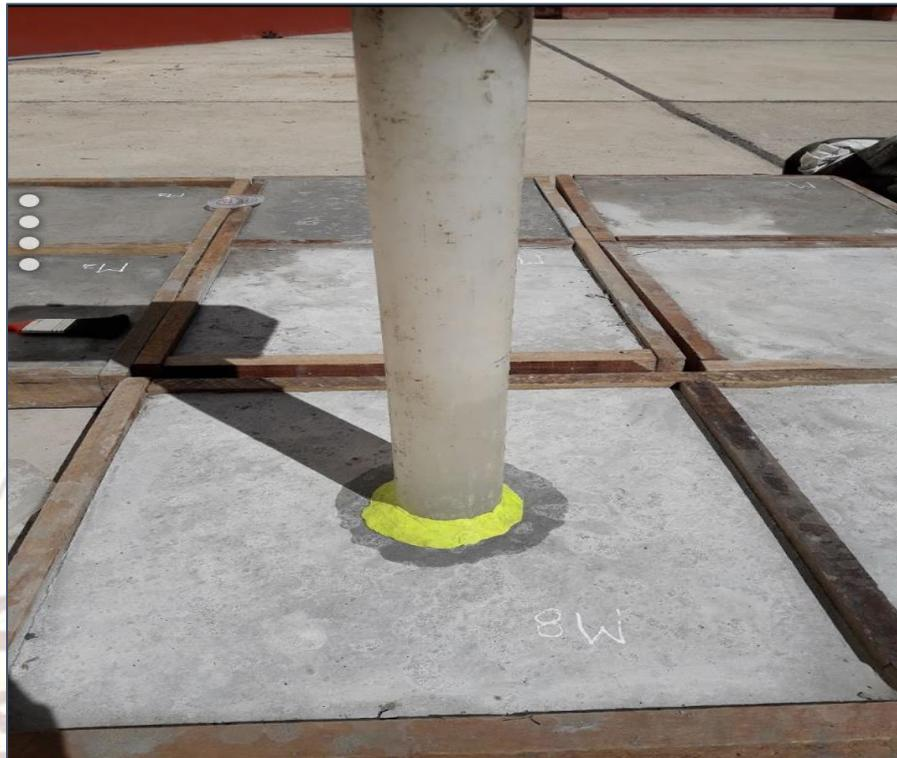
**FIGURA 16.** *Ensayo de permeabilidad en la Muestra N° 08.*
