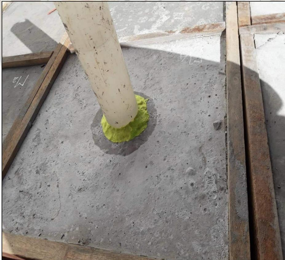
*FIGURA 38. Proceso del ensayo de permeabilidad Muestra 03.*
