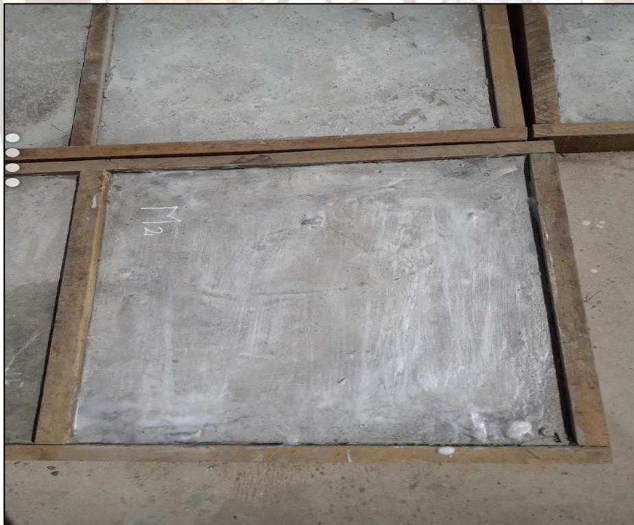
*FIGURA 52. Aplicación del impermeabilizante jabonado de alumbre en la Muestra 02.*
