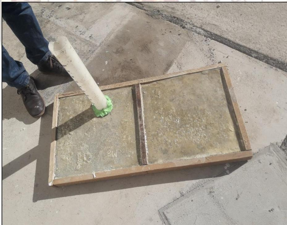
*FIGURA 58. Ensayo de permeabilidad después de la aplicación del impermeabilizante unicel.*
