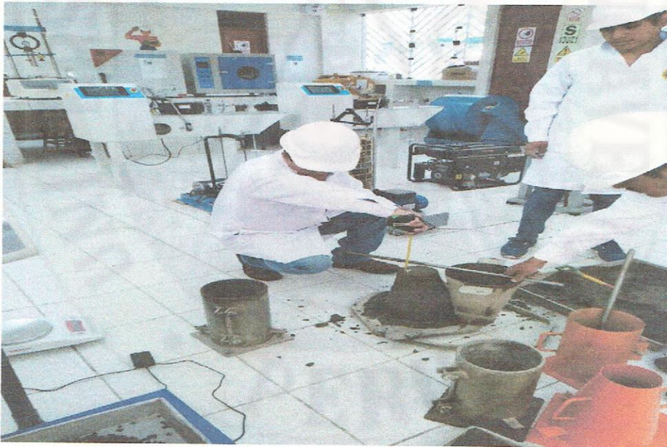
*Foto14: El tesista en el laboratorio de mecánica de suelos y concreto EPIC-Lircay midiendo el slump*
