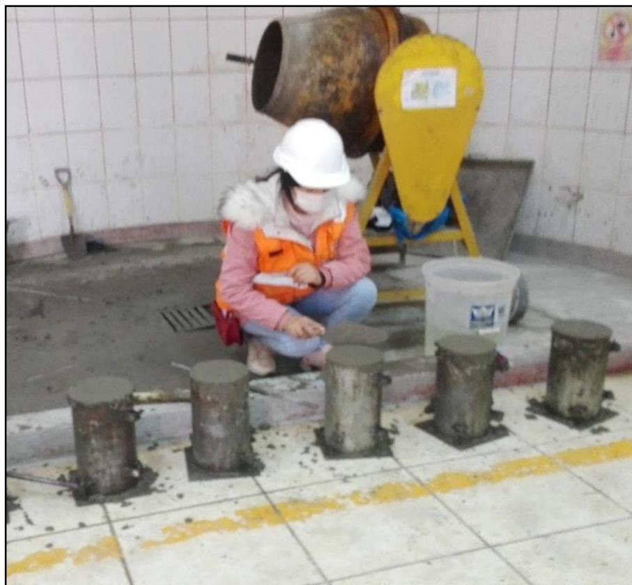
Figura 70. Apisonamiento en el molde en tres capas, hasta llenarlo por completo
