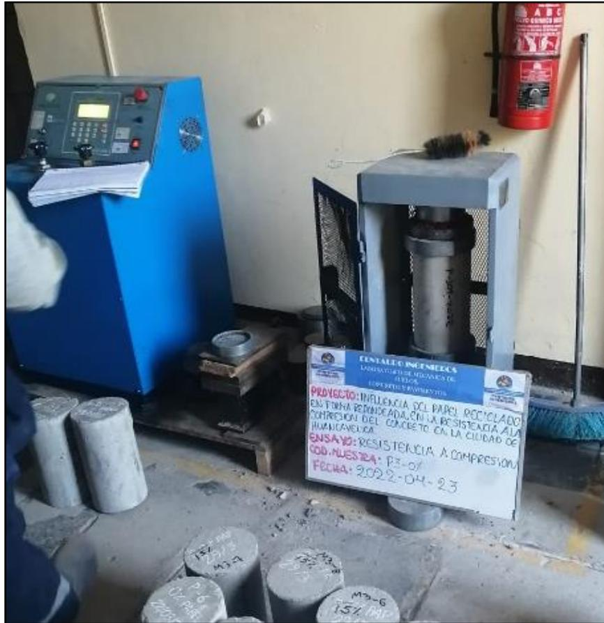
Figura 80. Prensa hidráulica para ensayo de resistencia a la compresión
