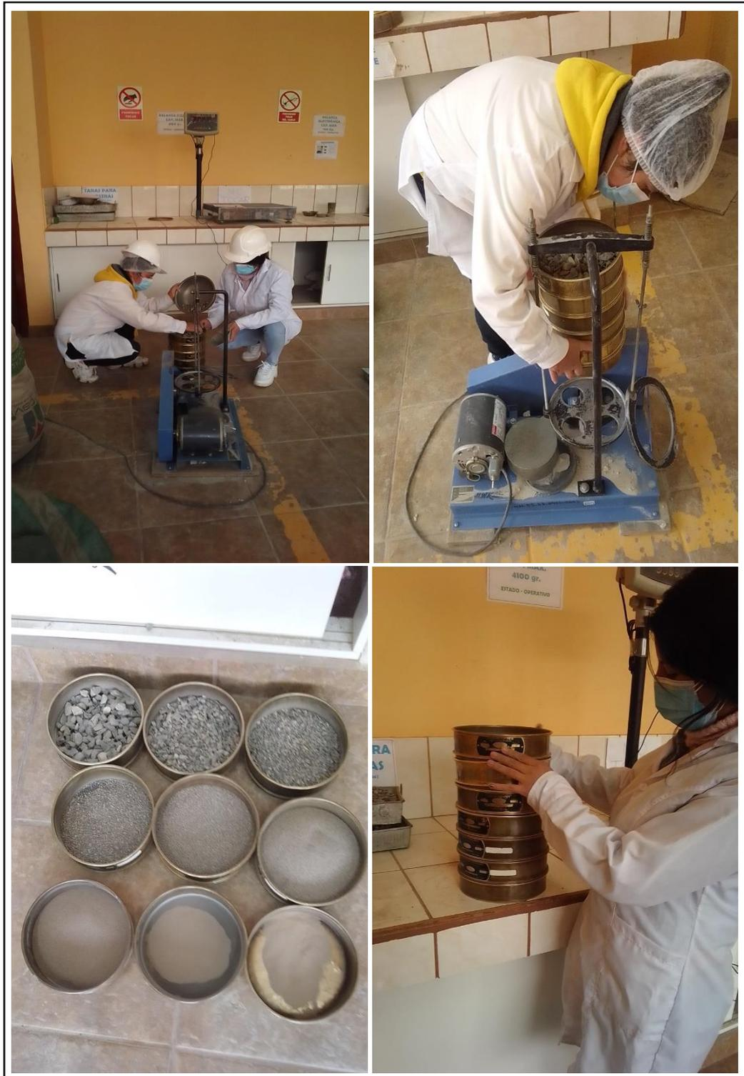
Figura 102. Proceso del ensayo de granulometría de los agregados.
