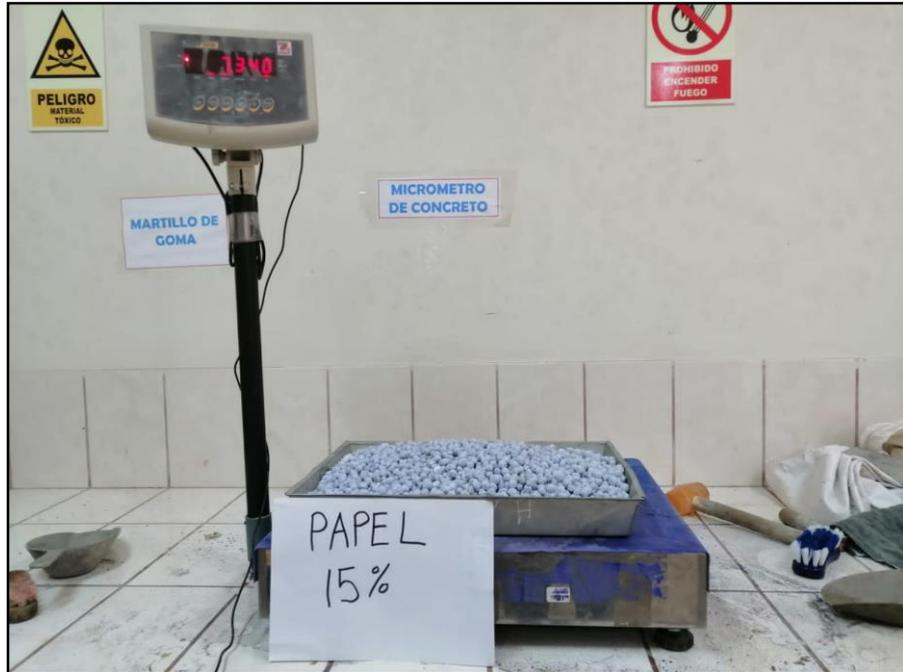
Figura 60. Peso del papel reciclado en forma redondeada para muestra M3: 15% de papel reciclado
