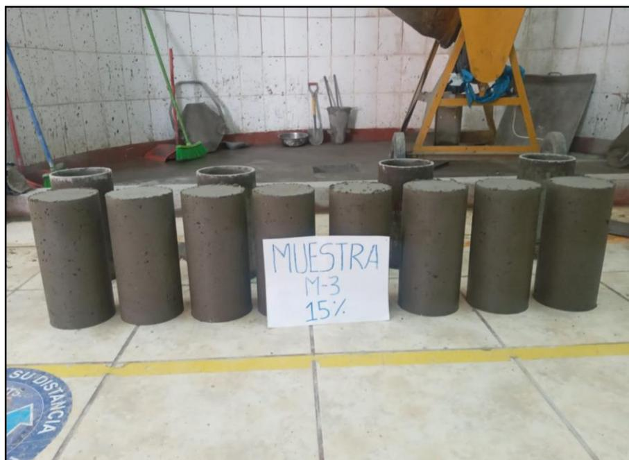
Figura 74. Desmoldado de las probetas de concreto para su curado
