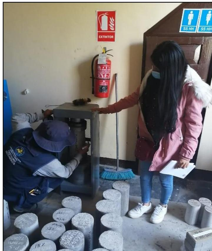
Figura 86. Colocación de la probeta para su rotura
