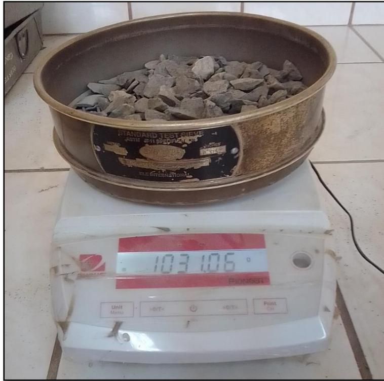
Figura 16. Peso retenido de los agregados en cada malla
