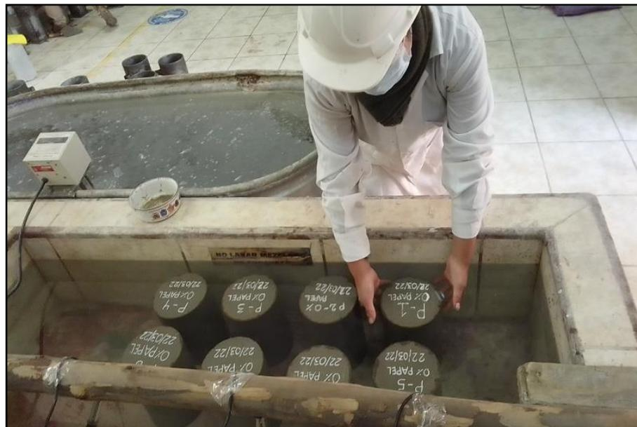
Figura 76. Probetas llevadas al pozo de curado
