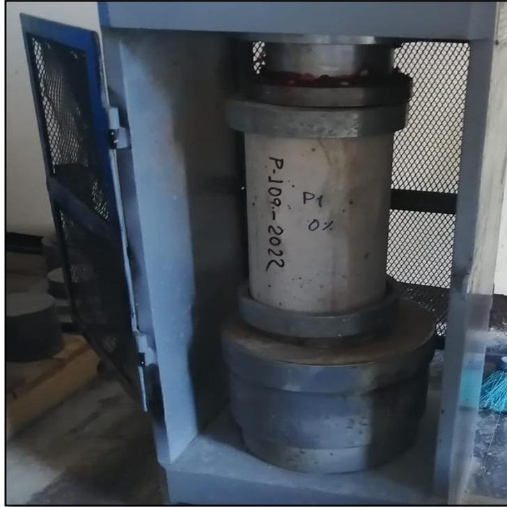
Figura 81. Almohadillas y anillos de la prensa hidráulica, para retención.
