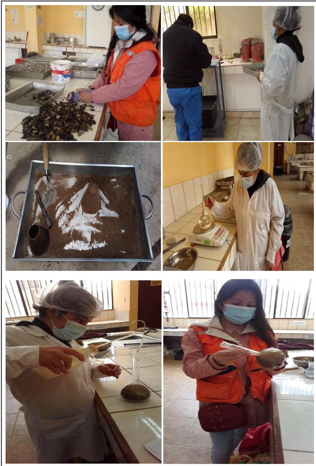
Figura 103. Proceso del ensayo de peso específico y absorción de los agregados.
