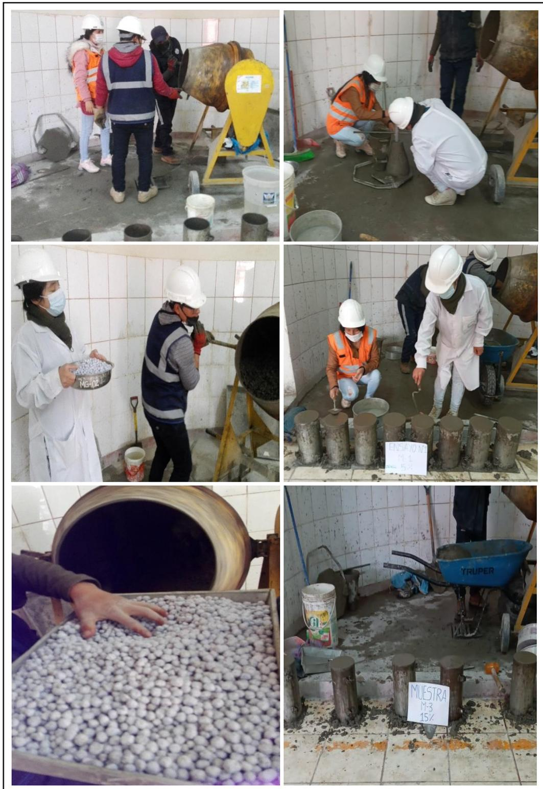
Figura 104. Proceso de mezclado del concreto patrón y muestras M1(5% papel), M2(10% papel) y M3(15% papel).
