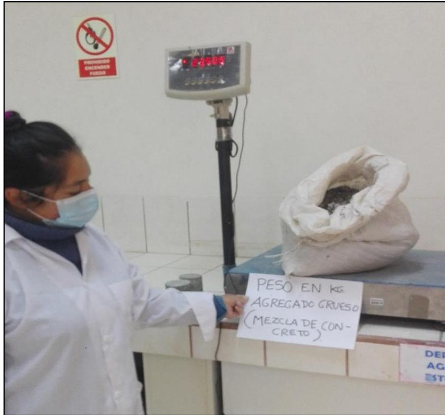
Figura 56. Peso del agregado grueso (piedra chancada de 3/4") – mezcla patrón
