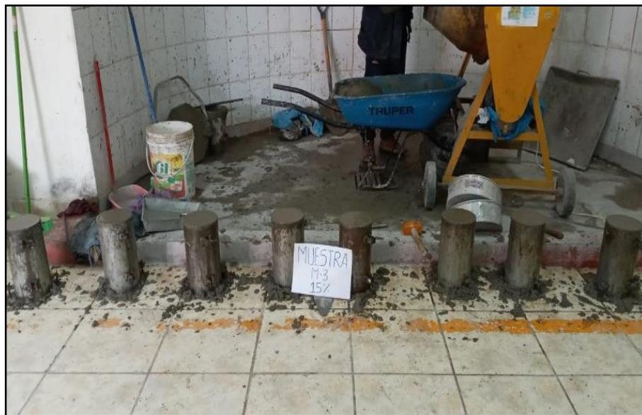
Figura 72. Mezcla introducida dentro de los 8 moldes, M3: 15%
