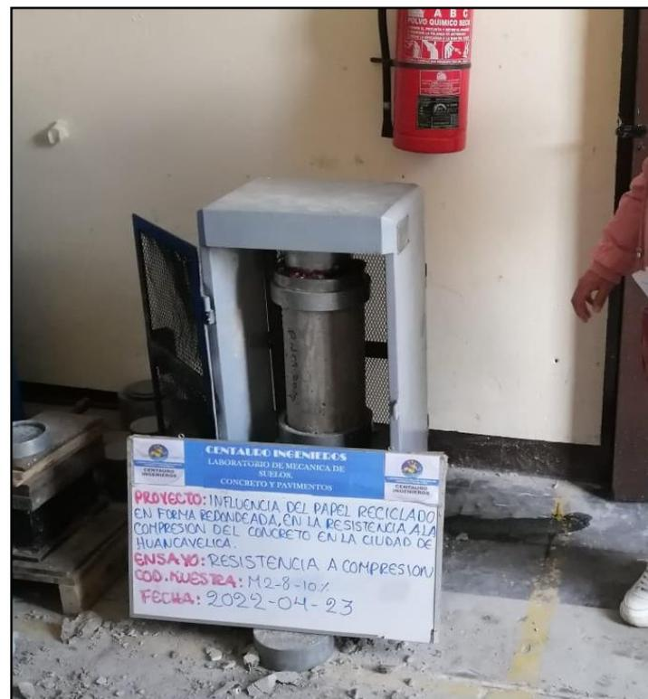
Figura 88. Ensayo de resistencia a la compresión de la muestra M2: 10% de papel
