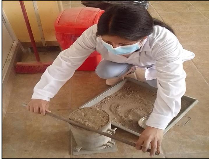
Figura 22. Enrasando la muestra de la arena gruesa
