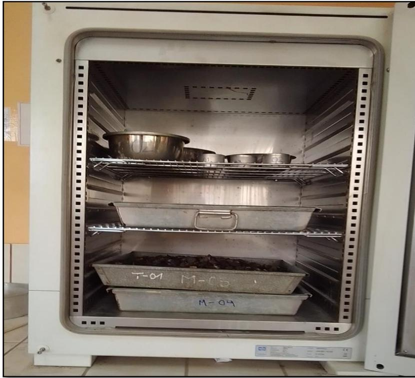
Figura 10. Muestras de los agregados llevadas al horno
