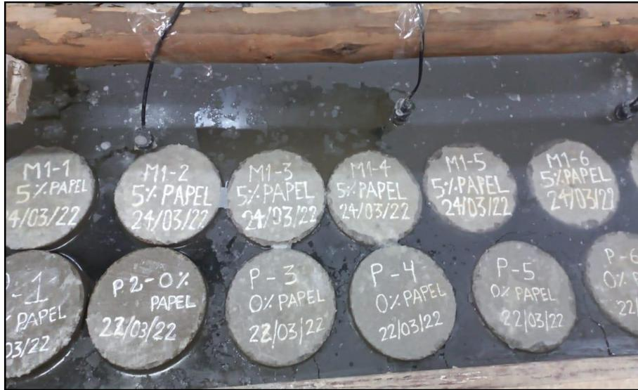
Figura 77. Curado de las probetas cilíndricas en el pozo de curado
