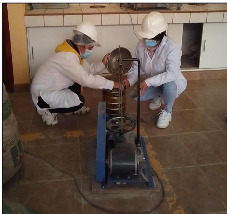
Figura 13. Mallas ordenadas para el tamizado de la arena gruesa y piedra chancada
