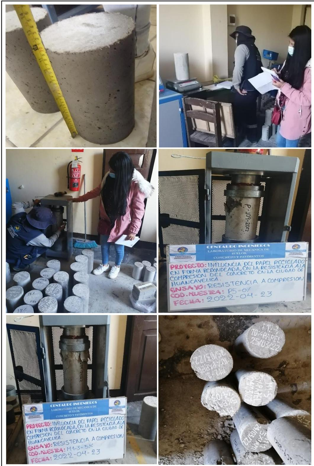
Figura 106. Ensayo de rotura de probetas cilíndricas de concreto.
