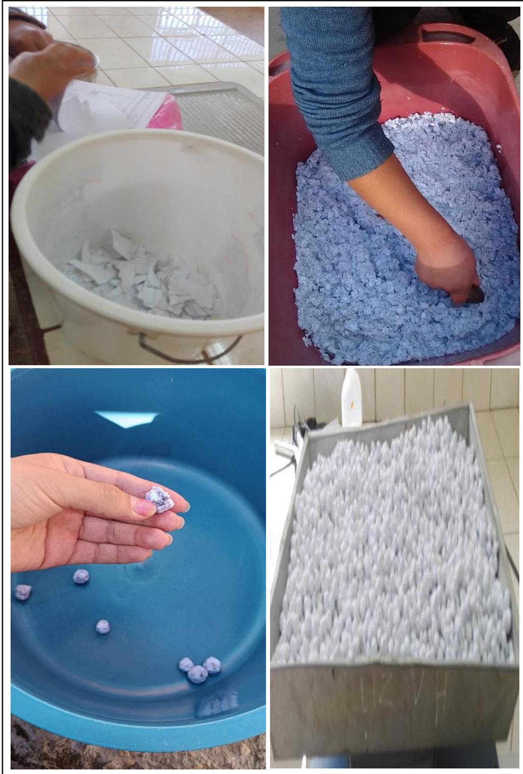
Figura 99. Proceso de obtención del papel reciclado en forma redondeada.
