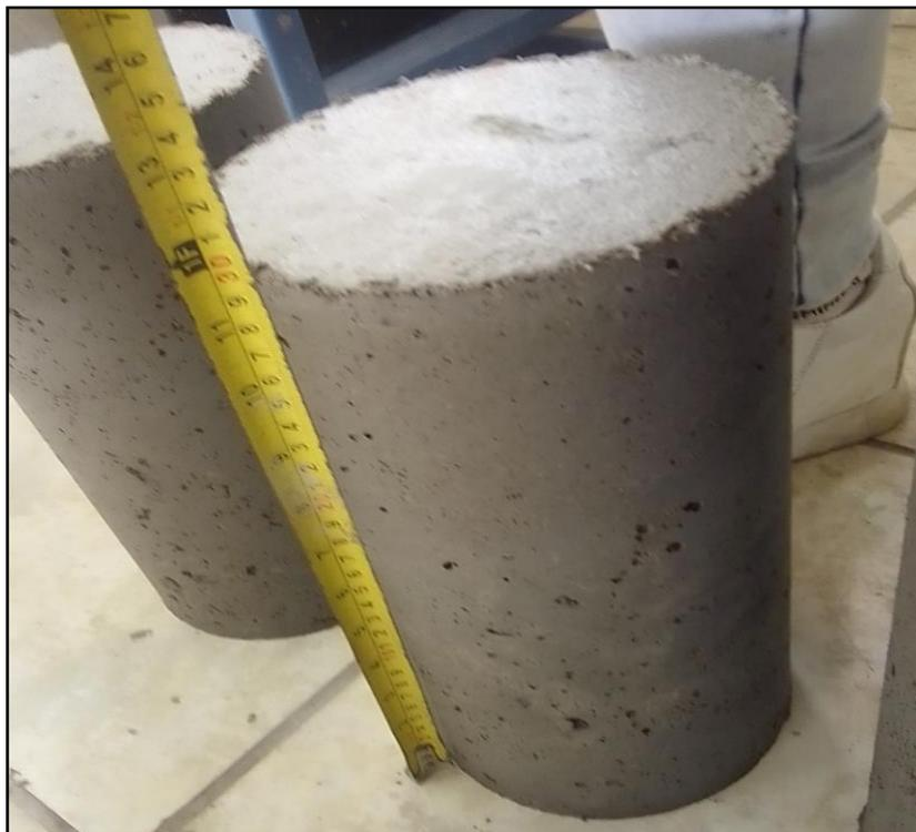
Figura 84. Medición de alturas de las probetas antes de la rotura
