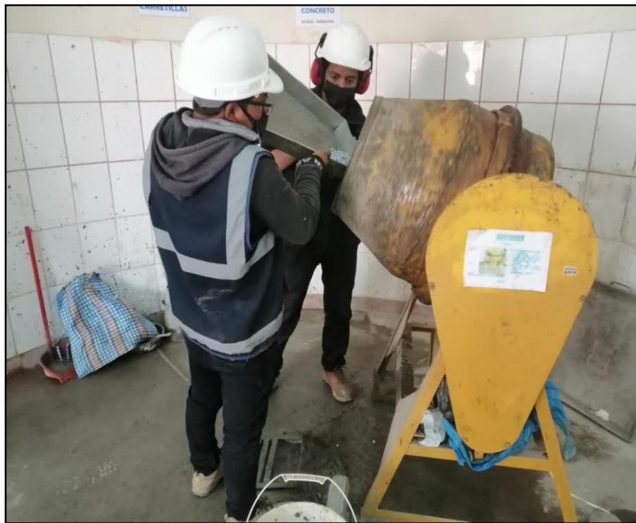
Figura 65. Mezcla del cemento, piedra partida, arena gruesa y papel en forma redondeada.
