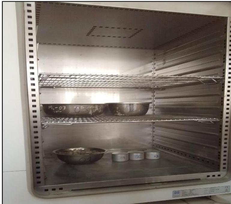
Figura 7. Muestras de la arena gruesa y de la piedra chancada dentro el horno
