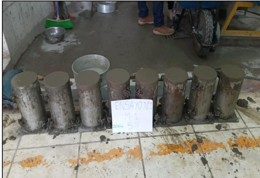
Figura 71. Mezcla introducida dentro de los 8 moldes, M1: 5%
