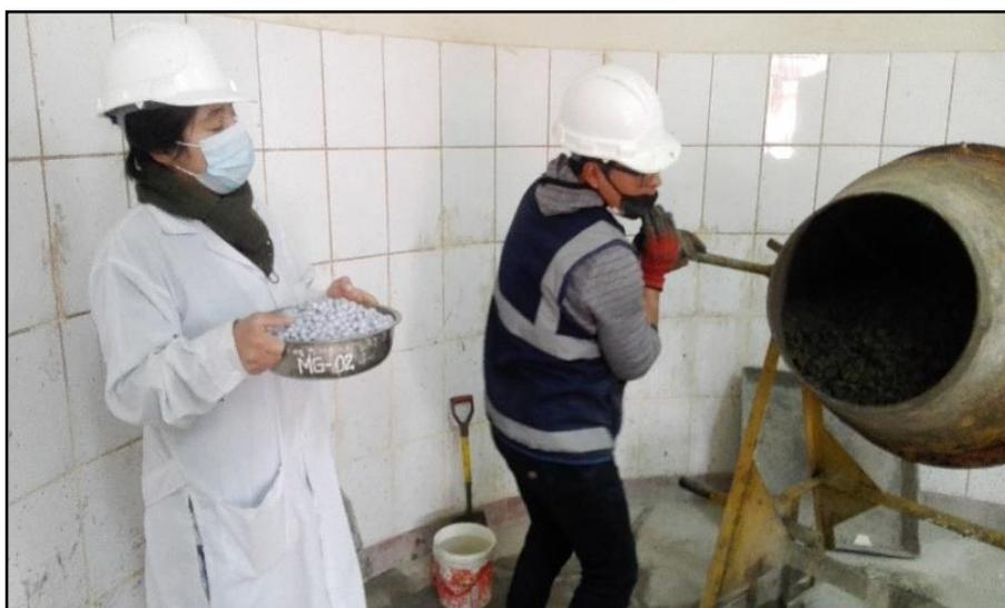
Figura 63. Incorporación del 5% de papel en forma redondeada a la mezcladora
