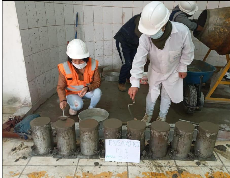
Figura 73. Rotulado de probetas de la muestra M1: 5% de papel reciclado
