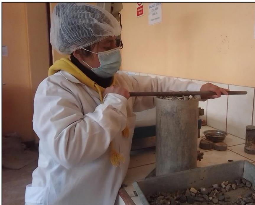
Figura 26. Enrasando la muestra del agregado grueso
