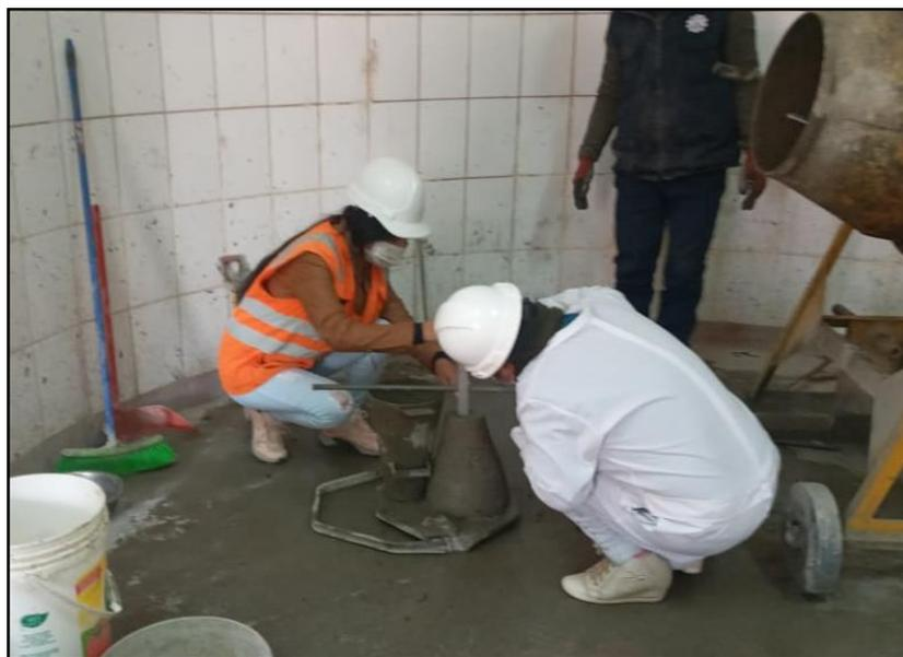
Figura 67. Ensayo del cono de Abrams
