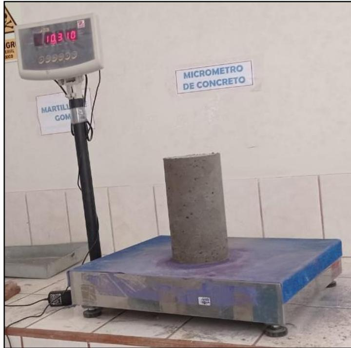
Figura 85. Pesado de probetas antes de la rotura
