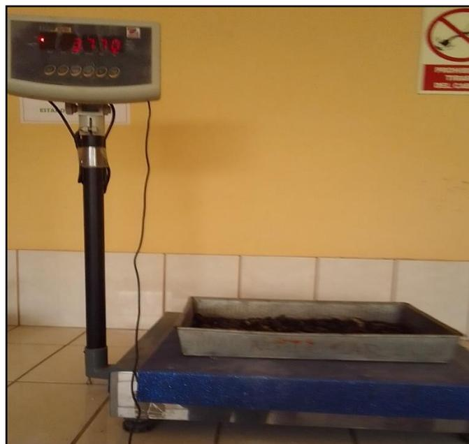
Figura 46. Peso de la muestra de la piedra chancada seco
