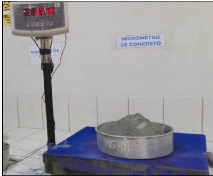
Figura 54. Peso del cemento portland tipo I
