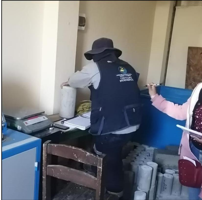
Figura 83. Medición del diámetro de las probetas antes de la rotura.
