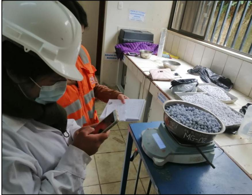
Figura 58. Peso del papel reciclado en forma redondeada para muestra M1: 5% de papel reciclado
