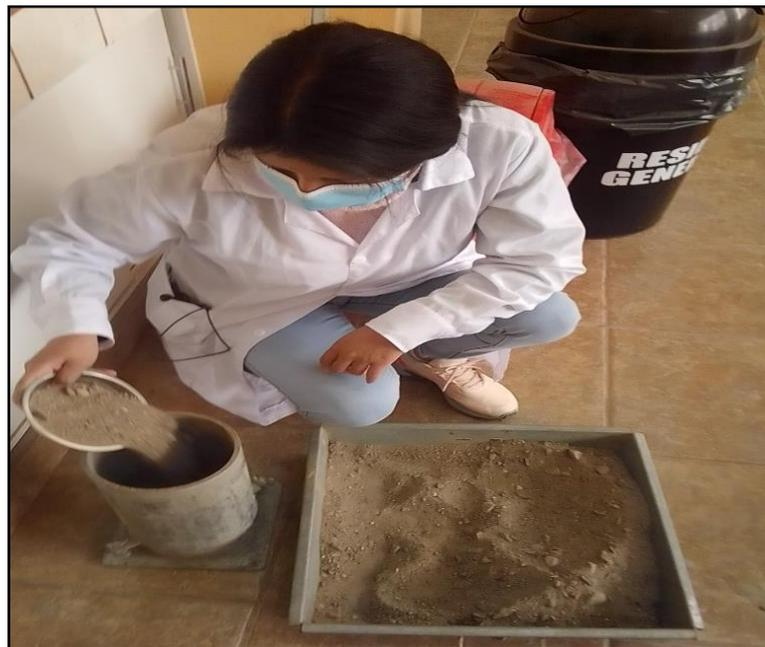
Figura 21. Metemos la muestra dentro del recipiente en forma helicoidal.
