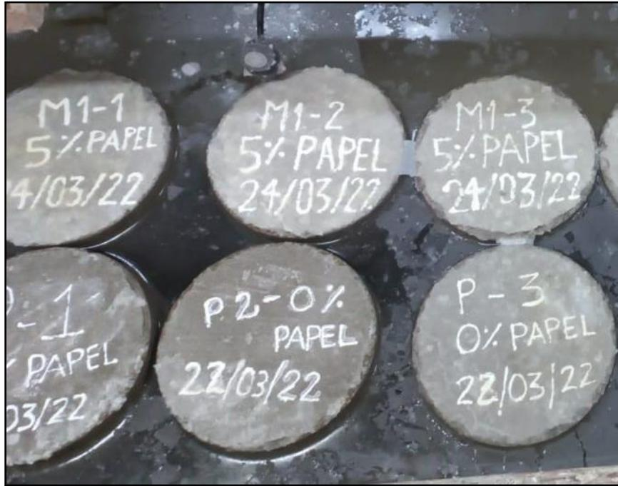
Figura 79. Nomenclatura de las probetas
