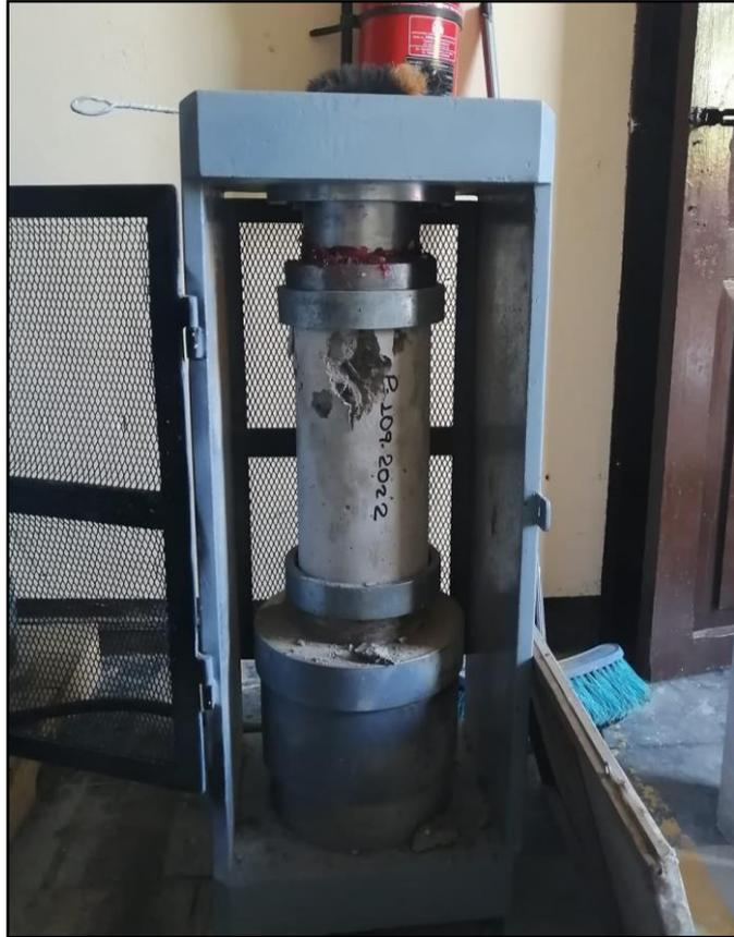
Figura 89. Falla de probeta sometida al ensayo de resistencia a compresión
