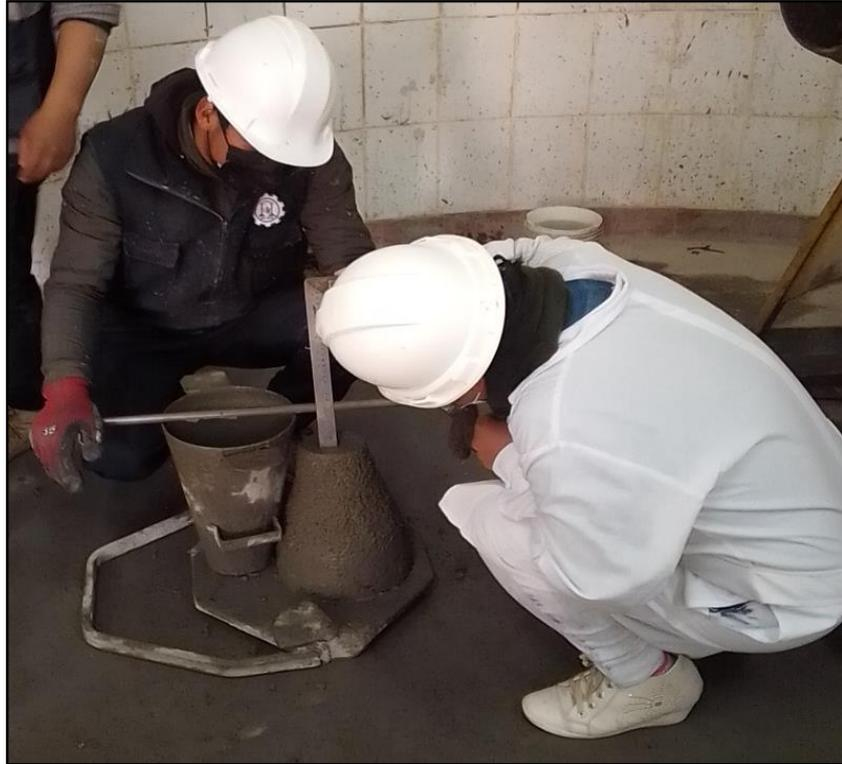
Figura 68. Verificación del slump de 3"
