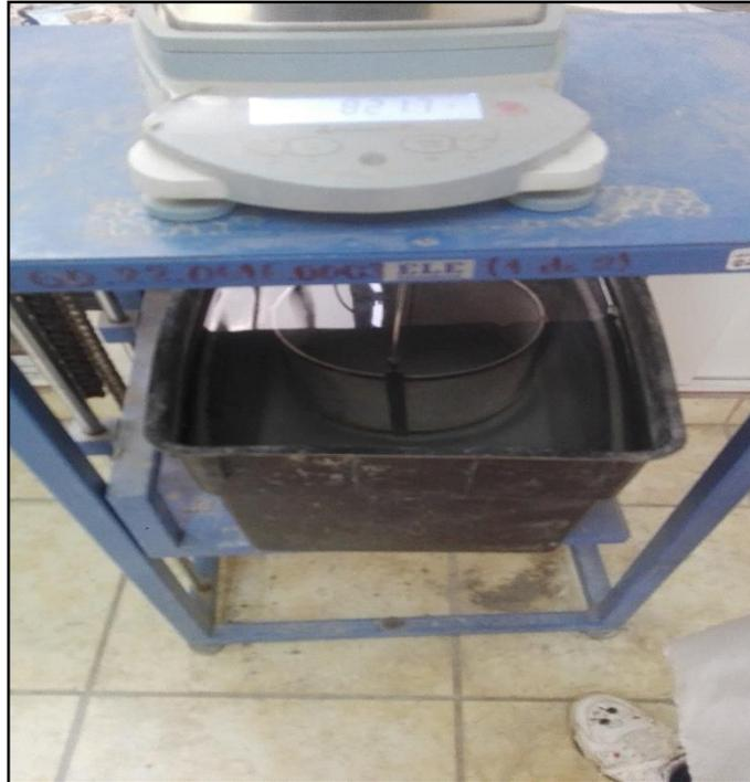
Figura 43. Peso de la canastilla sumergida
