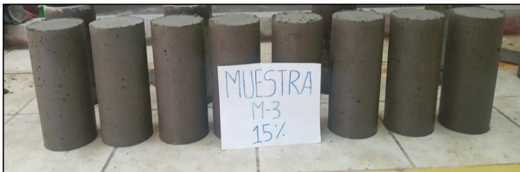
Figura 82. Probetas de concreto para el ensayo de compresión
