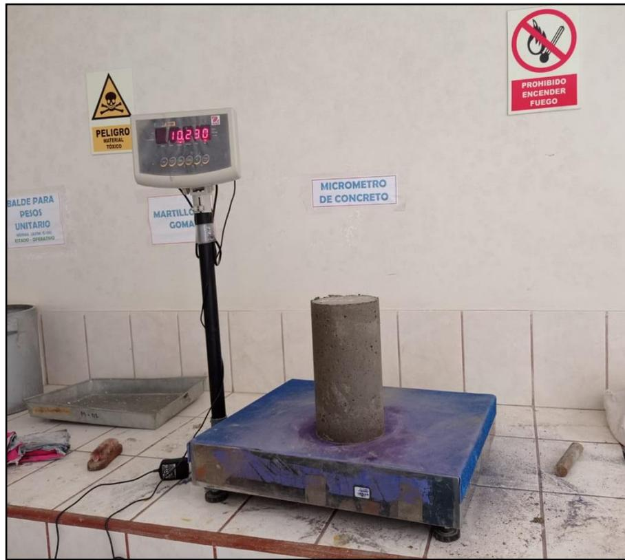
Figura 75. Peso de probetas antes de ser sumergidas
