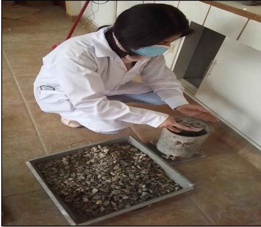
Figura 25. Introduciendo en forma helicoidal la muestra del agregado grueso
