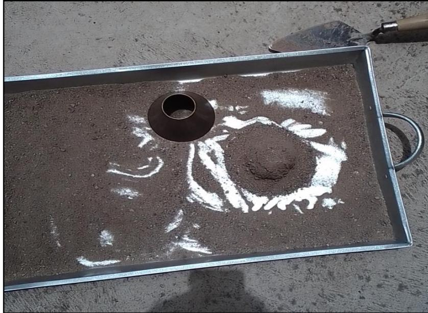
Figura 32. Desintegración de la muestra una vez retirada el cono.
