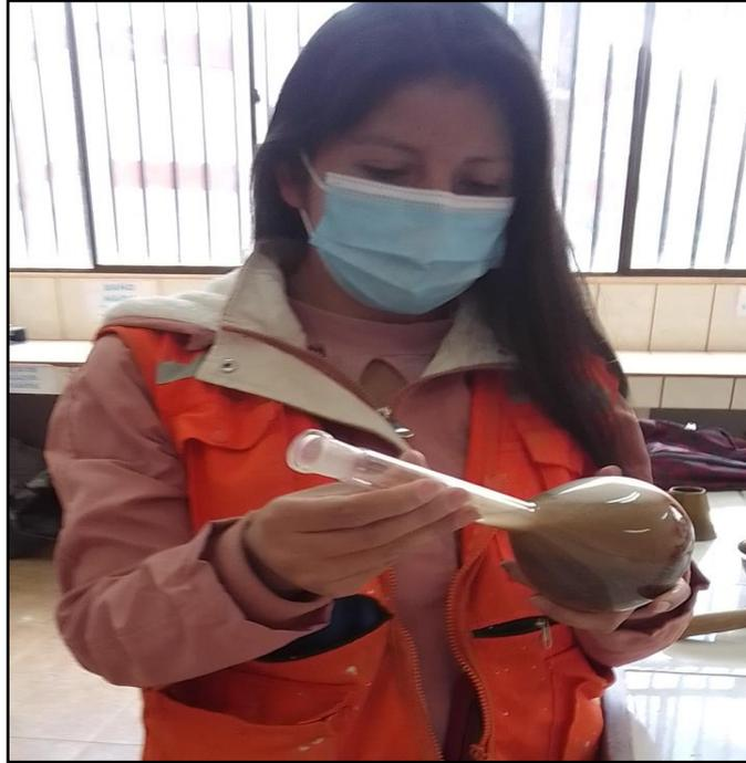
Figura 34. Extracción del aire de la fiola
