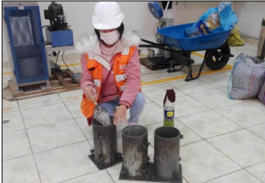
Figura 69. Preparación de los moldes cilíndricos
