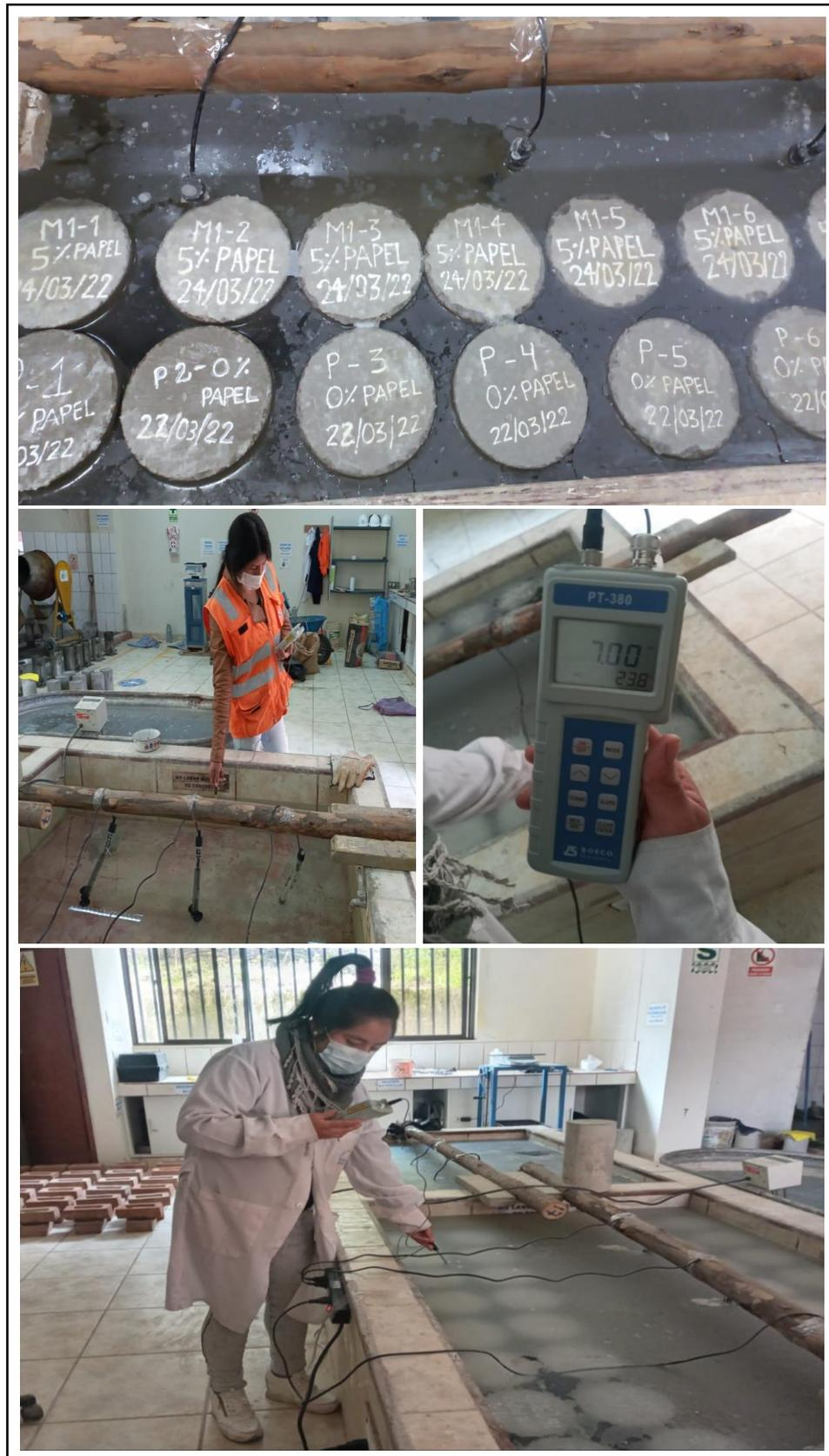
Figura 105. Proceso de curado de las probetas cilíndricas de concreto y control de temperatura.
