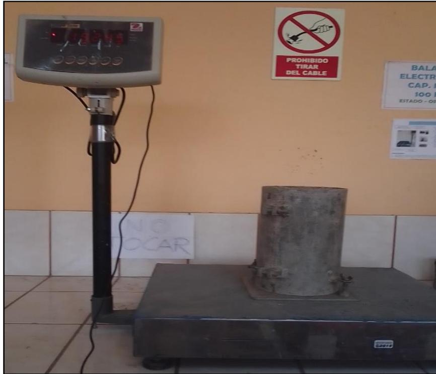
Figura 24. Peso del cilindro más la muestra compactada del agregado fino
