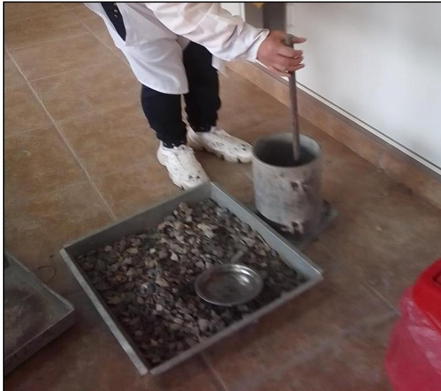
Figura 27. Compactado de la muestra (agregado grueso)
