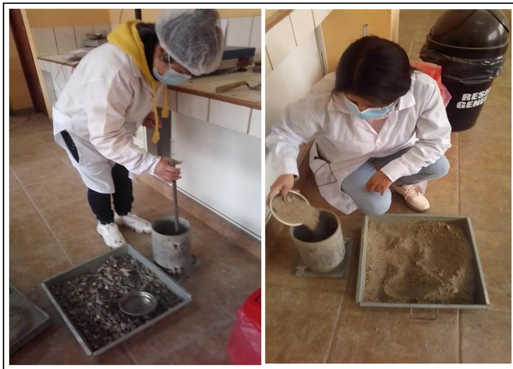
Figura 101. Proceso del ensayo de peso unitario suelto y compactado de los agregados.
