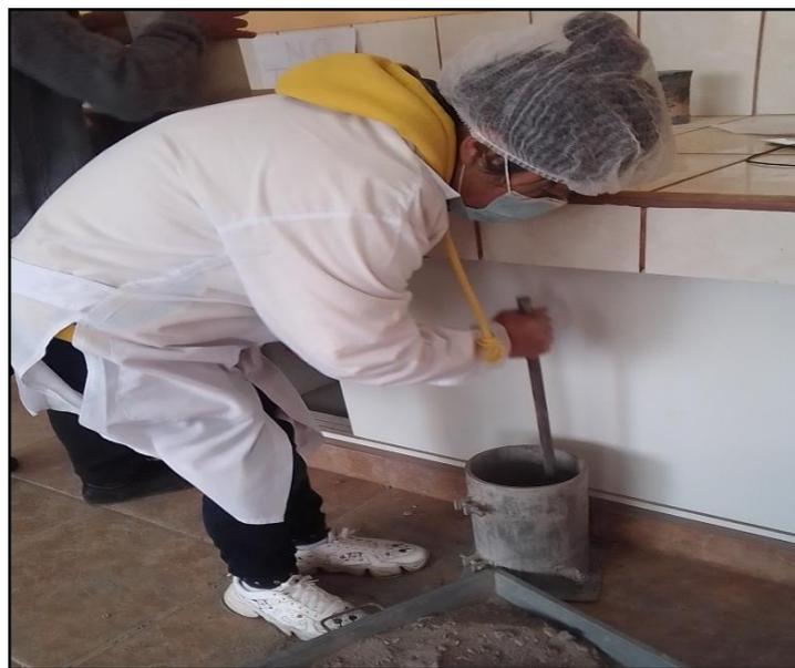
Figura 23. Compactado de la muestra (agregado fino)
