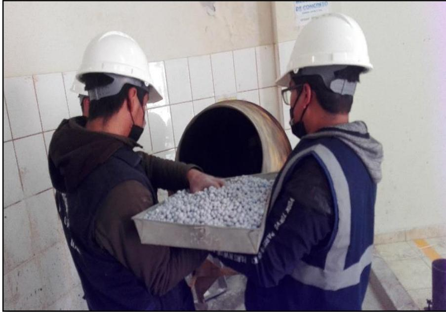
Figura 64. Incorporación del 15% de papel en forma redondeada a la mezcladora
