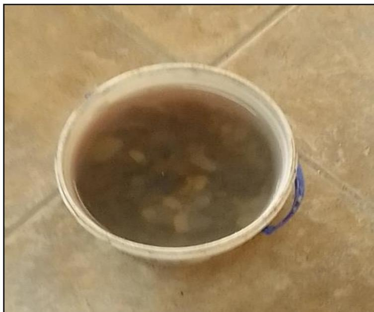
Figura 40. Agregado grueso sumergido en agua en su totalidad
