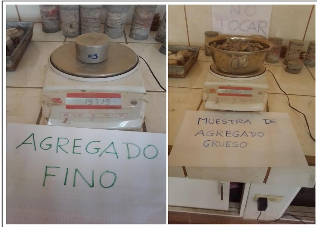
Figura 100. Proceso del ensayo de contenido de humedad de los agregados.
