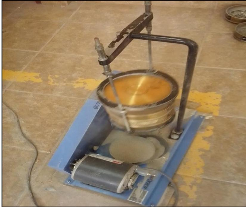
Figura 14. Vibrado ambos agregados en la tamizadora
