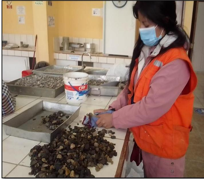
Figura 41. Secado superficial del agregado grueso
