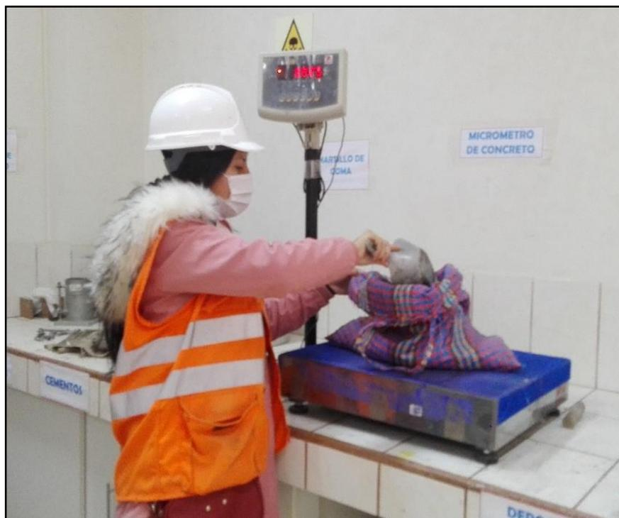
Figura 57. Peso del agregado grueso para muestra M1: 5% de papel reciclado.
