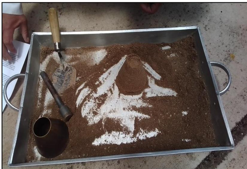
Figura 31. Prueba de cono del agregado fino hasta llegar superficialmente seca
