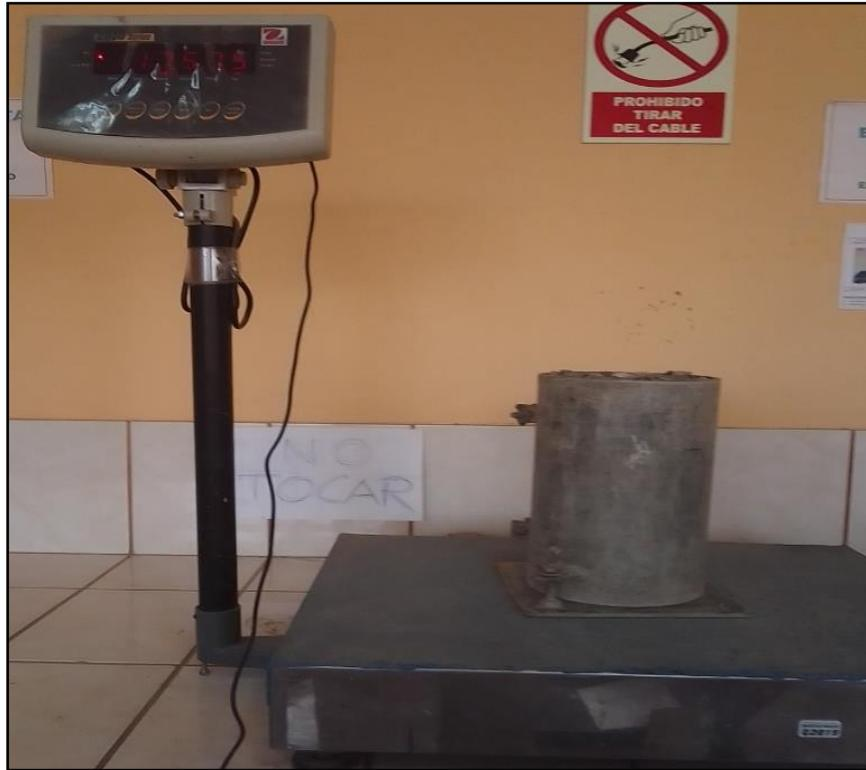
Figura 28. Peso del cilindro más la muestra compactada del agregado grueso
