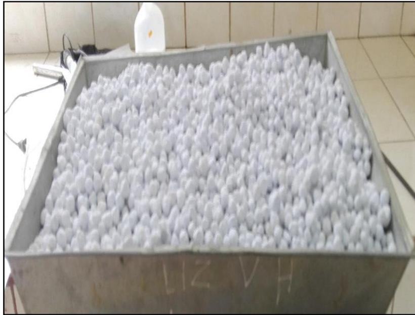
Figura 53. Secado del papel reciclado en forma redondeada.
