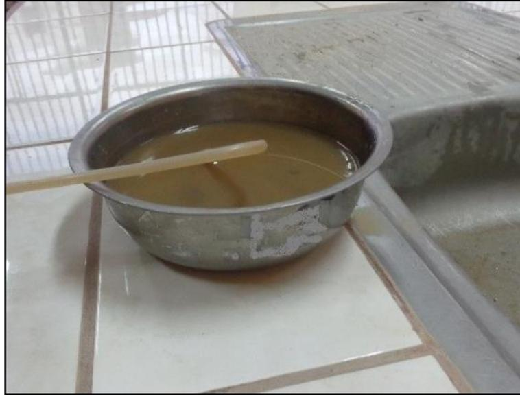
Figura 36. Extracción de la muestra del picnómetro a una bandeja para ser llevado al horno
