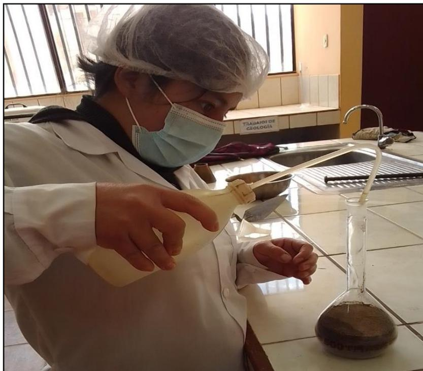
Figura 33. Introduciendo agua al picnómetro con la muestra de ensayo ya introducida
