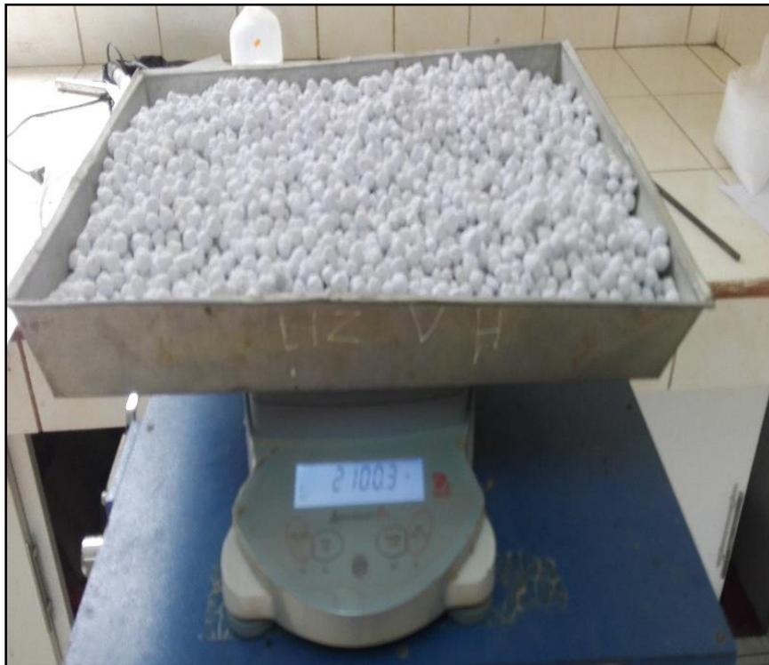
Figura 59. Peso del papel reciclado en forma redondeada para muestra M2: 10% de papel reciclado
