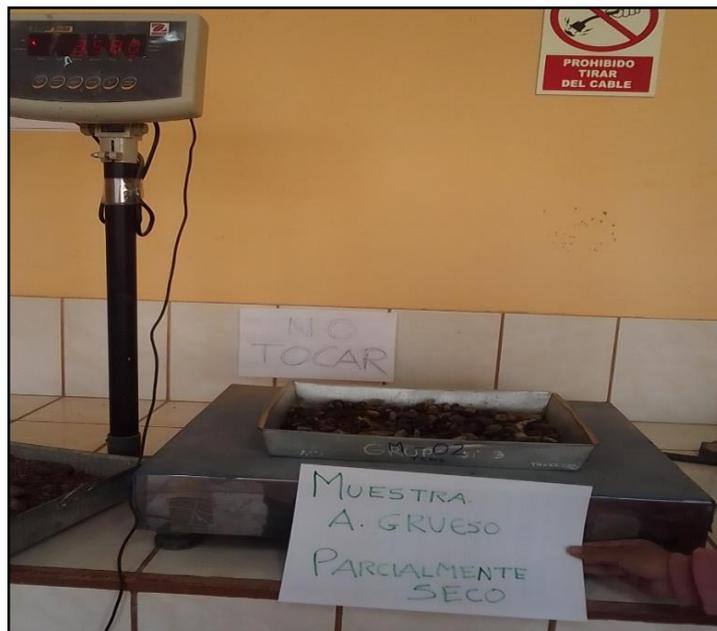
Figura 42. Peso del recipiente más peso del agregado grueso parcialmente seca
