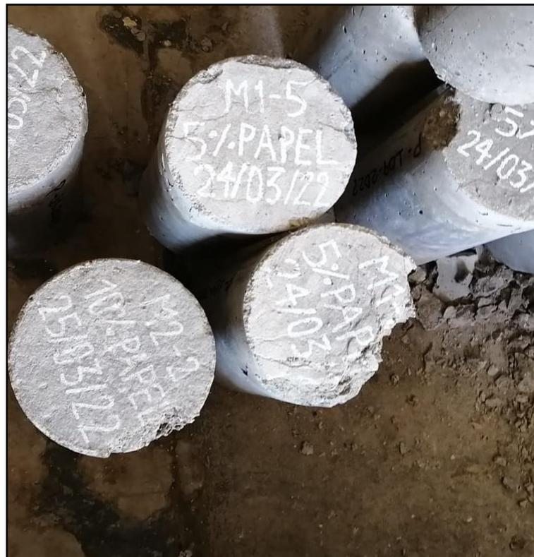
Figura 92. Falla tipo 5: fractura de lados en las bases
