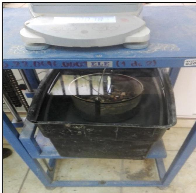
Figura 44. Peso del agregado más la canastilla sumergido en agua
