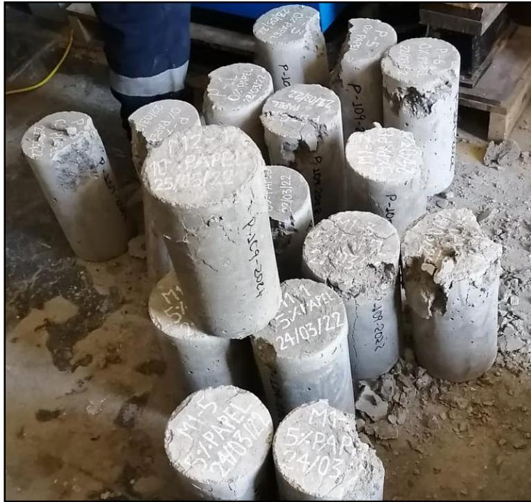
Figura 93. Probetas sujetas al ensayo de resistencia a compresión
