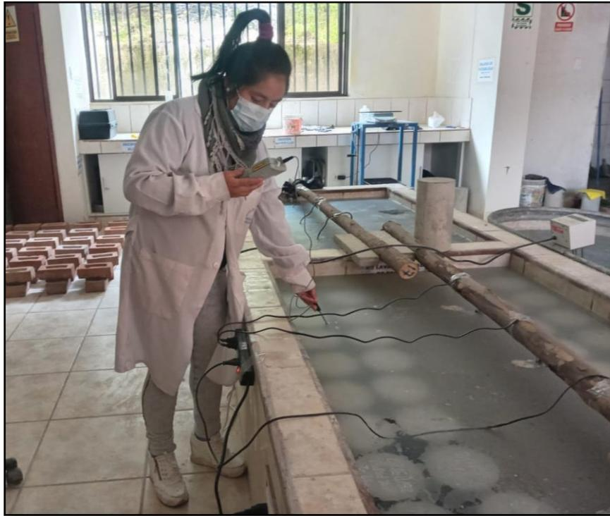
Figura 78. Monitoreo de temperatura del agua para el curado de las probetas
