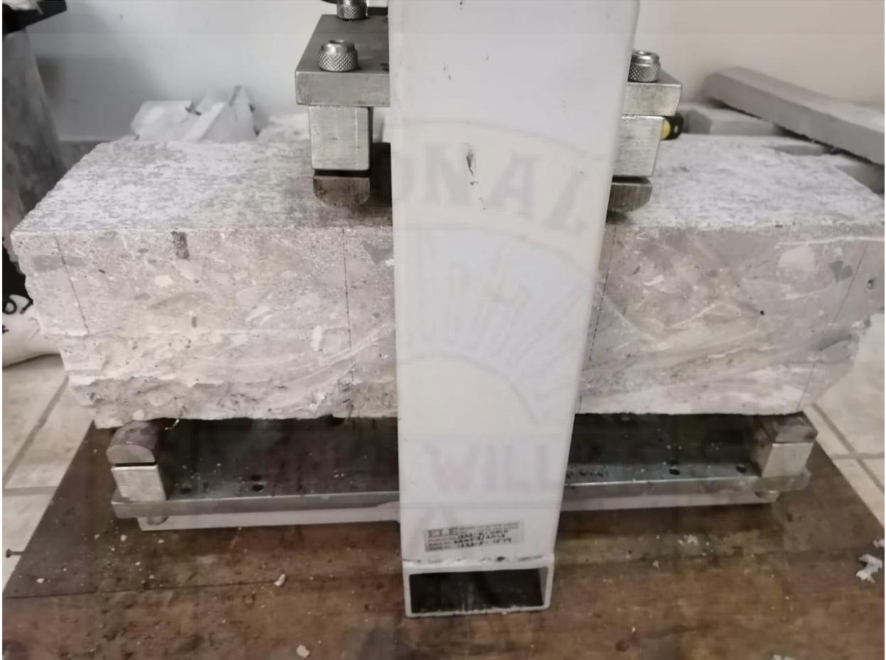
**Panel Fotográfico:** Muestra en el equipo de ensayo a flexion.
