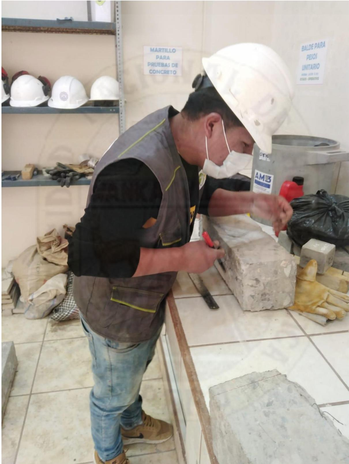
**Panel Fotográfico:** Recopilación de información dimensional de la muestra de pavimento.
