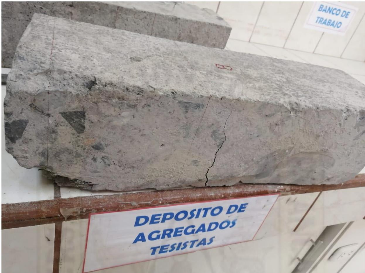
**Panel Fotográfico:** Muestra de pavimento después del ensayo
