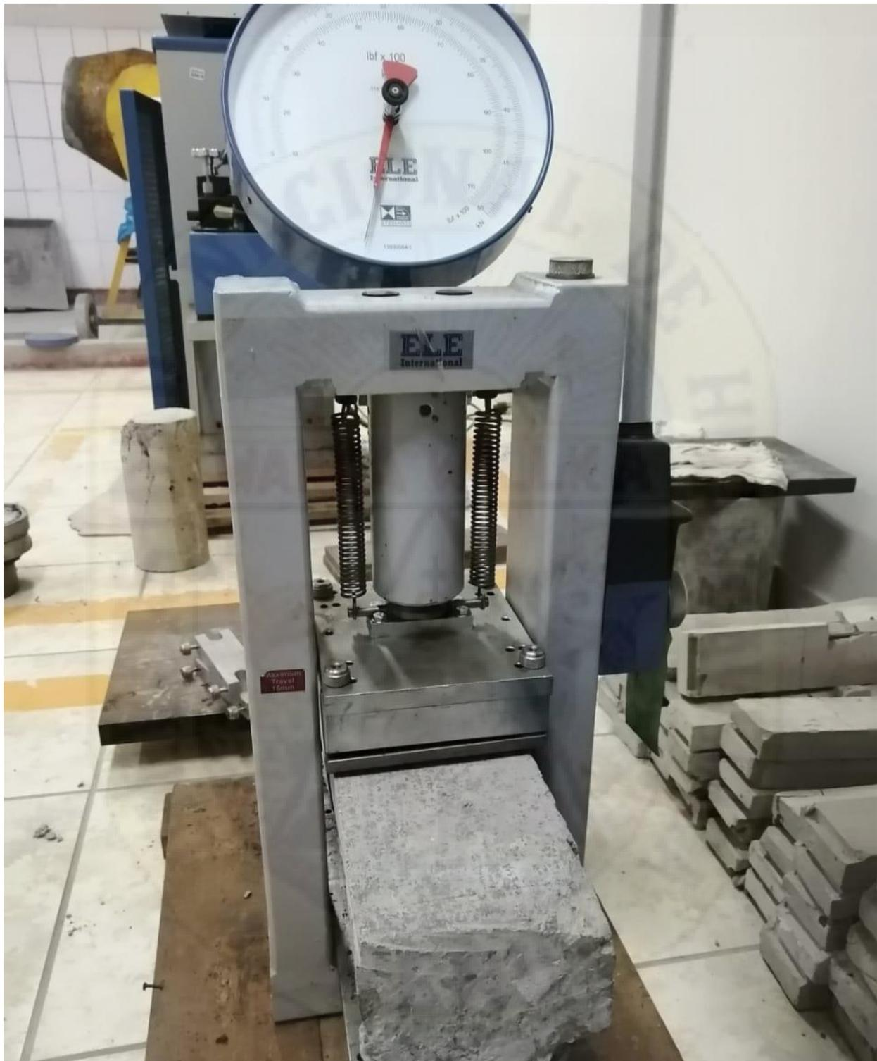
**Panel Fotográfico:** Ensayo a flexión en muestras de pavimento
