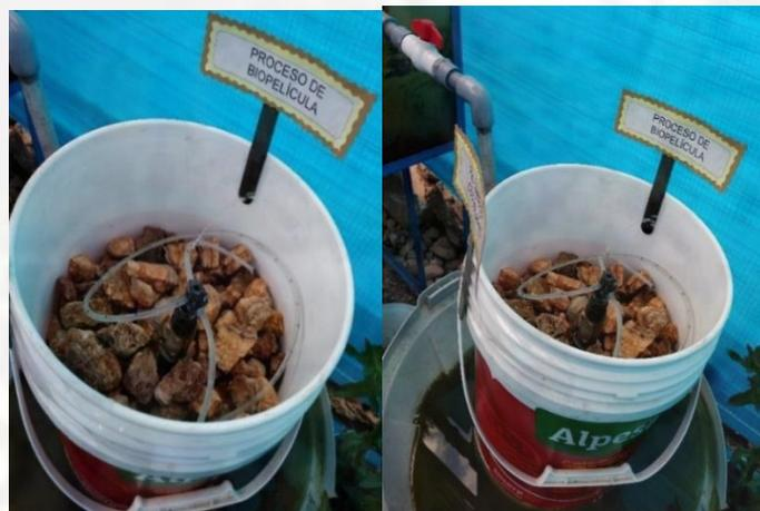
**Figura 13.** Proceso de biopelícula con lecho filtrante.
