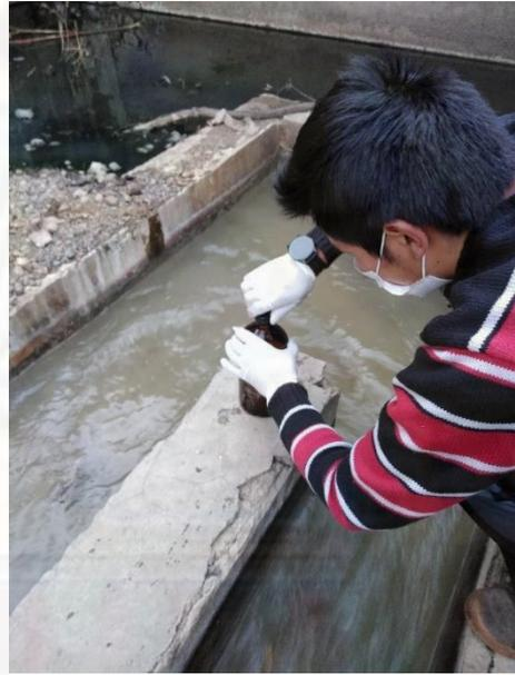
*Figura 82.* El frasco debe estar bien sellado para evitar fugas durante el transporte hacia Lima.
