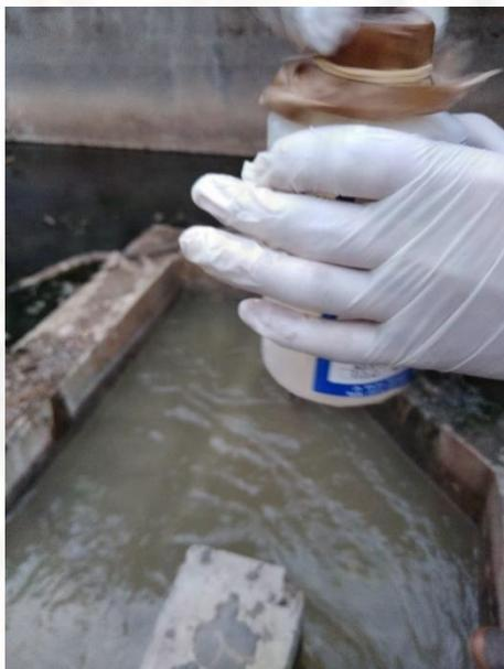
*Figura 83.* Sellado del frasco para parámetros microbiológicos.
