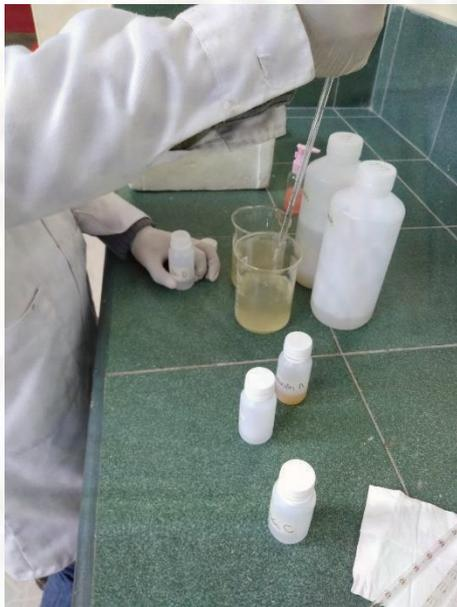
**Figura 65.** Adición de nutrientes (Solución A, B, C y D) a las muestras.
