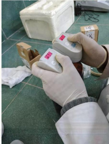
*Figura 18. Ajuste de la escala de 250 mg O 2/L.*
