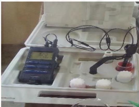
*Figura 47. Monitoreo del pH del afluente y efluente del sistema.*
