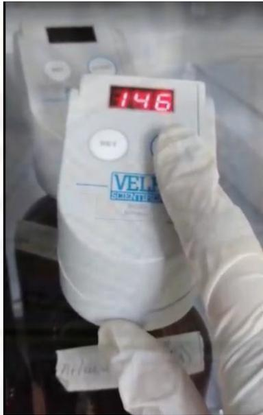
*Figura 73. Resultados de medición de la DBO<sub>5</sub> del afluente, el mismo que se determinó el 13/09/2019.*
