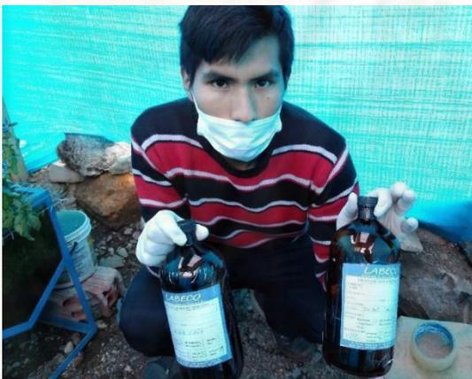
**Figura 87.** Frascos que contienen las muestras para el análisis de la DQO y la determinación de aceites y grasas.
