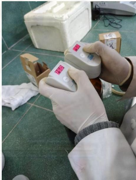
*Figura 70.* Se reguló cada uno de los sensores a 250 mg O<sub>2</sub>/l, ya que el volumen con el que se trabajó fue de 250 ml.
