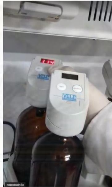
*Figura 74. Resultados de medición de la DBO<sub>5</sub> del efluente, el mismo que se determinó el 13/09/2019.*
