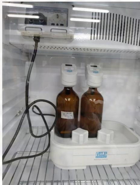
*Figura 19. Conexión del equipo de agitación a la incubadora a 20 °C.*
