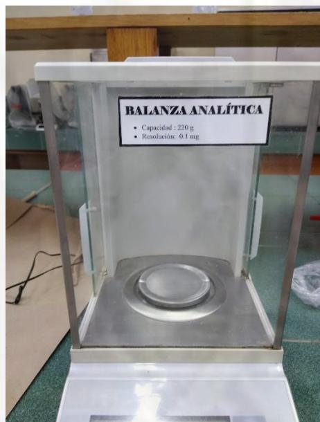
**Figura 60.** Balanza analítica para pesar los reactivos y preparar la solución.
