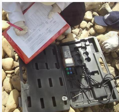
*Figura 48. Medida del pH del afluente y efluente del sistema.*
