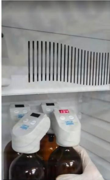
*Figura 77. Resultados de medición de la DBO<sub>5</sub> del afluente el mismo que se determinó el 21/09/2019.*
