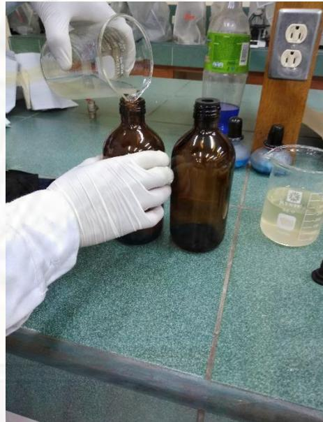
**Figura 66.** Preparación de los frascos para el llenado de las muestras con los nutrientes añadidos.
