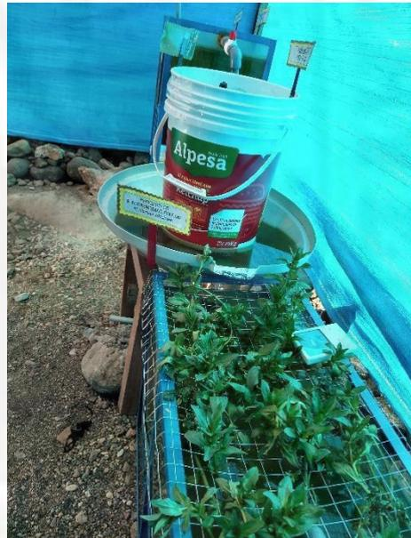
*Figura 41.* Adaptación de las especies (berro) para el proceso de fitorremediación.
