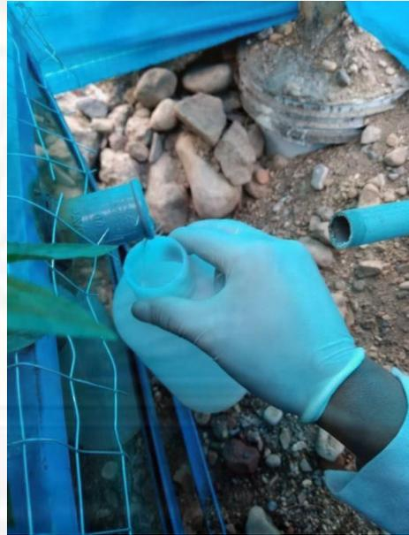
*Figura 54. Recolección de muestra en el efluente del sistema.*
