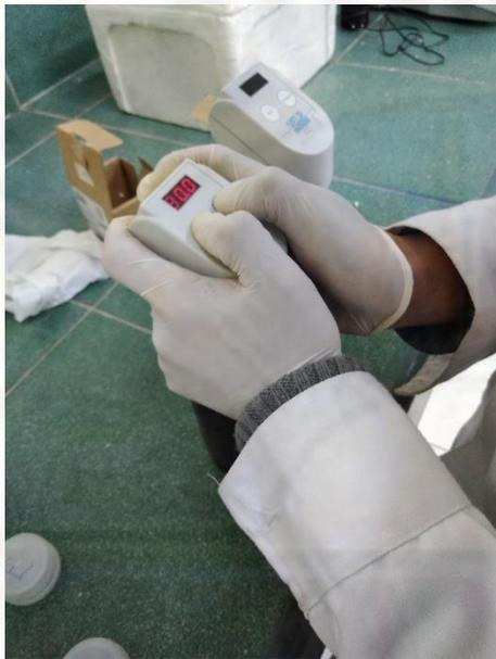
*Figura 69.* Regulación de la escala de acuerdo al volumen de muestra.
