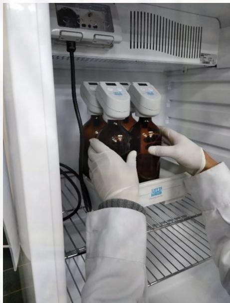
*Figura 72.* Se colocaron las muestras en la incubadora para dar inicio a la medición.
