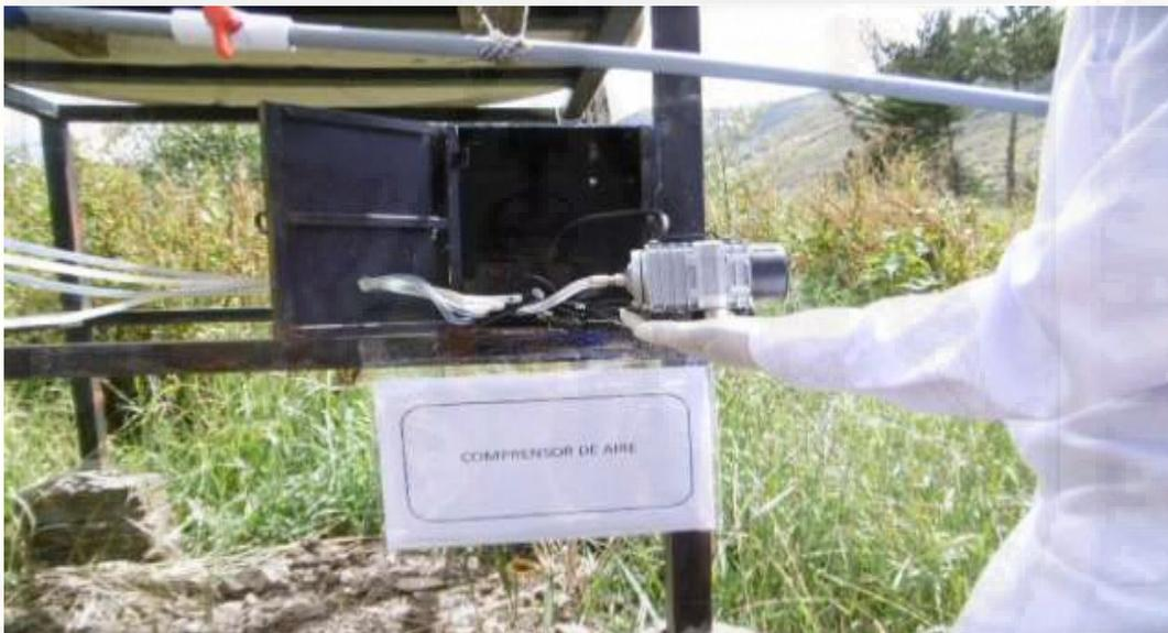
**Figura 57.** Compresor de aire de 38 L/s con cuatro salidas funciona durante todo el periodo de evaluación y toma de muestras.
