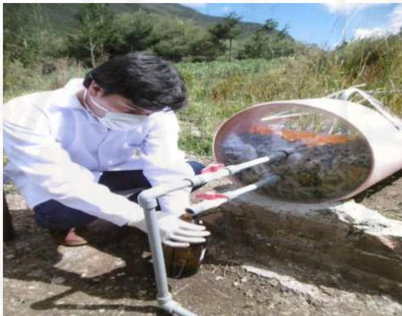
**Figura 21.** Muestreo de la calidad de agua en el efluente del humedal artificial optimizado.
