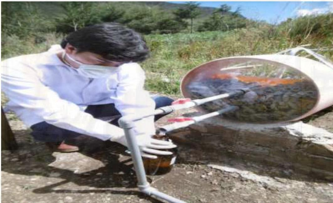
**Figura 59.** Muestreo de la calidad de agua del efluente del humedal artificial optimizado para el parámetro de Demanda Bioquímica de Oxígeno.
