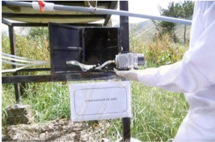
**Figura 16.** Compresor de aire de 38 L/min de caudal de aire marca ACO-001.
