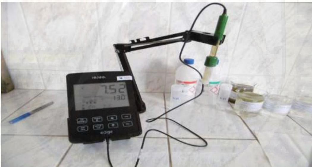
**Figura 61.** Multipárametro marca “HANNA” modelo moderno “EDGE” para análisis de pH y temperatura.
