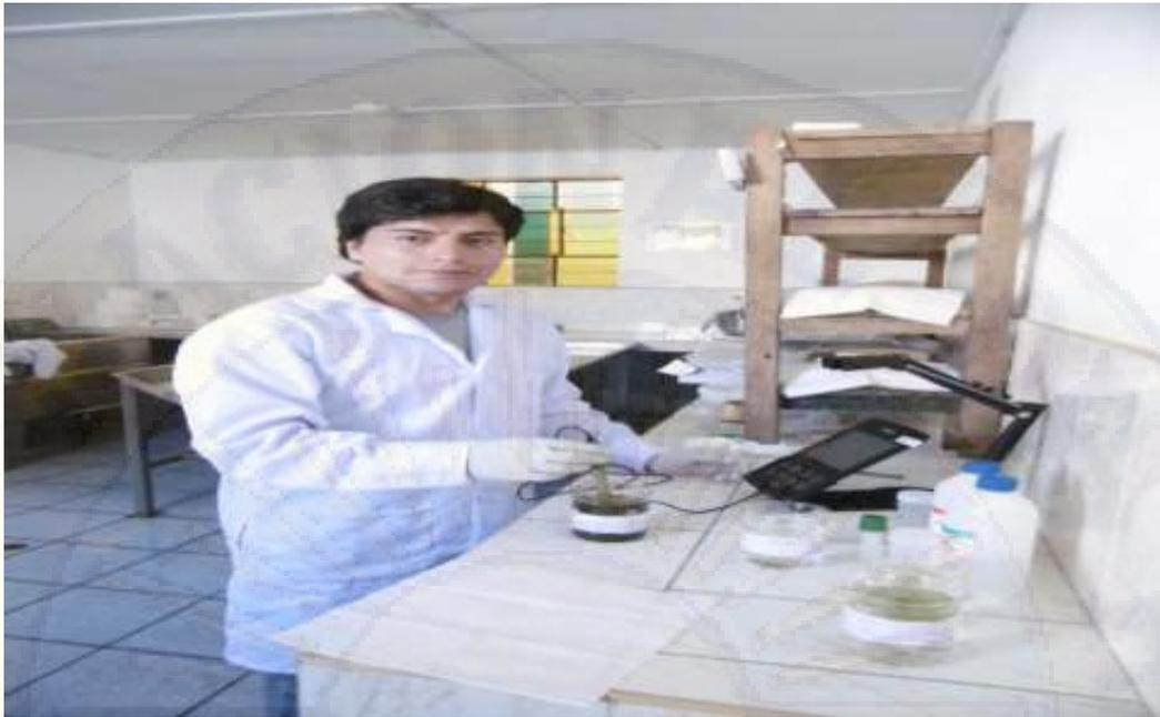
**Figura 62.** Análisis de pH y temperatura del afluente de agua residual que ingresa a las unidades de tratamiento.
