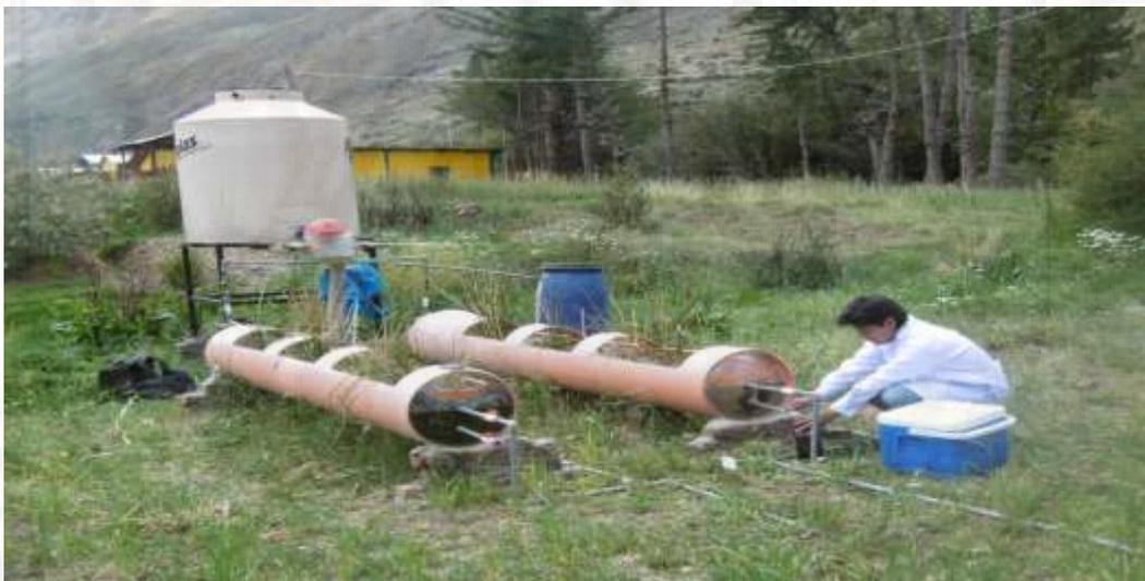
**Figura 53.** Muestreo de la calidad del agua del afluente y efluente de los humedales artificiales tradicional y optimizado.
