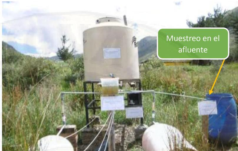
**Figura 20.** Muestro de calidad de agua en el afluente a las unidades de tratamiento.
