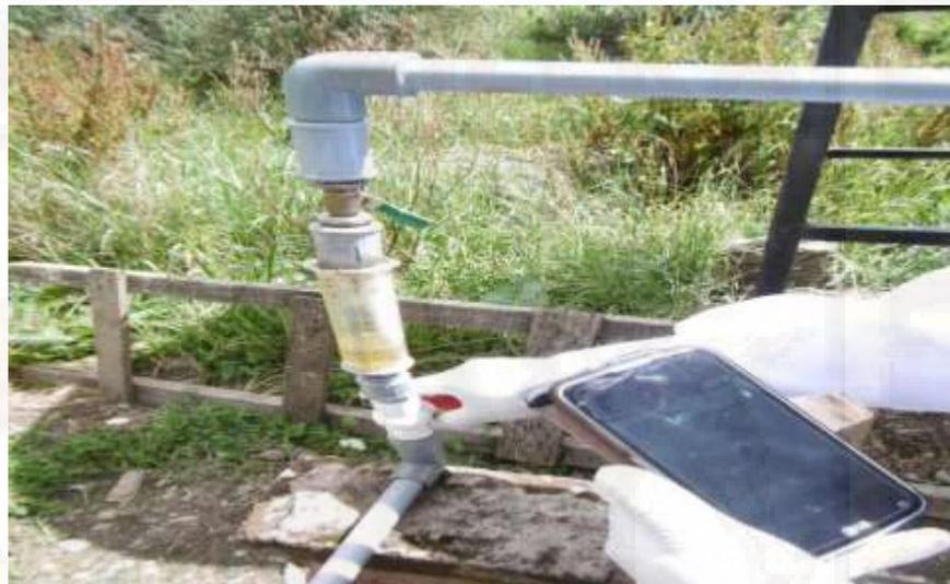
**Figura 13.** Medidor de caudal tipo volumétrico 23 ml/min.
