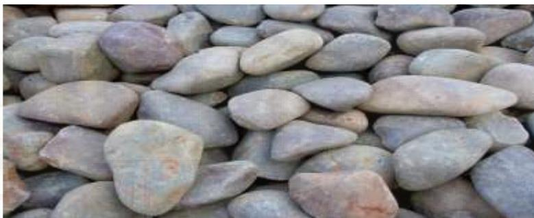
**Figura 8.** Muestra de gravas de diámetro entre 1 y 2 pulgadas.
