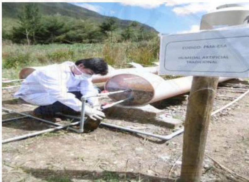
**Figura 22.** Monitoreo de calidad de agua en el humedal artificial tradicional
