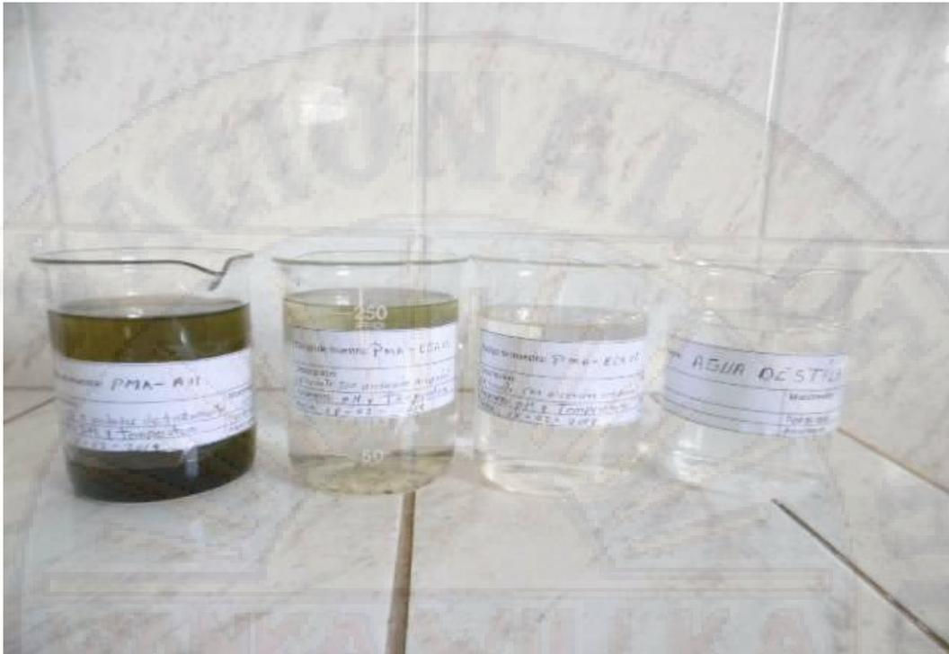
**Figura 66.** Vista de las muestras del afluente y efluentes de los humedales artificiales tradicional y optimizado.
