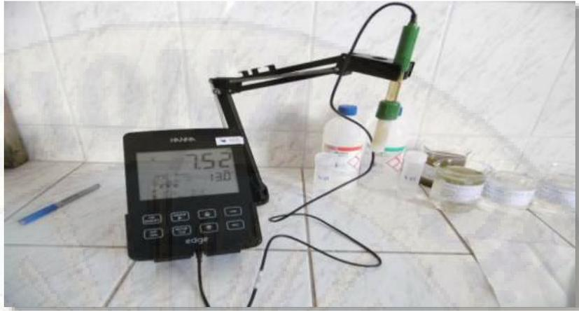
**Figura 23.** Análisis de pH y Temperatura con multiparametro Hanna modelo Edge.
