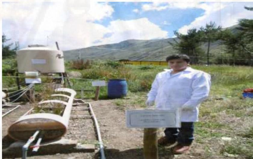
**Figura 14.** Humedal artificial subsuperficial de flujo horizontal de tipo tradicional: medio filtrante de grava y totora.
