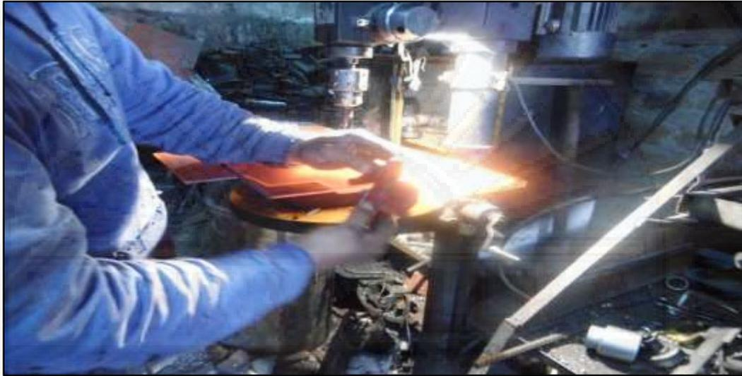
**Figura 48.** Perforación del vinil de ½ pulg para uniformizar el flujo en el humedal artificial.
