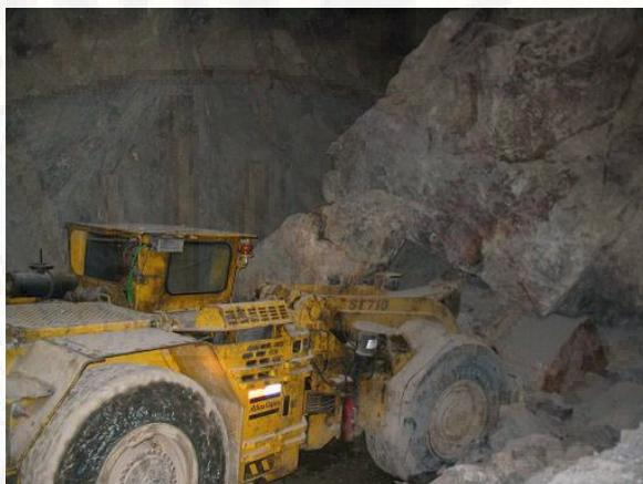
Figura 4: Accidente por caída de rocas en una mina peruana
