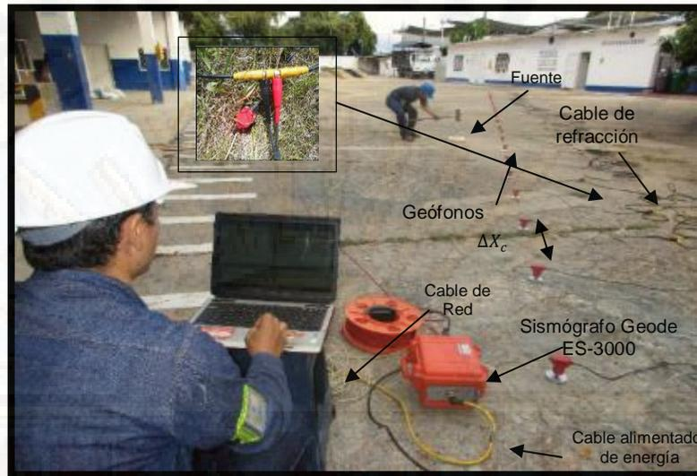
Figura 14. Sismógrafo y Adquisición de datos
