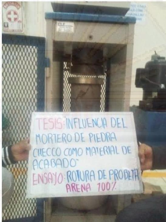
Fotografía 59. Ensayo a compresión de los testigos con 100% de material Checco.
