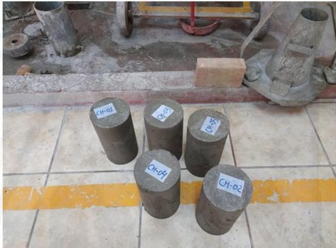
Fotografía 54. Especímenes cilíndricos con 100 % de material Checco a 28 días de edad.
