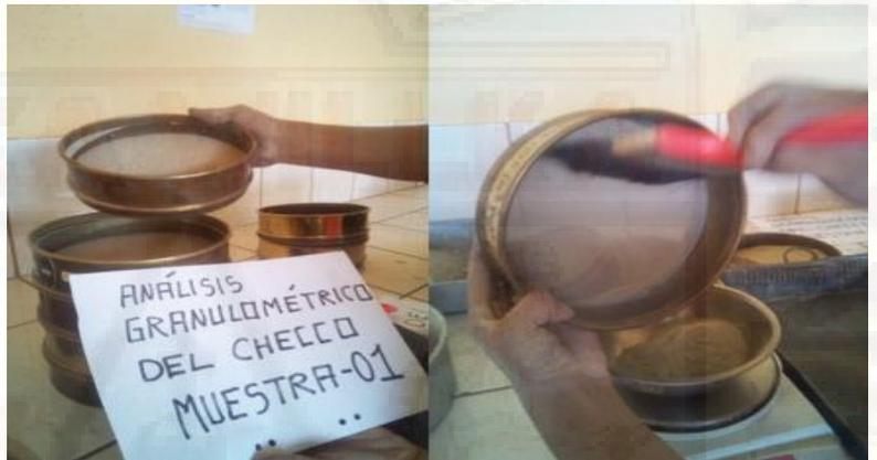
Fotografía 17. Peso de la masa retenida en los tamices del material Checco.
