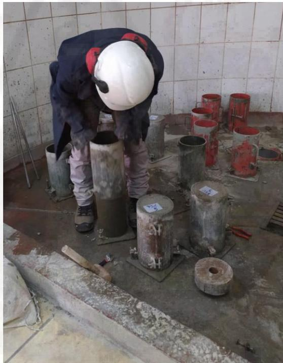
Fotografía 45. Desencofrado de los especímenes de mortero con arena fina.
