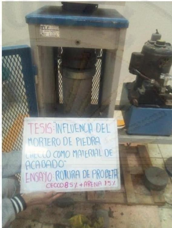
Fotografía 57. Ensayo a compresión de los testigos con 85% de material Checco más 15% de arena fina.
