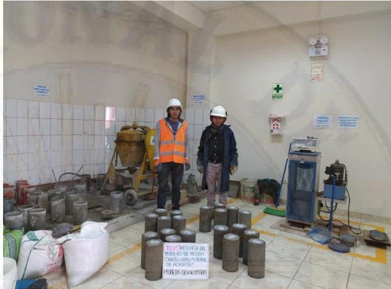
Fotografía 46. Especímenes de mortero desencofrados.
