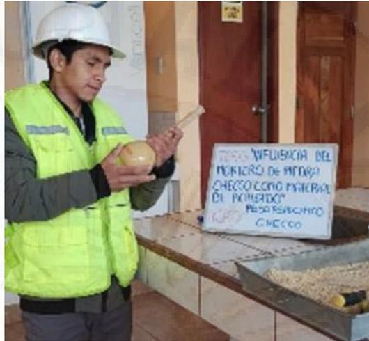
Fotografía 29. Eliminación de aire atrapado por agitación manual del material Checco.
