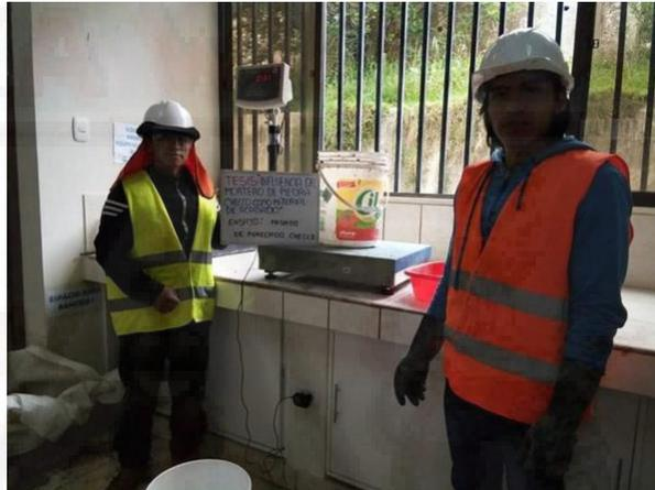
Fotografía 35. Pesado del material Checco para la elaboración de testigos cilíndricos.
