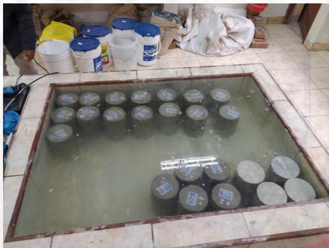
Fotografía 51. Especímenes de los tratamientos en el proceso de curado inicial inmersos en la poza de curado.
