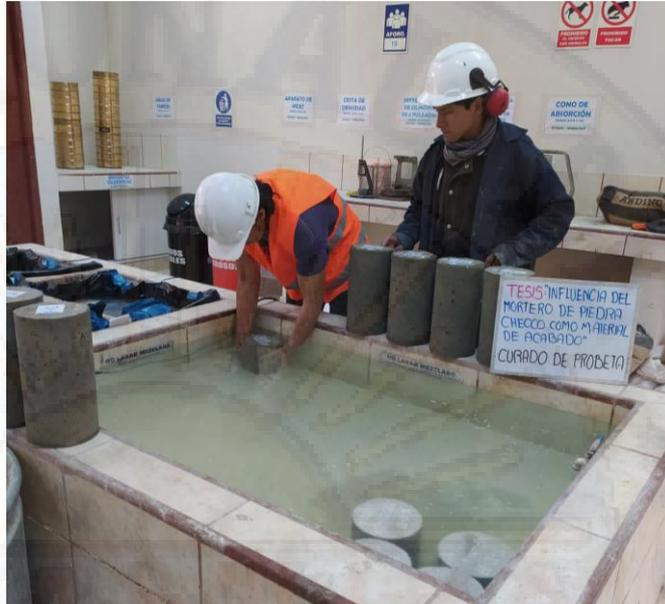
Fotografía 50. Inmersión de los testigos de mortero en la poza de curado.
