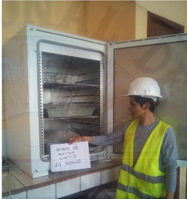
Fotografía 10. Secado al horno del material Checco.
