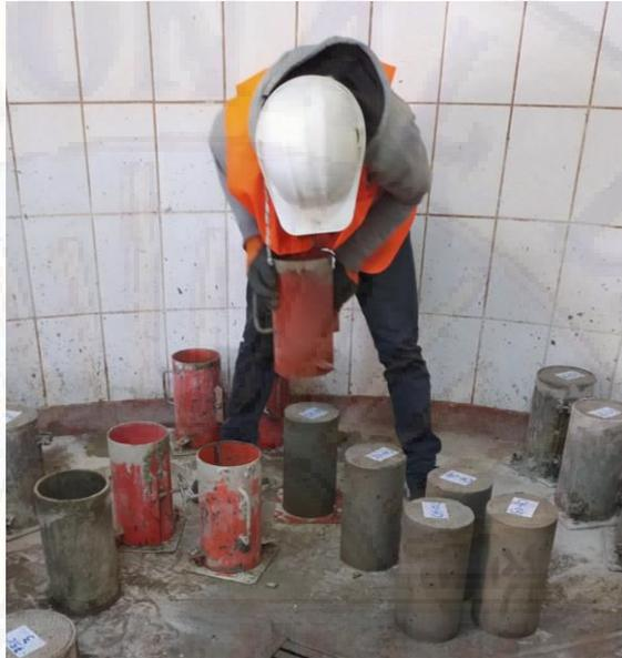
Fotografía 44. Desencofrado de los especímenes de mortero con material Checco.
