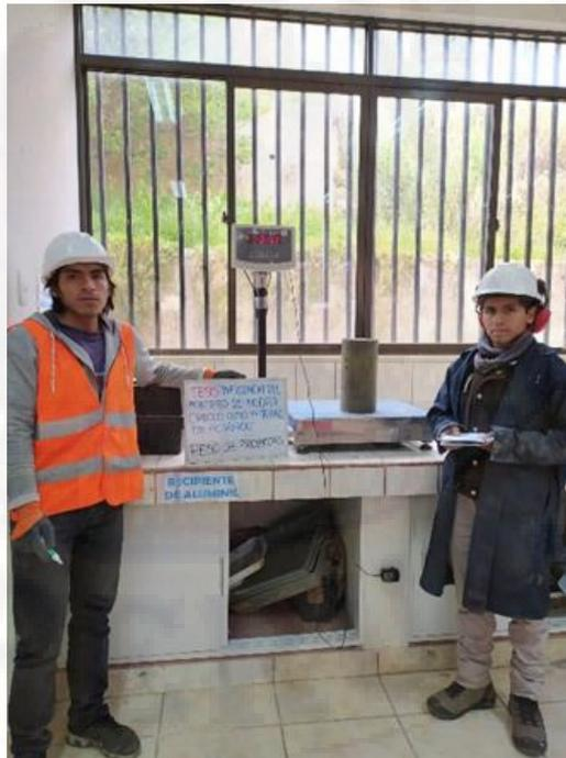
Fotografía 47. Peso de los especímenes de mortero antes del curado.
