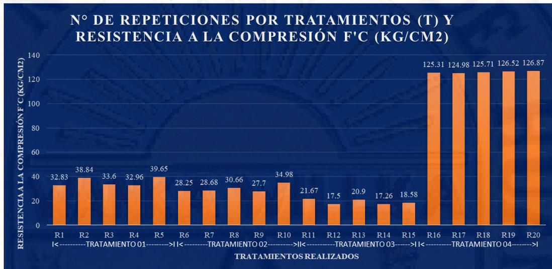
Figura 10. Comparación del resultado de la resistencia a compresión de los testigos cilíndricos de los diferentes tratamientos.
