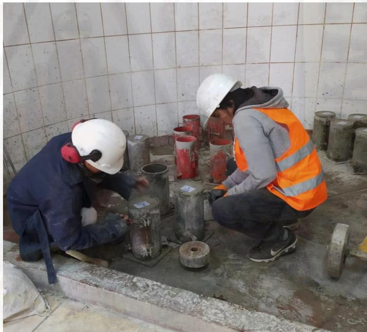
Fotografía 43. Proceso de desencofrado de los especímenes de mortero.
