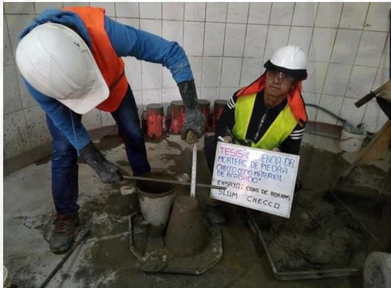
Fotografía 39. Verificación del asentamiento óptimo del diseño de mezcla con arena fina.
