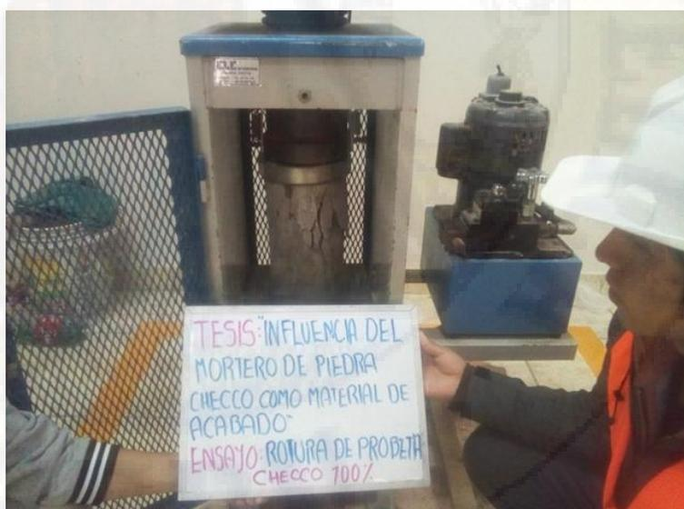
Fotografía 58. Ensayo a compresión de los testigos con 100% de material Checco.
