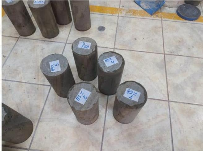
Fotografía 53. Especímenes cilíndricos con 85% de material Checco a 28 días de edad.
