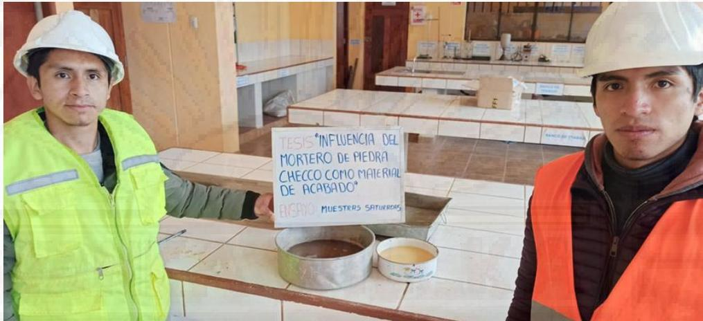
Fotografía 24. Muestra de material Checco y arena fina sumergida en agua durante 24 horas.
