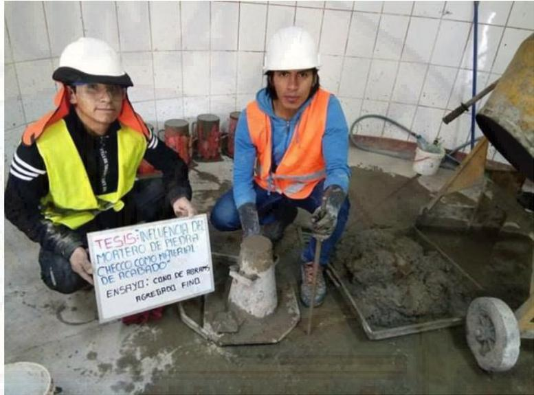
Fotografía 38. Ensayo de cono de Abrams.
