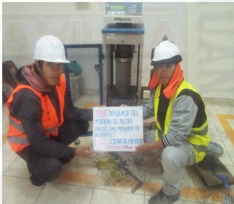
Fotografía 56. Ensayo a compresión de los testigos con 75% de material Checco más 25% de arena fina.
