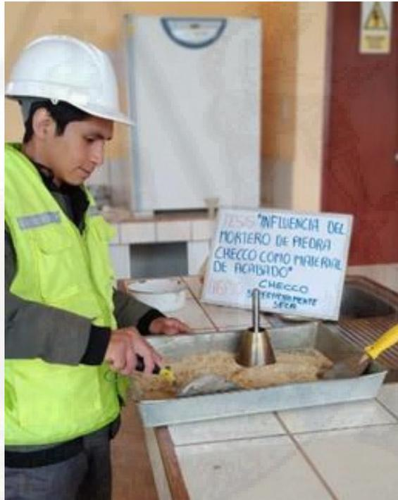
Fotografía 25. Secado homogéneo superficialmente seco del material Checco.
