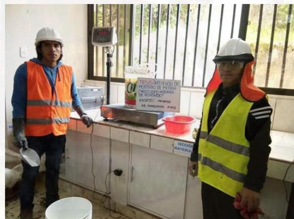
Fotografía 36. Pesado de la arena fina para la elaboración de testigos cilíndricos.
