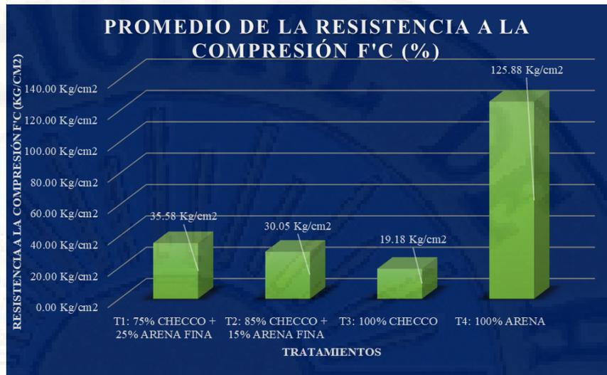
Figura 11. Promedio del resultado de la resistencia a compresión de los testigos cilíndricos de los diferentes tratamientos.
