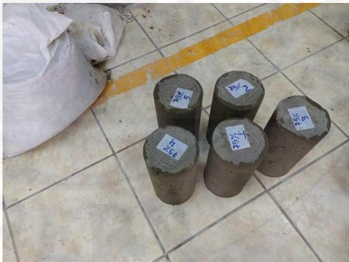
Fotografía 52. Especímenes cilíndricos con 75% de material Checco a 28 días de edad.
