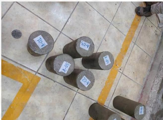
Fotografía 55. Especímenes cilíndricos con 100 % de arena fina a 28 días de edad.
