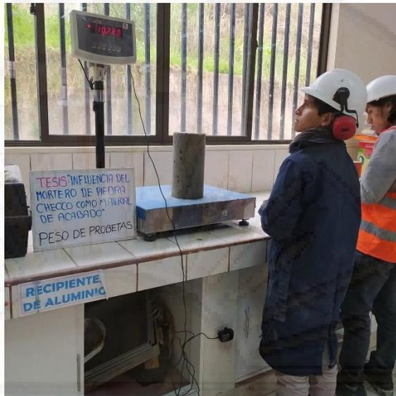
Fotografía 48. Registro de los pesos de los especímenes de mortero.
