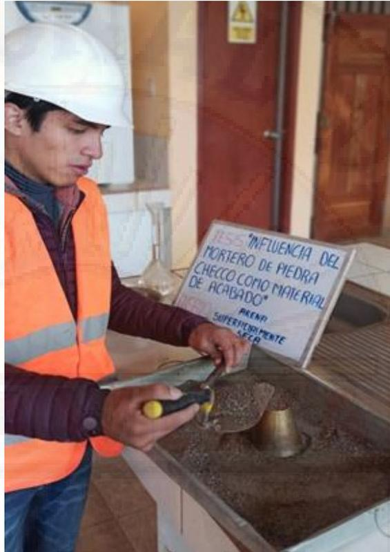
Fotografía 26. Secado homogéneo superficialmente seco de la arena fina.
