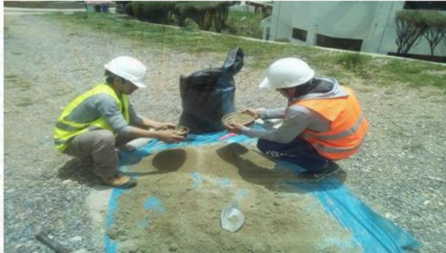
Fotografía 7. Zarandeo del material Checco disgregado por el tamiz N°04.
