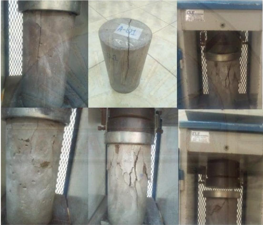
Fotografía 60. Testigos cilíndricos sometidos a compresión axial.
