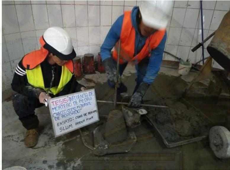
Fotografía 40. Verificación del asentamiento óptimo del diseño de mezcla con material Checco.
