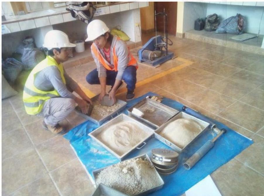
Fotografía 6. Disgregado por chancado con pisón mecánico del material Checco.
