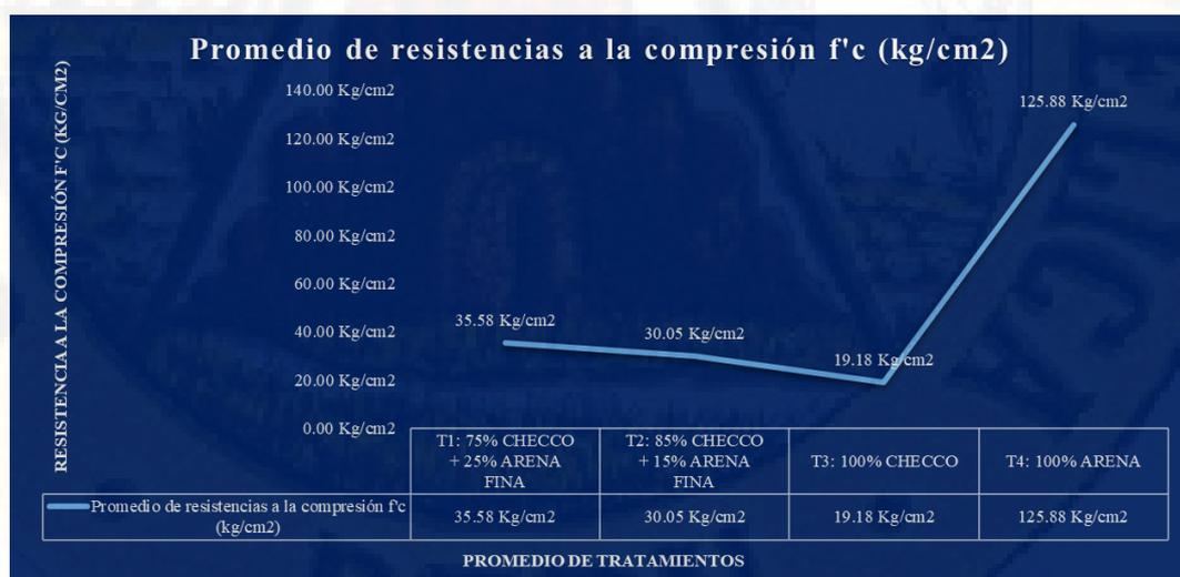
Figura 12. Comportamiento de la resistencia a la compresión de los testigos cilíndricos de los diferentes tratamientos.
