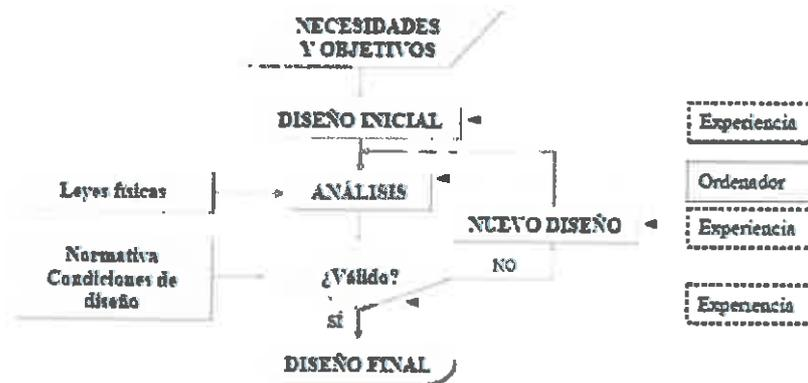
Figura 2. Proceso de diseño prueba y error
