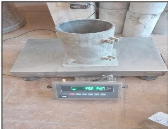
**Fotografía 18.** Pesado del molde vacío.
