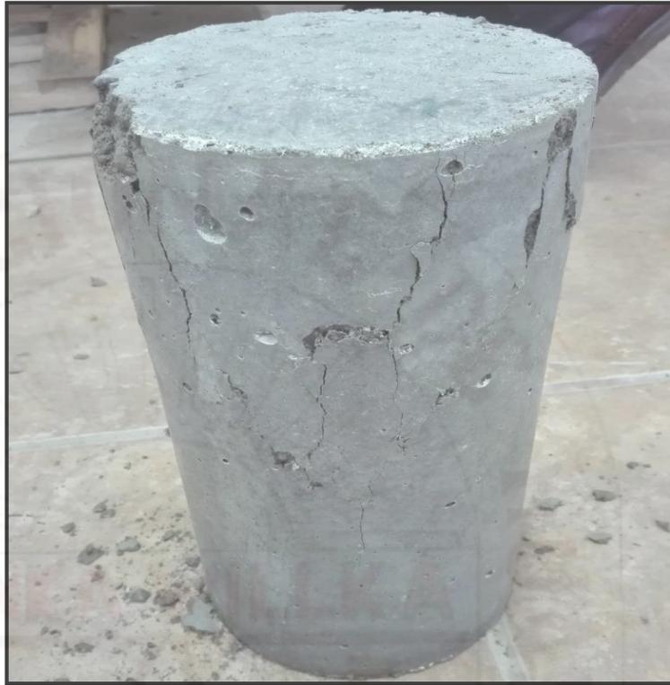
**Fotografía 89.** Falla cónico y cortante de probetas.
