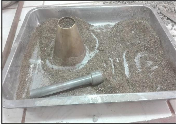
**Fotografía 29.** Prueba de cono para la muestra.
