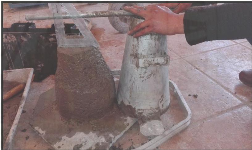
**Fotografía 105.** Ensayo de cono de Abrams para el T0 0% RM.
