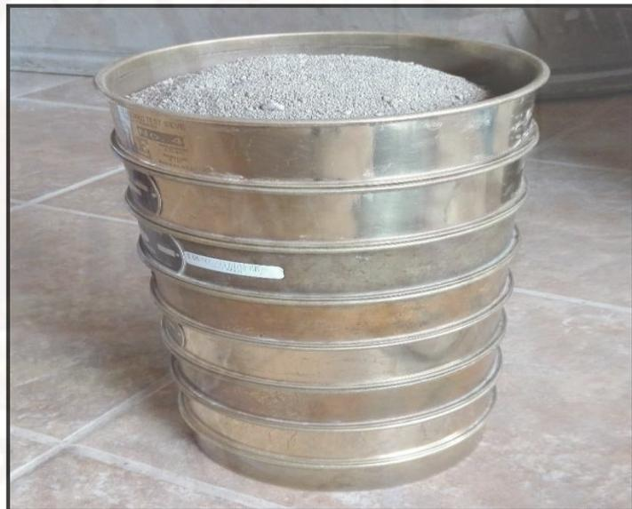
**Fotografía 14.** Armado de las mallas para agregado fino.
