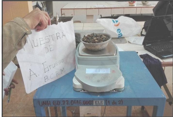
**Fotografía xx.** Pesado del recipiente más muestra de agregado grueso parcialmente seca.
