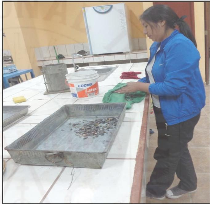
**Fotografía 39.** Secando la superficie de los agregados.
