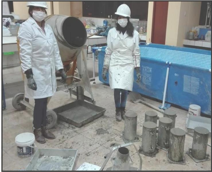
**Fotografía 70.** Culminación de la elaboración de las probetas
