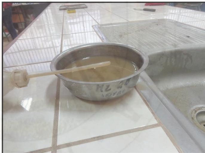
**Fotografía 34.** Extracción de muestra del picnómetro para introducir al horno.
