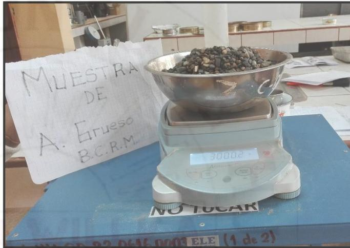
**Fotografía 37.** Peso de la muestra húmeda sin incluir el peso del recipiente.
