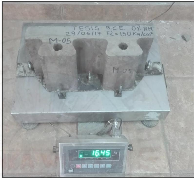
**Fotografía 123.** Peso final de probetas para ensayo de compresión.
