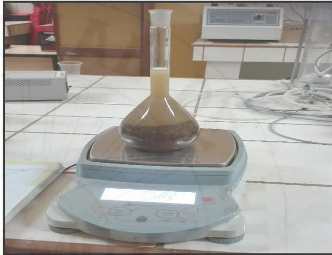
**Fotografía 33.** Peso de la muestra + picnómetro y agua.
