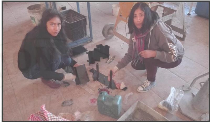
**Fotografía 107.** Cubriendo el molde de petróleo para su armado, para su respectivo armado.
