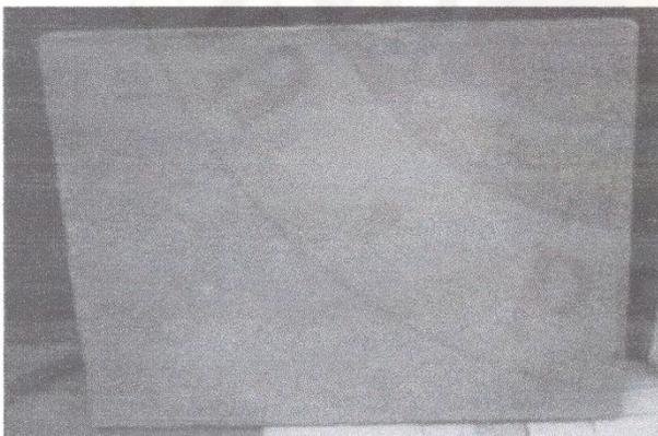
Figura 7. Baldosa artesanal fabricado a partir de relave empleado como agregado de construcción.
