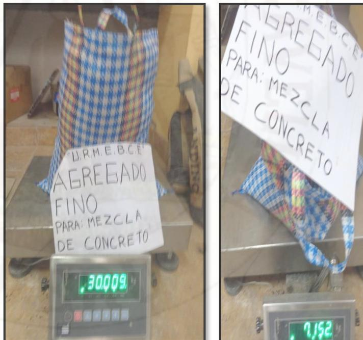
Fotografía 56. Peso del Agregado Fino del tratamiento T1:25RM%.
