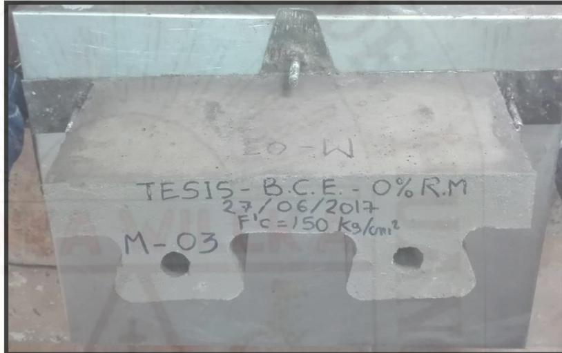
**Fotografía 111.** Rotulado de bloques de concreto ensamblable del T0 0% RM para el ensayo de resistencia a compresión.
