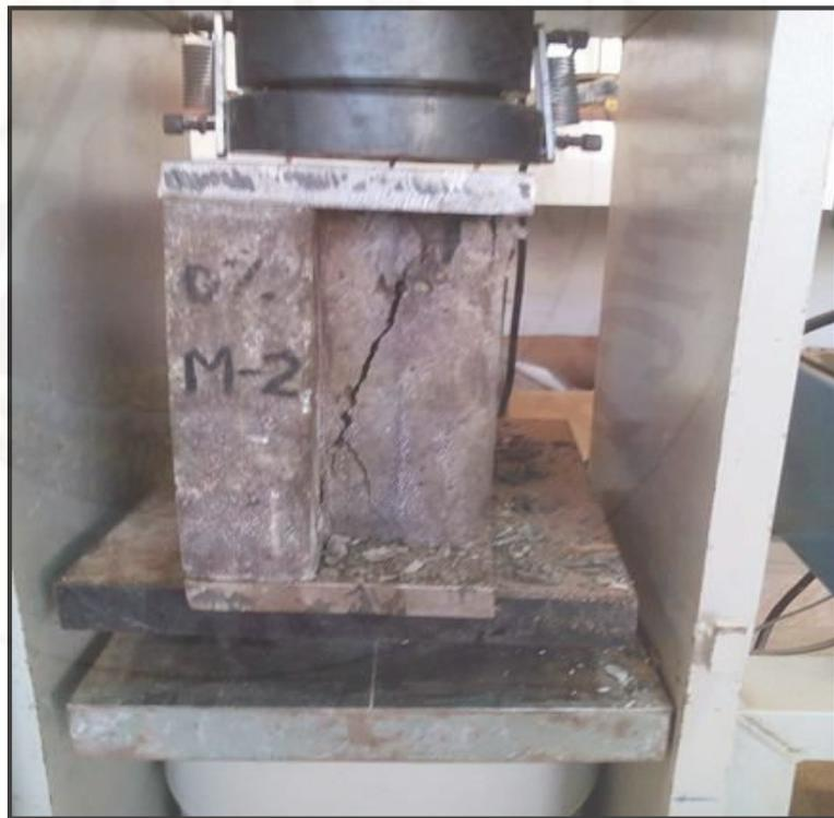
**Fotografía 126.** Falla de probetas sometidas a Ensayo de compresión.
