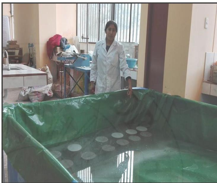
**Fotografía 76.** Curado de probetas cilíndricas en la tina de curado.
