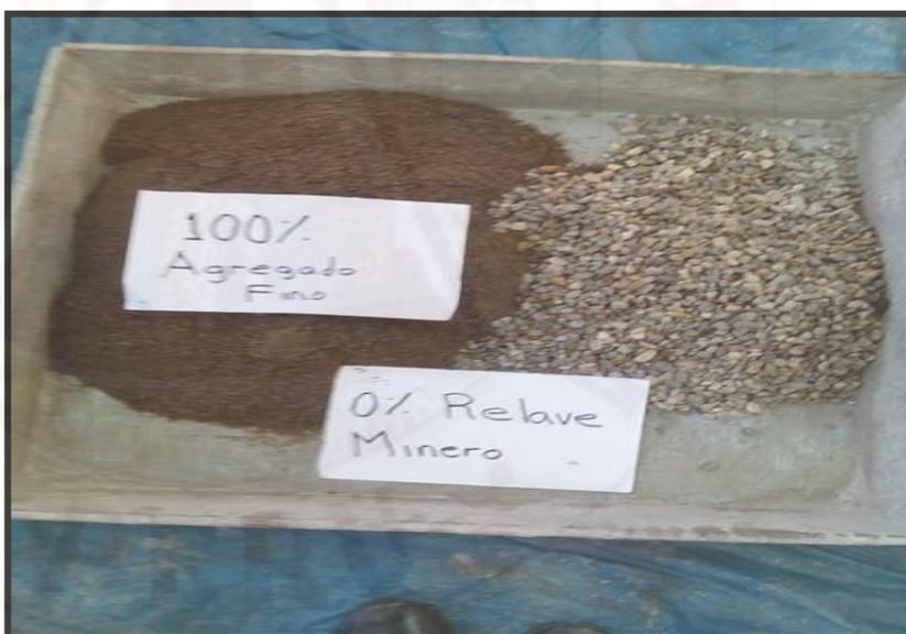
**Fotografía 101.** Disposición de arena gruesa y piedra de 3/8" en la bandeja.
