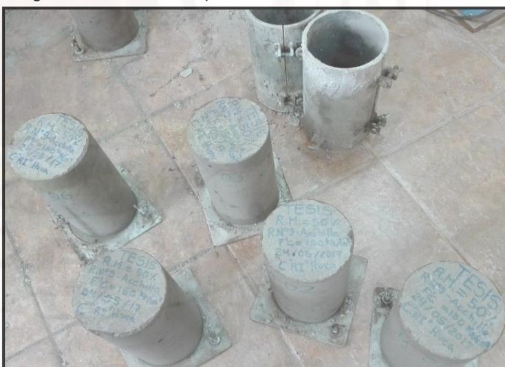
**Fotografía 73.** Rotulado de probetas de T2: 50%RM.
