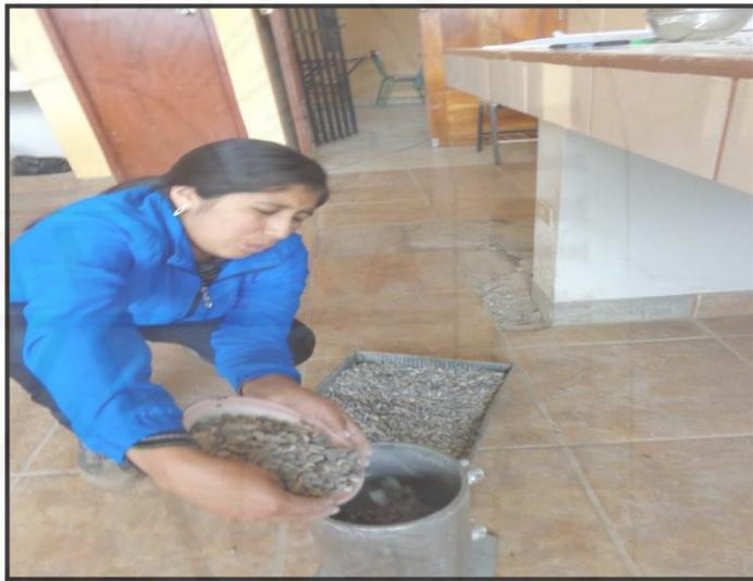
**Fotografía 23.** Introduciendo el agregado grueso para el peso suelto.
