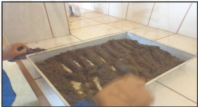
**Fotografía 28.** Desecando la superficie de la muestra.
