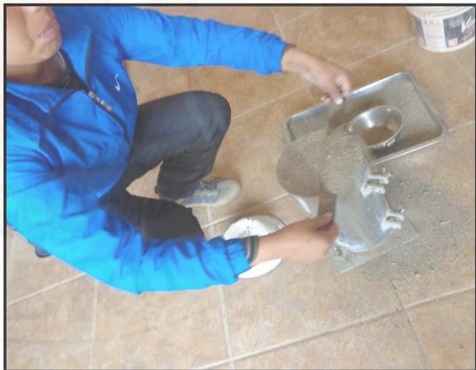
**Fotografía 20.** Enrasando el agregado fino en la superficie del recipiente.
