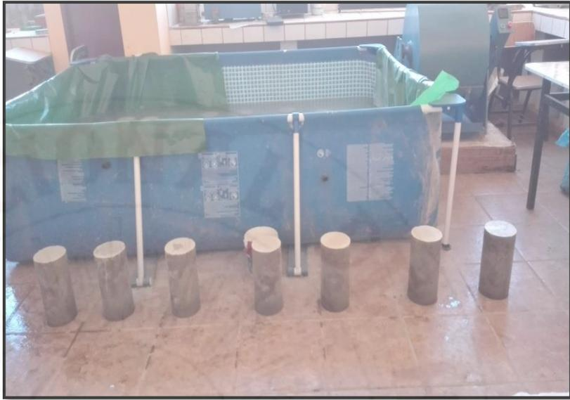
**Fotografía 82.** Extracción de probetas, 24 horas antes del ensayo.
