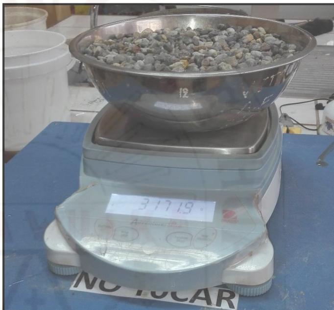
**Fotografía 43.** Peso del agregado grueso seco.
