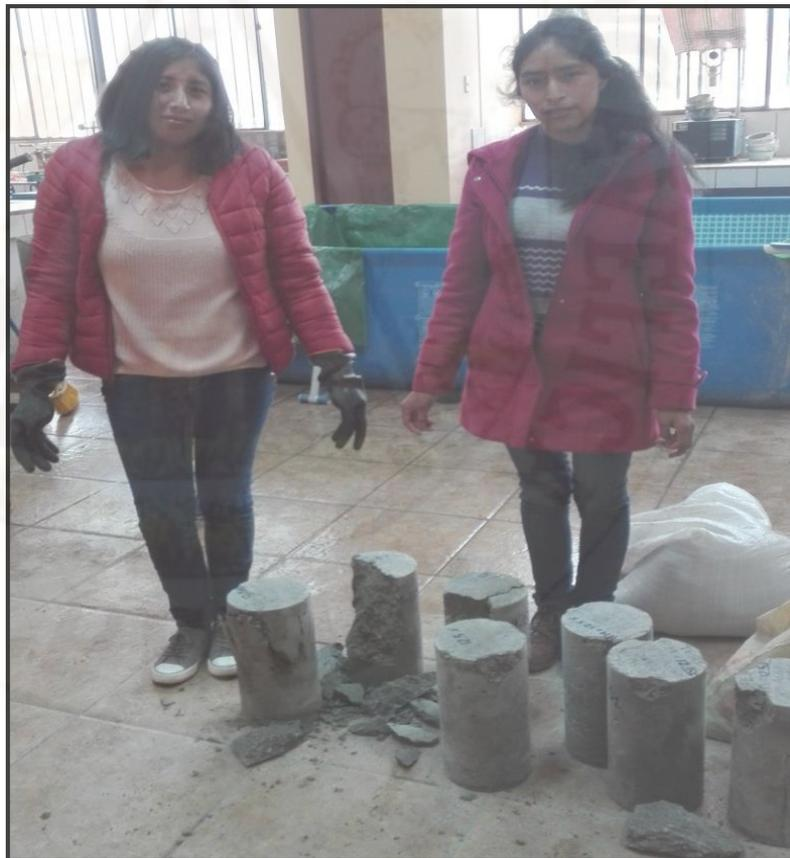
**Fotografía 92.** Probetas sometidas al ensayo de resistencia a compresión.
