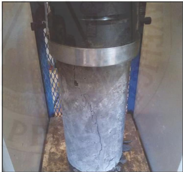
**Fotografía 90.** Falla cortante de probetas.
