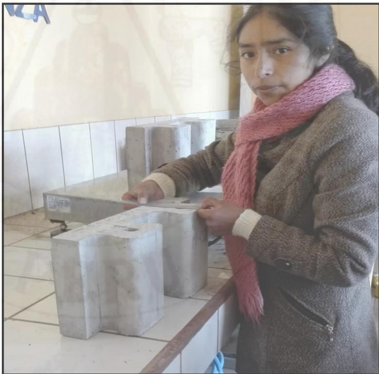
**Fotografía 122.** Medida del BCE para ensayo de compresión.
