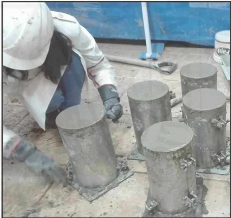
**Fotografía 69.** Llenado y compactado del molde en tres capas.
