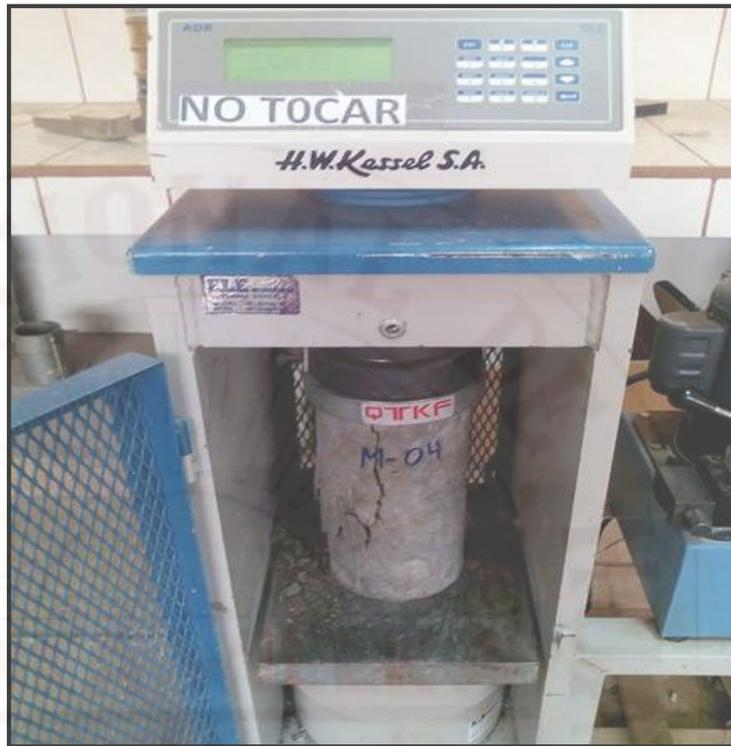
**Fotografía 88.** Falla de probetas sometidas a Ensayo de compresión.
