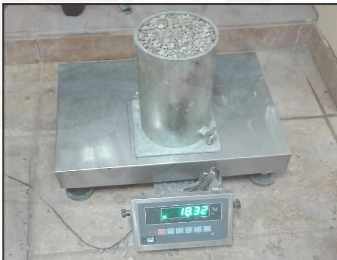
**Fotografía 26.** Peso compactado del agregado grueso.
