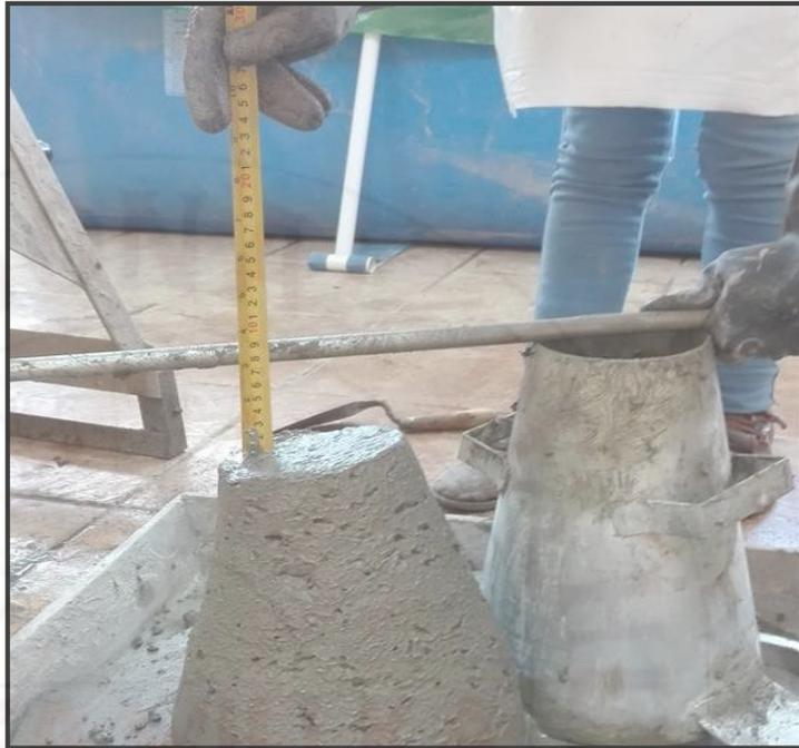
**Fotografía 67.** Asentamiento adecuado para un slump de 3".
