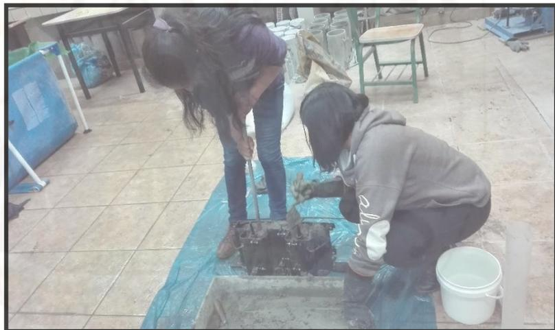
**Fotografía 108.** Moldeado del bloque en la 3 capa, con su respectivo chuseado.
