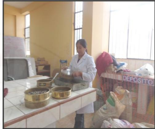
**Fotografía A 6.** Tamizado del agregado grueso (piedra de 3/8) en el Laboratorio de Ensayo de Materiales y Concreto de la Escuela Profesional de Ingeniería Civil – Huancavelica.
