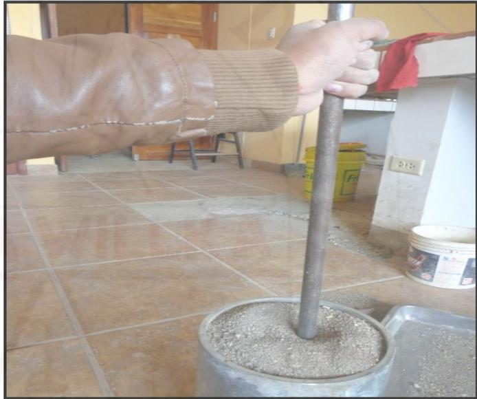
**Fotografía 21.** Compactando el agregado fino.
