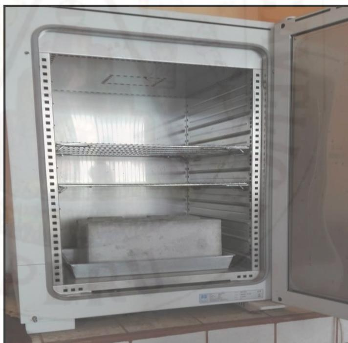
**Fotografía 138.** Secado de BCE en el horno por 24 horas.
