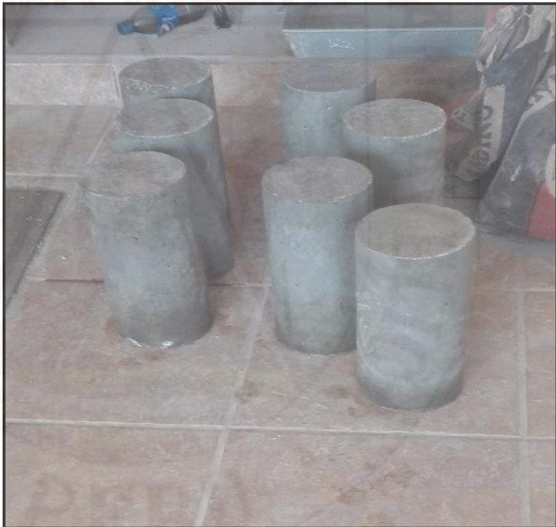
**Fotografía 83.** Probetas para ensayo de compresión.
