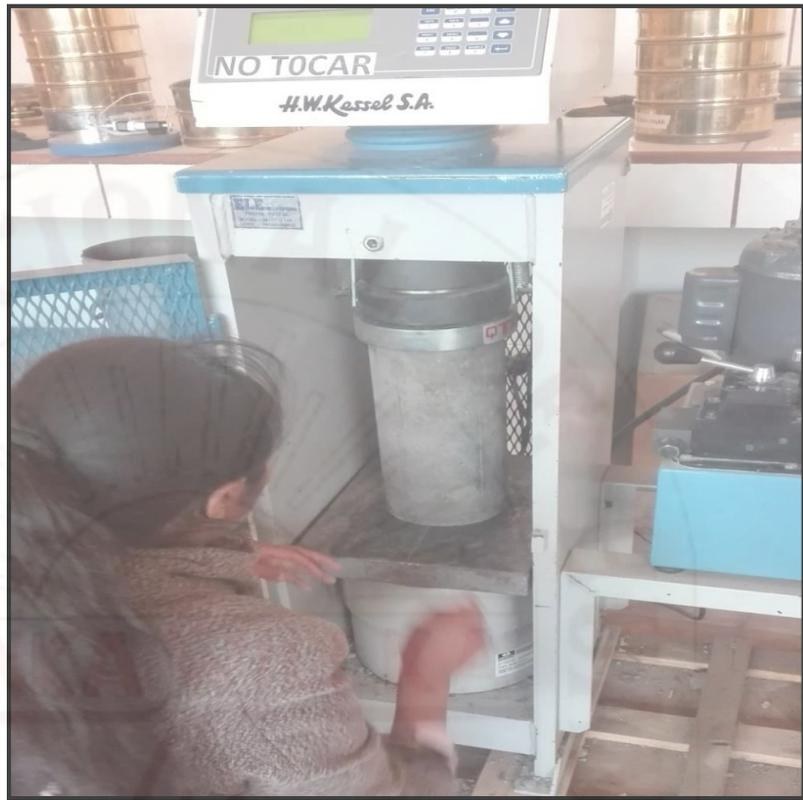
**Fotografía 86.** Colocado de muestra para ensayo de resistencia a compresión.
