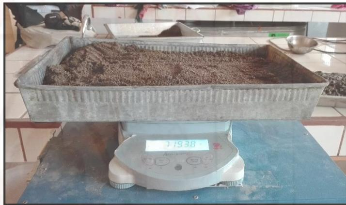
**Fotografía 9.** Resultados del Contenido de Humedad del agregado grueso.
