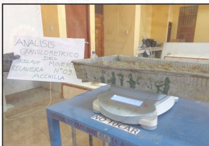
**Fotografía 48.** Pesado de la muestra seca para la granulometría.
