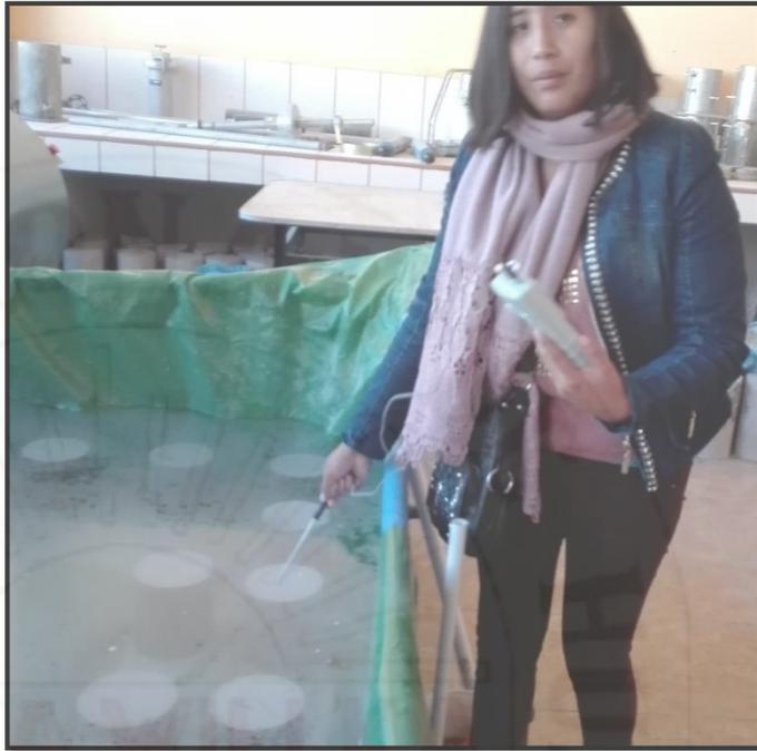
**Fotografía 77.** Control de temperatura inicial del agua de curado.
