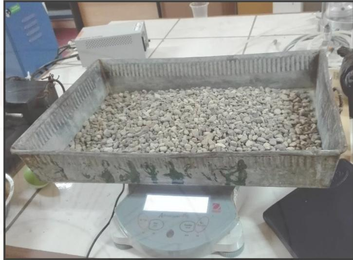
**Fotografía 13.** Peso seco del agregado grueso.
