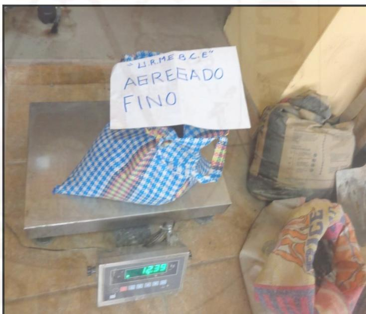
**Fotografía 60.** Peso del Agregado Fino del tratamiento T3:75%RM.
