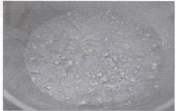
**Figura 2.** Mezcla seca del agregado.
