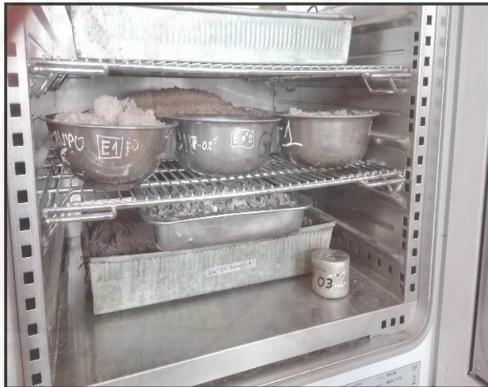
**Fotografía 7.** Agregado fino y grueso introducidas en el horno.
