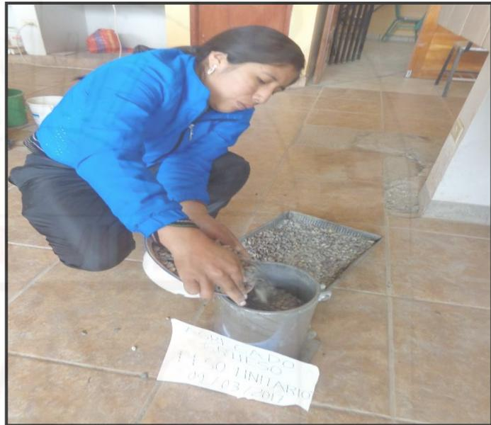
**Fotografía 25.** Introduciendo el agregado grueso en forma helicoidal al recipiente.
