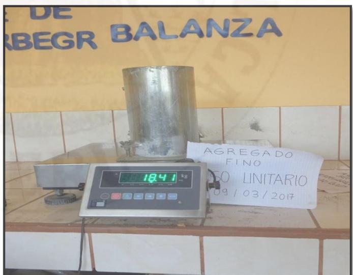
**Fotografía 22.** Peso compactado del agregado fino.
