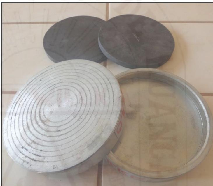
**Fotografía 81.** Almohadillas y anillos de retención para ensayo.
