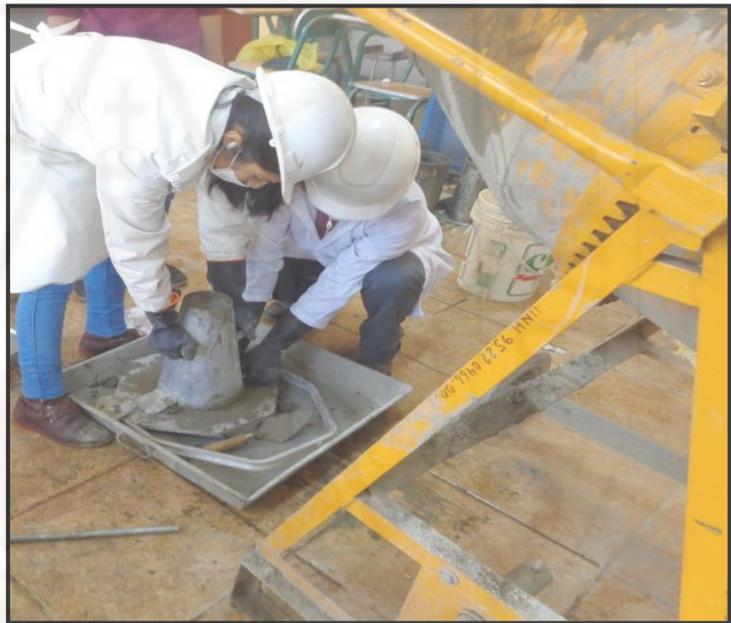
**Fotografía 66.** Ensayo con el Cono de Abrams según Norma.
