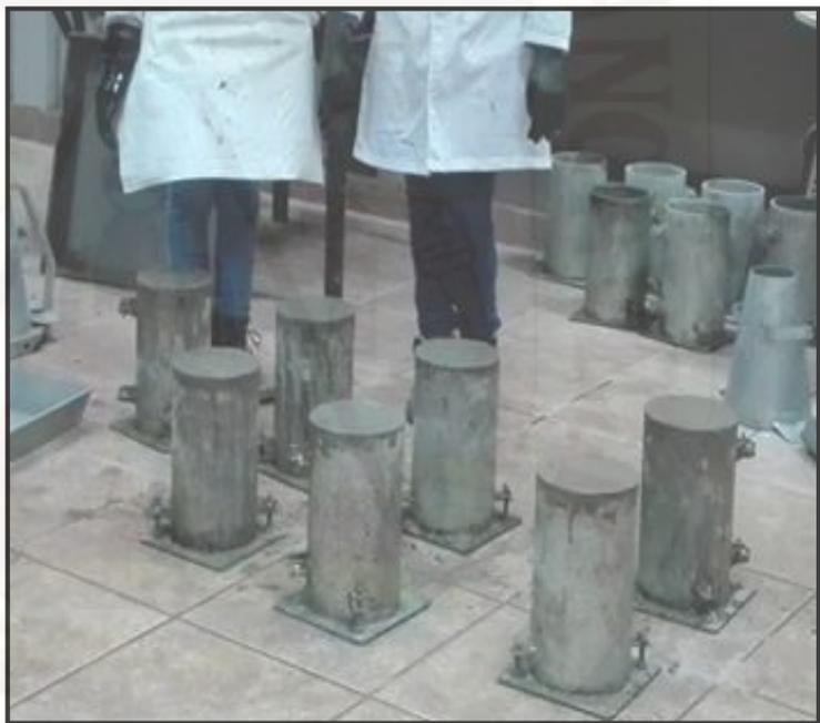
**Fotografía 71.** Colocado de Probetas en una superficie plana.
