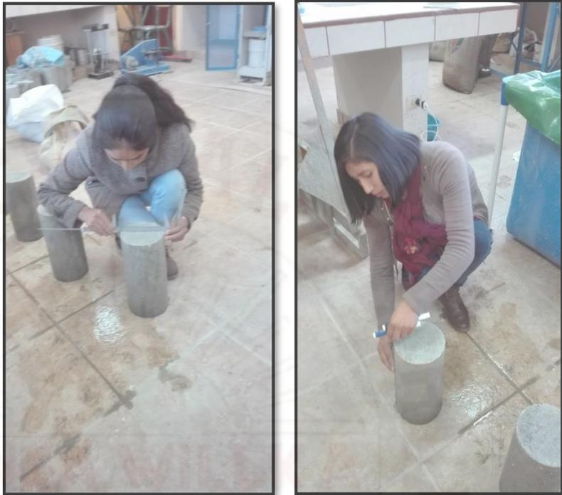
**Fotografía 84.** Medida de probetas para ensayo de compresión.
