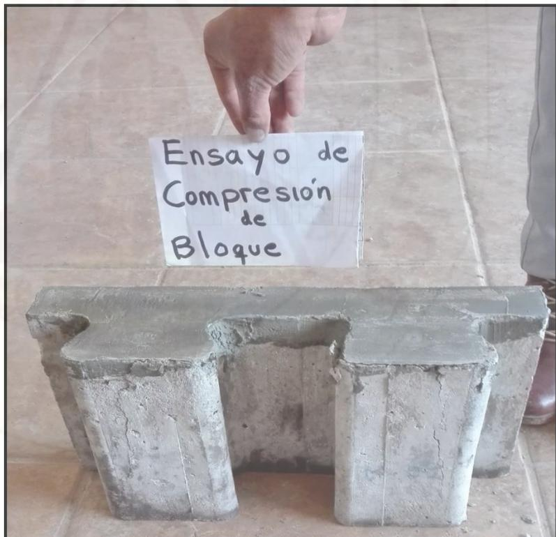
**Fotografía 130.** BCE sometida al ensayo de resistencia a compresión.
