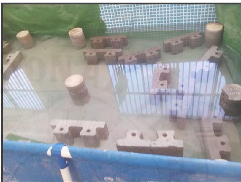
**Fotografía 114.** Curado de bloques de concreto en la tina de curado.
