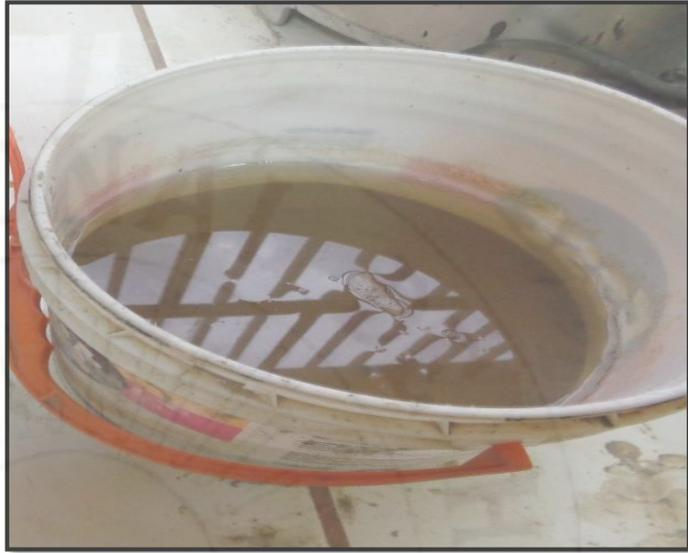
**Fotografía 27.** Agregado fino sumergido en agua.
