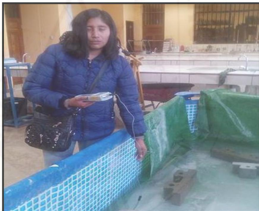
**Fotografía 115.** Control de temperatura del curado de bloques de concreto ensamblable.
