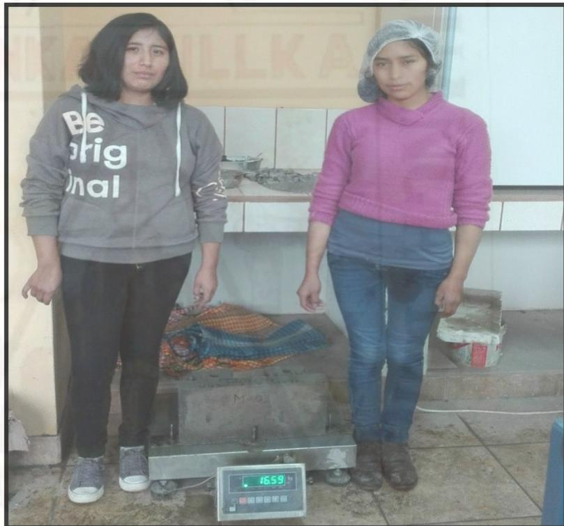
**Fotografía 113.** Pesado inicial del bloque de concreto ensamblable.
