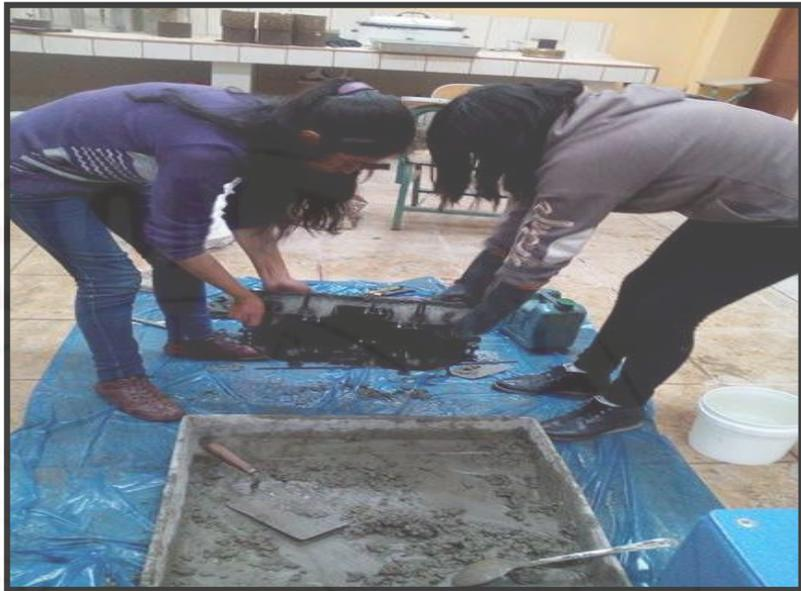
**Fotografía 109.** Vibrado manual del bloque.
