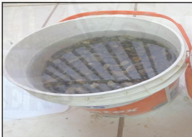
**Fotografía 38.** Agregado grueso sumergido en agua.
