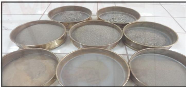
**Fotografía 16.** Peso retenido del agregado fino en cada malla.
