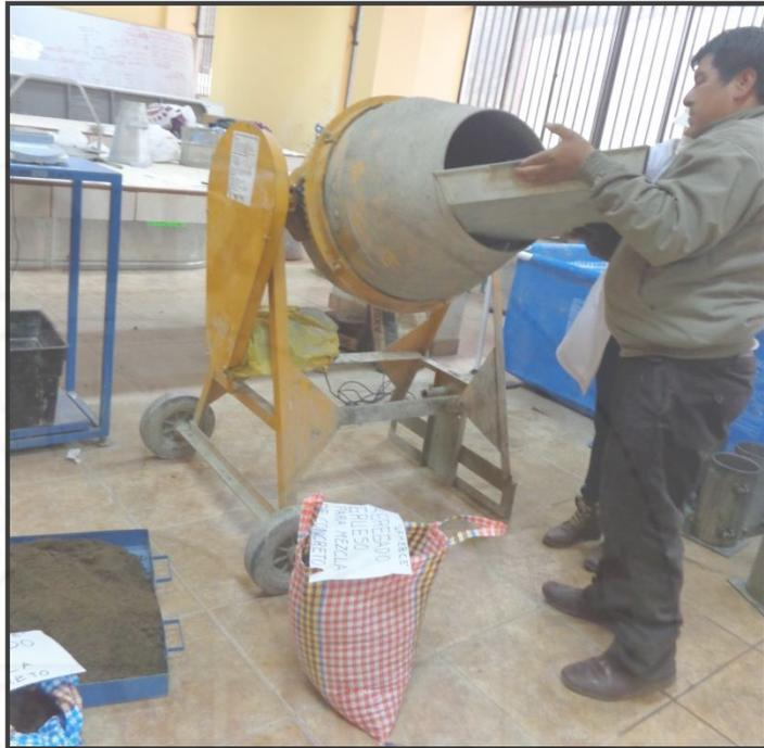
**Fotografía 63.** Pre mezcla de Cemento, Relave Minero y agregados.
