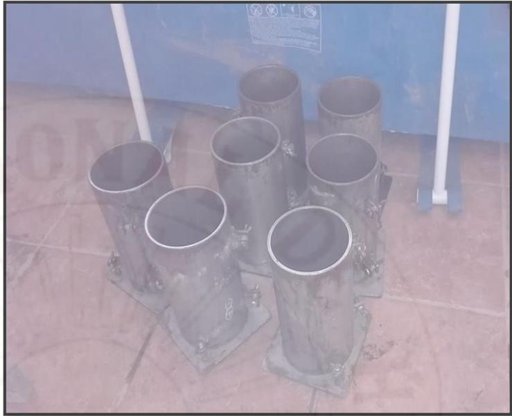
**Fotografía 68.** Habilitación de moldes para las probetas.
