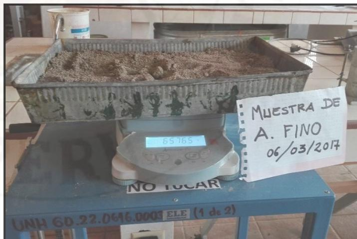
**Fotografía 12.** Peso seco del agregado fino.
