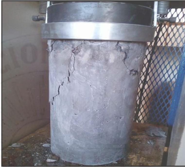
**Fotografía 91.** Falla cónica y cortante de probetas.
