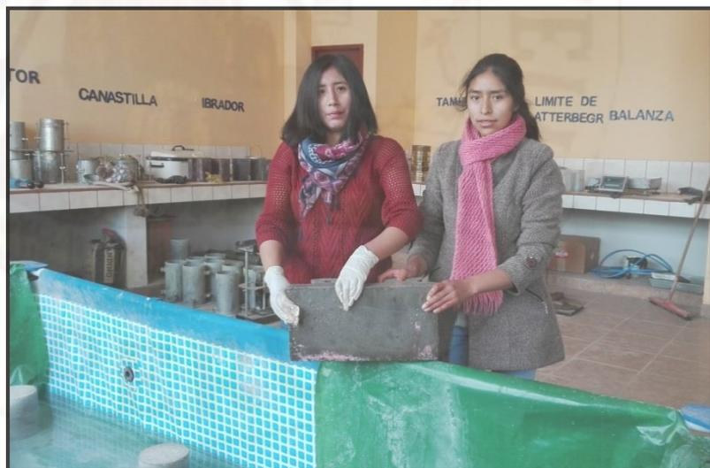
**Fotografía 120.** Extracción de la tina de curado del BCE, 24 horas antes del ensayo.
