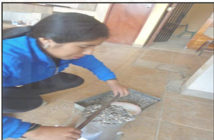
**Fotografía 24.** Enrasando el agregado grueso en la superficie del recipiente.
