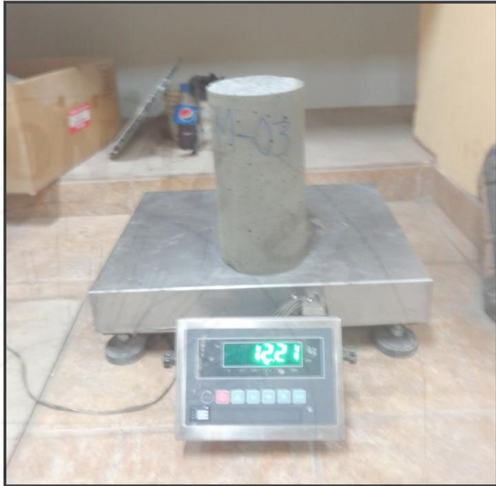
**Fotografía 74.** Peso Inicial de probetas antes de ser sumergidas.
