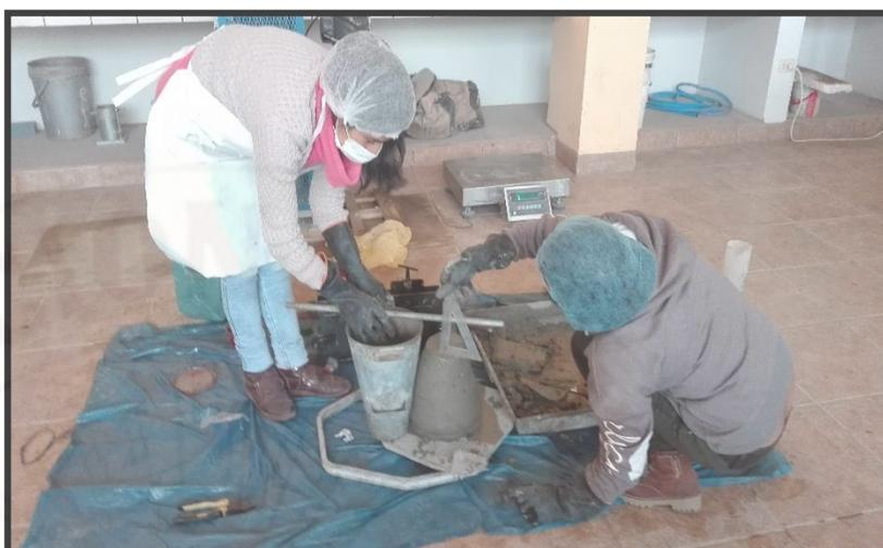
**Fotografía 106.** Ensayo de cono de Abrams para el T2 50% RM.
