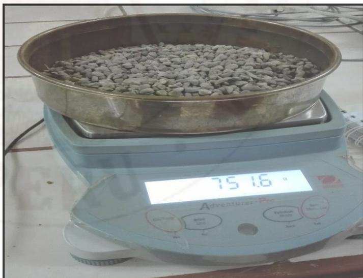
**Fotografía 17.** Peso retenido del agregado grueso.
