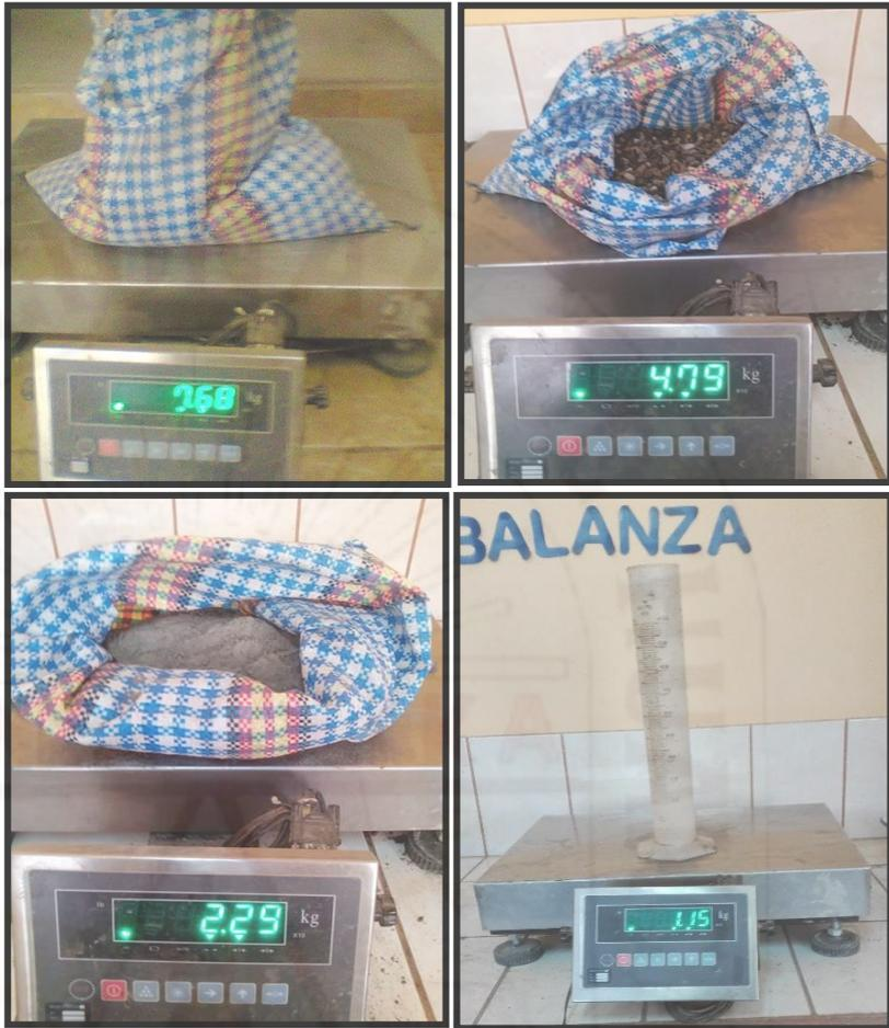
**Fotografía 99.** Pesos de arena gruesa, piedra de 3/8", cemento y agua para el T0 0% RM.
