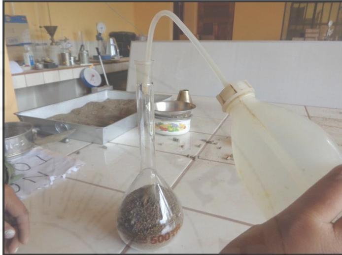
**Fotografía 31.** Introduciendo la muestra y agua al picnómetro.
