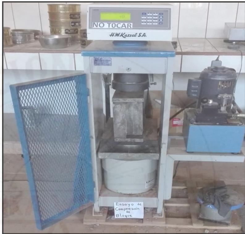
**Fotografía 125.** Ensayo de resistencia a compresión de BCE.
