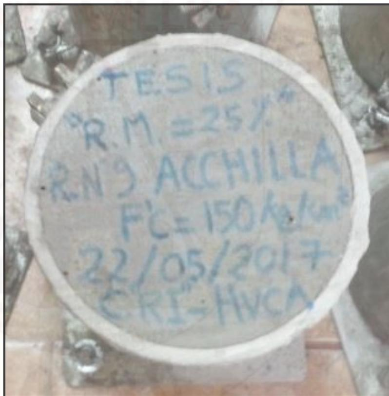
**Fotografía 79.** Nomenclatura de las probetas.
