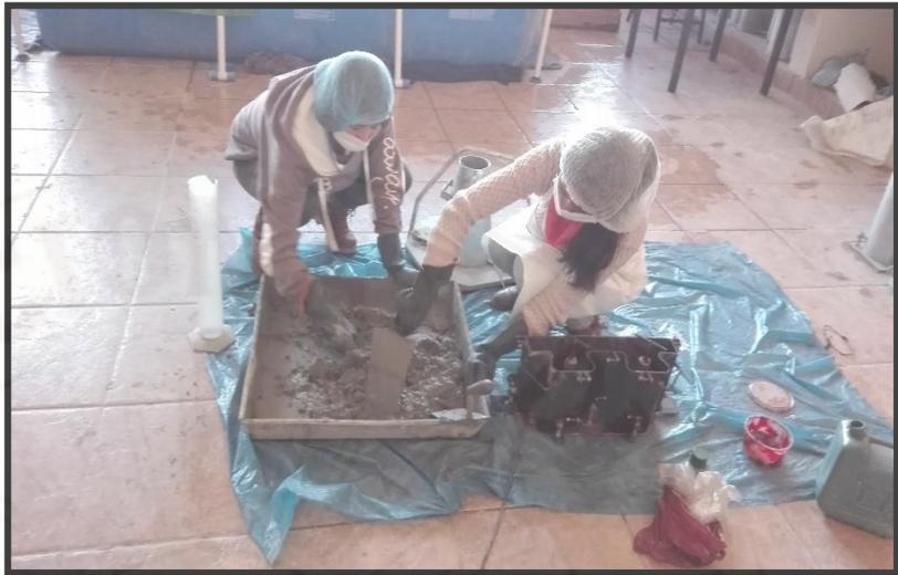
**Fotografía 104.** Mezcla del concreto para el T2 50% RM.
