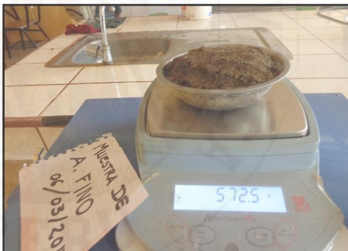
**Fotografía 6.** Peso del recipiente más muestra de agregado fino parcialmente seca.
