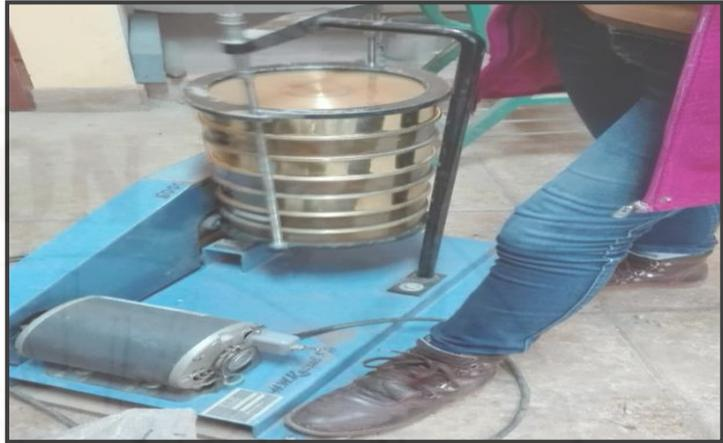
**Fotografía 15.** Vibrado en la tamizadora del agregado grueso.
