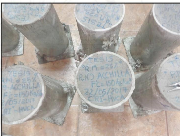
**Fotografía 72.** Rotulado de probetas de T1: 25%RM.
