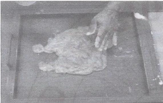
Figura 5. Molde de baldosa con vertido de la mezcla homogénea húmeda.
