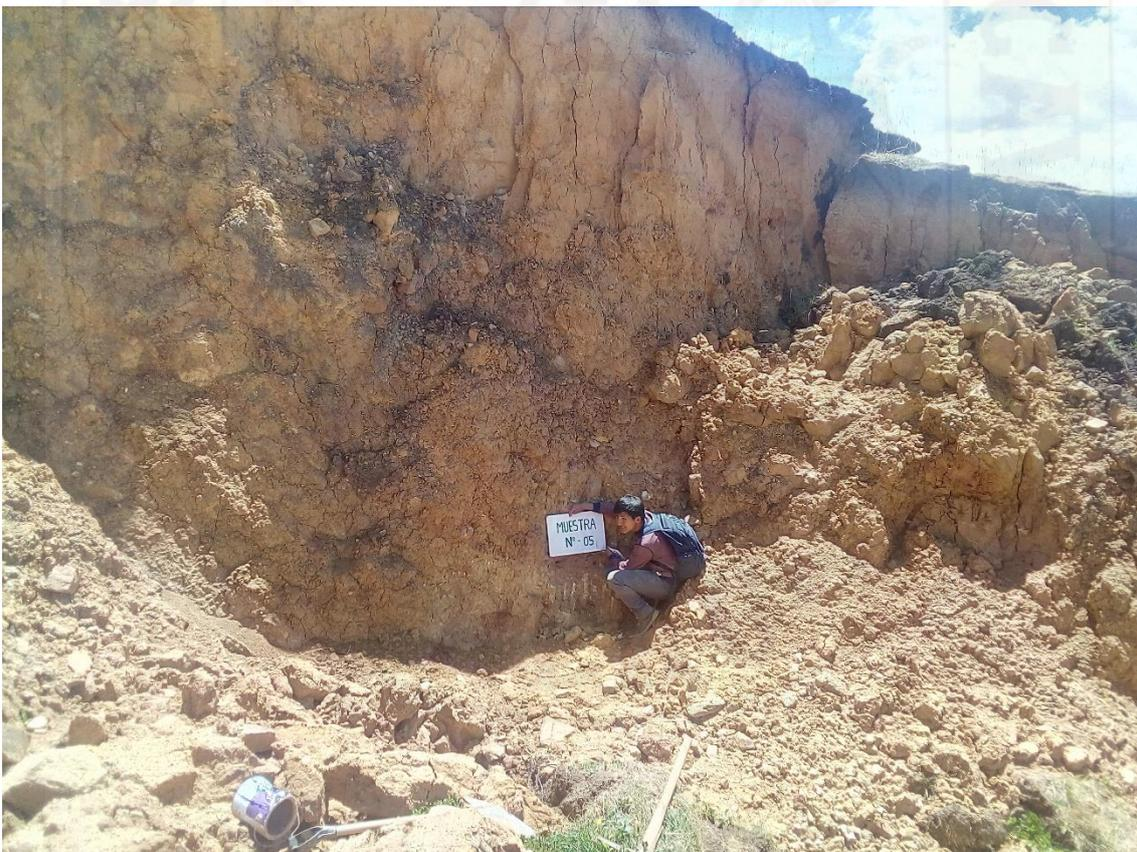
*Figura 52: Trinchera número cinco, zona donde se extrajo muestras de suelo para ensayos triaxiales.*
