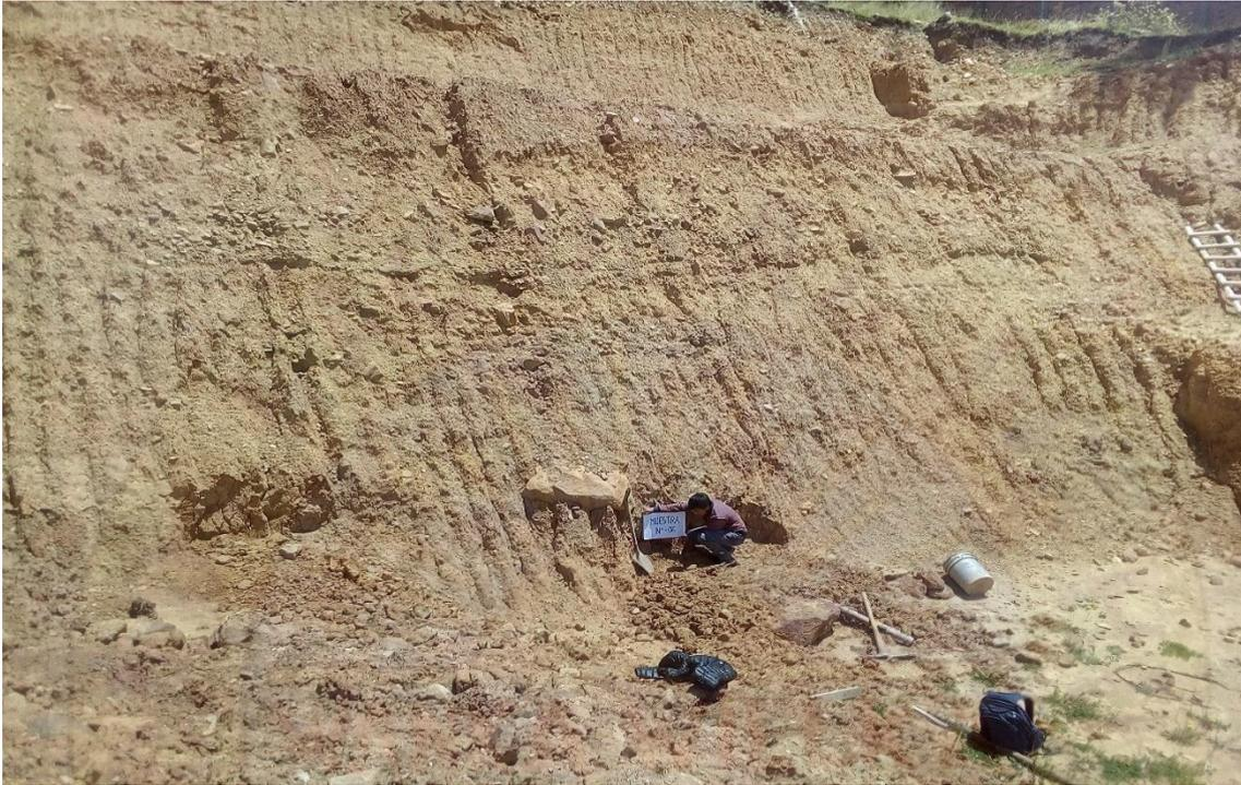
Figura 53: Trinchera número seis, zona donde se extrajo muestras de suelo para ensayos triaxiales.
