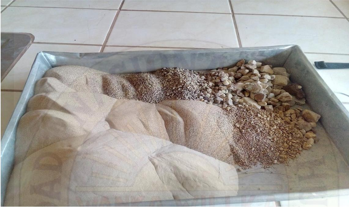
Figura 57: Muestra de suelo después de ser lavado, y realizado su análisis granulométrico.
