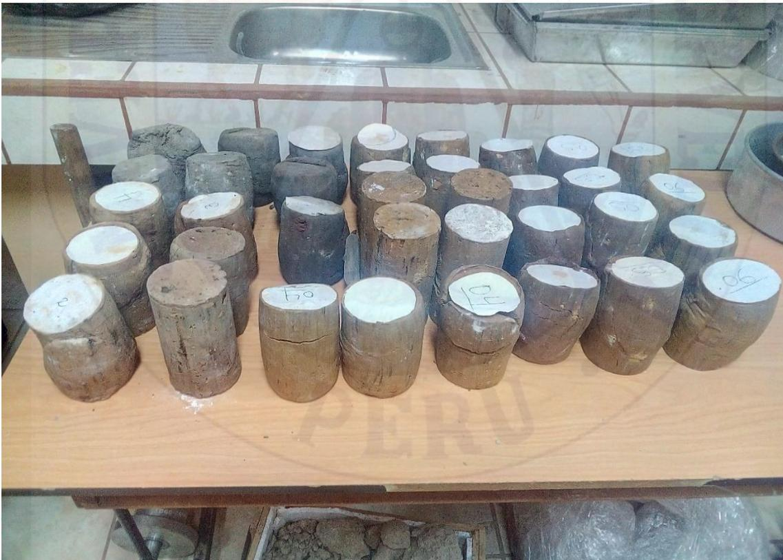
Figura 68: Conjunto de muestras después de haber realizado los ensayos triaxiales (UU)
