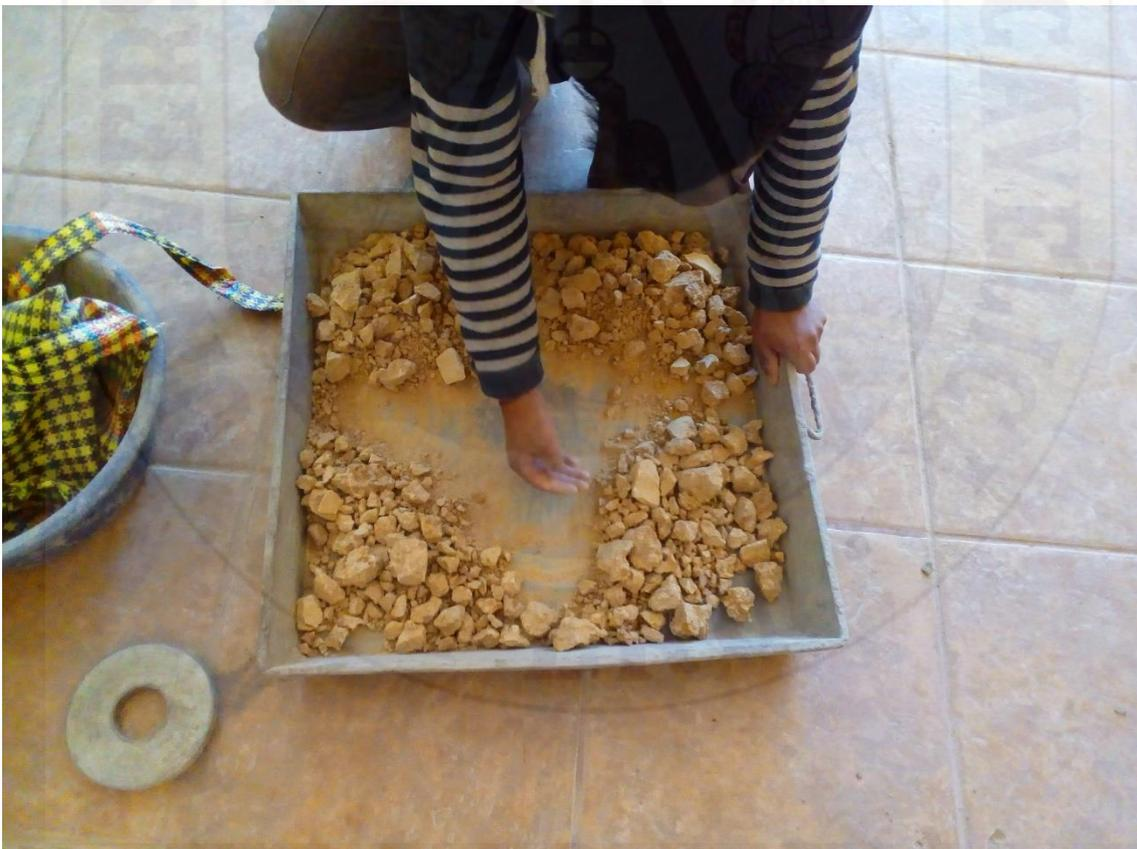
Figura 56: Cuarteo de muestra de suelo para realizar ensayo de análisis granulométrico.
