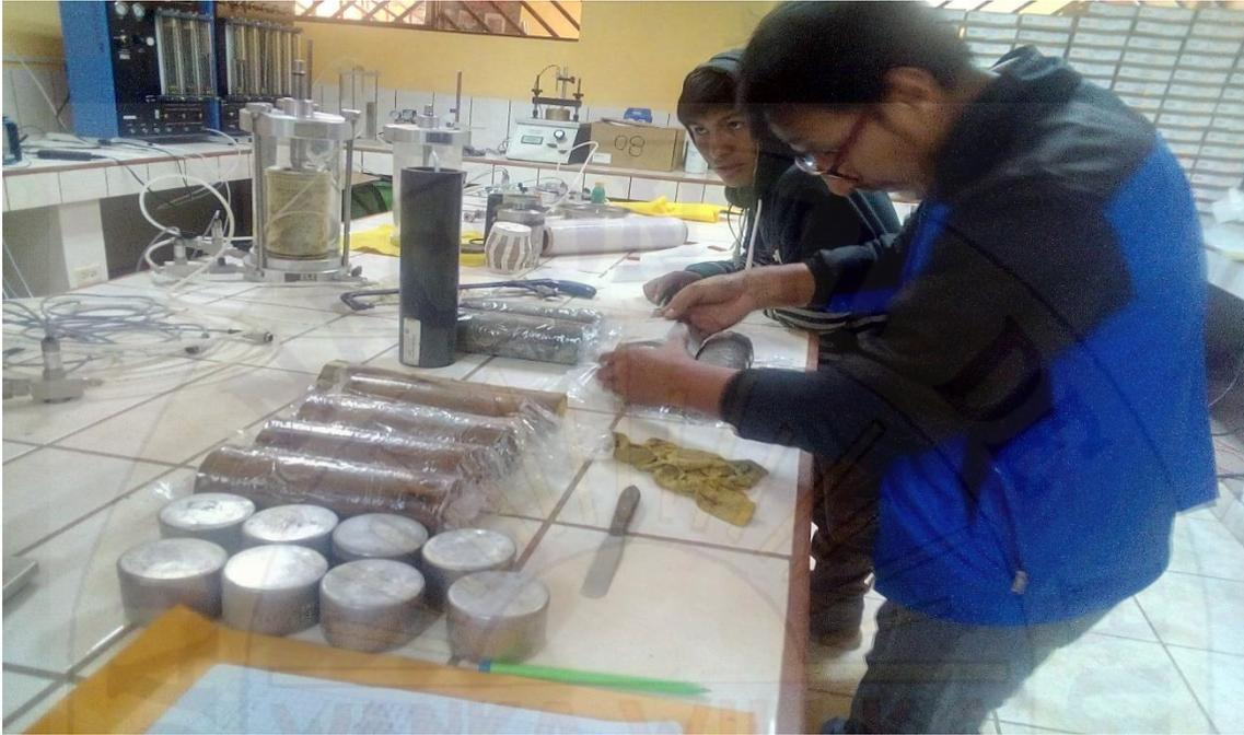
Figura 63: Laboratorio de geotecnia 2, preparación de muestras de suelo inalterados para ensayo triaxial.
