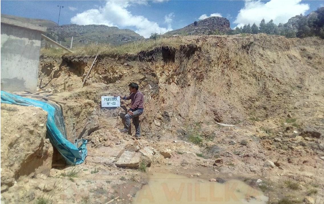
Figura 49: Trinchera número dos, zona donde se extrajo muestras de suelo para ensayos triaxiales.
