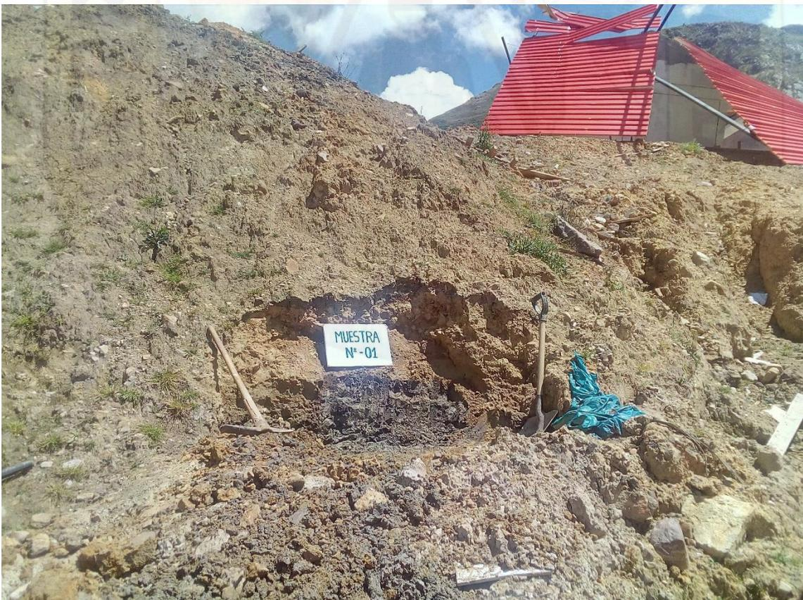
Figura 48: Trinchera número uno, zona donde se extrajo muestras de suelo para ensayos triaxiales.
