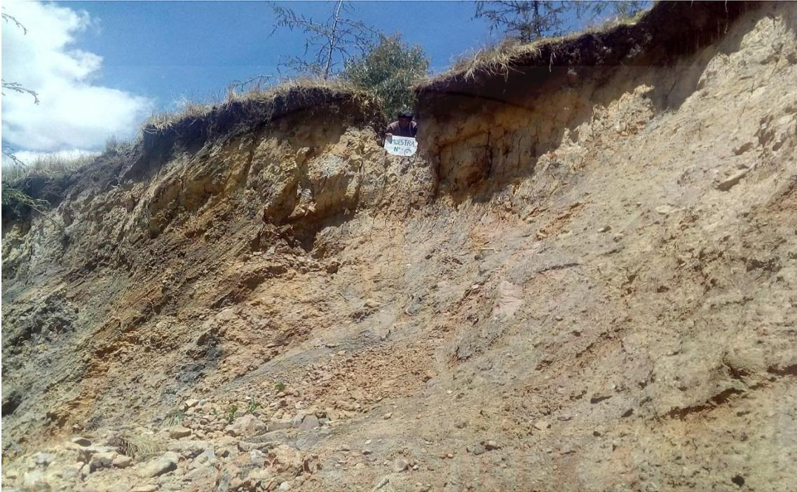
*Figura 51: Trinchera número cuatro, zona donde se extrajo muestras de suelo para ensayos triaxiales.*
