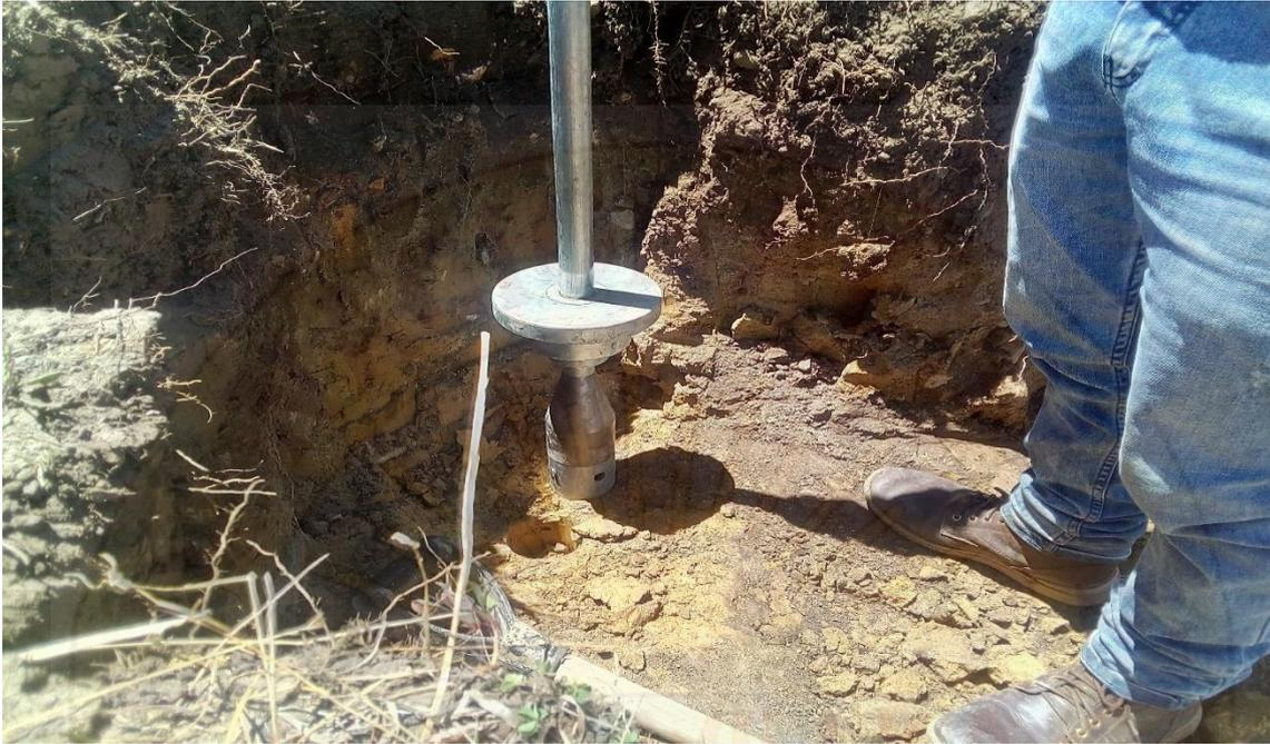
Figura 61: Extracción de muestra de suelo inalterado para ensayo triaxial no consolidado no drenado.
