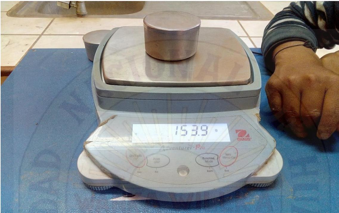
Figura 55: Pesado de muestra de suelo para obtención de contenido de humedad.
