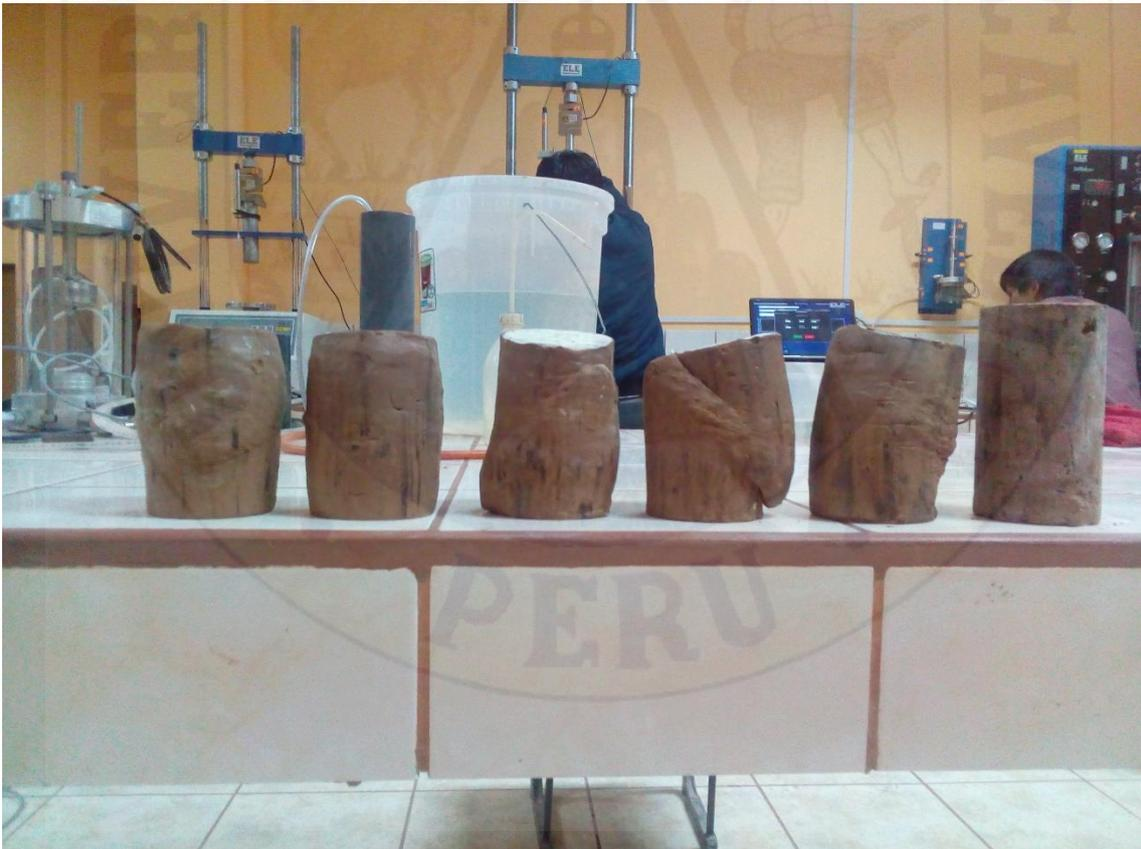
Figura 66: Muestras de suelos después de haber sido ensayados para la obtención de parámetros mecánicos del suelo de la trinchera 2.
