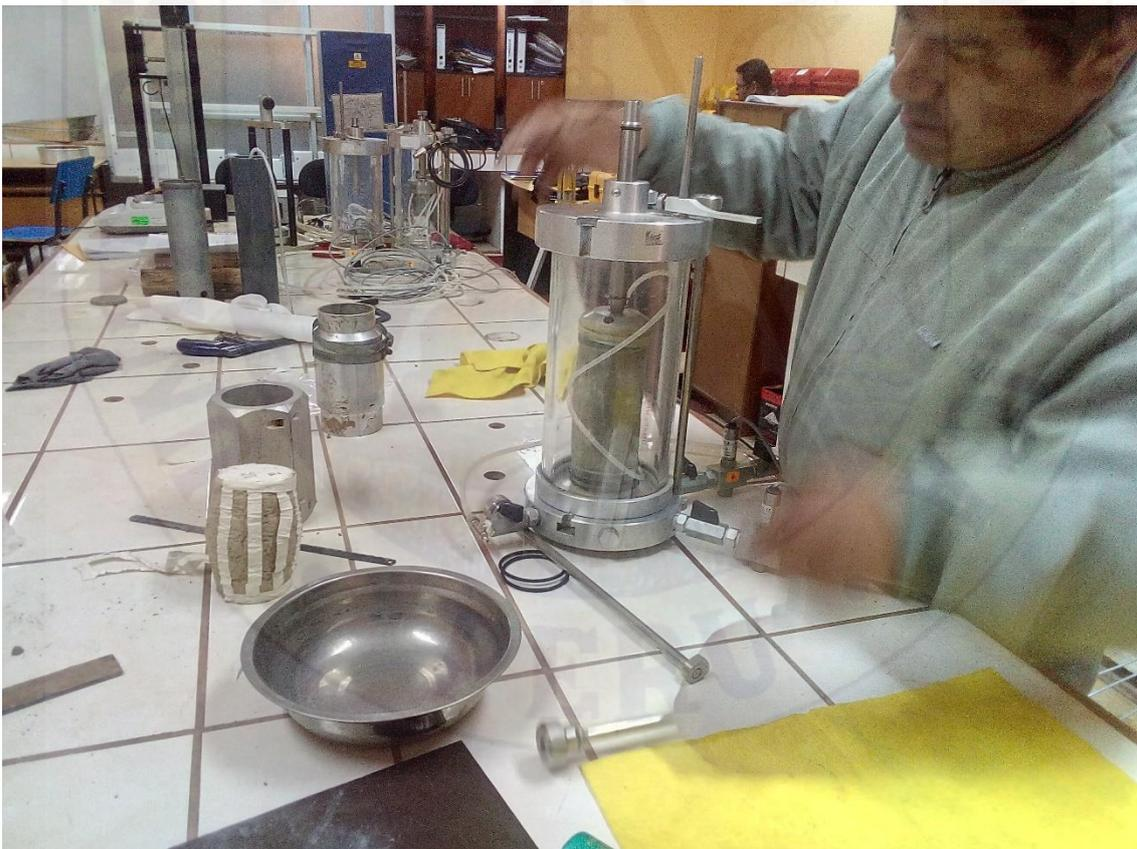
Figura 64: Colocación de la muestra de suelo inalterado en la celda triaxial.
