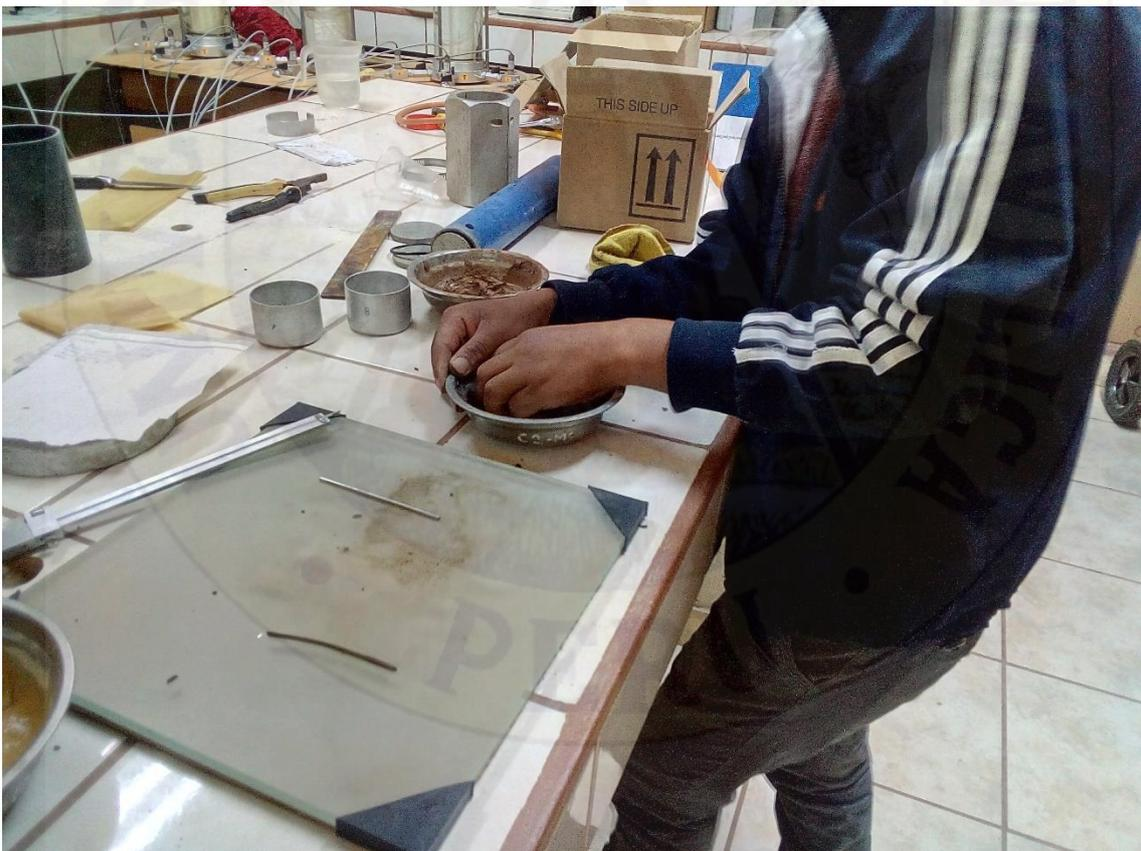
Figura 60: Ensayo de limite plástico de una de las muestras de suelo.
