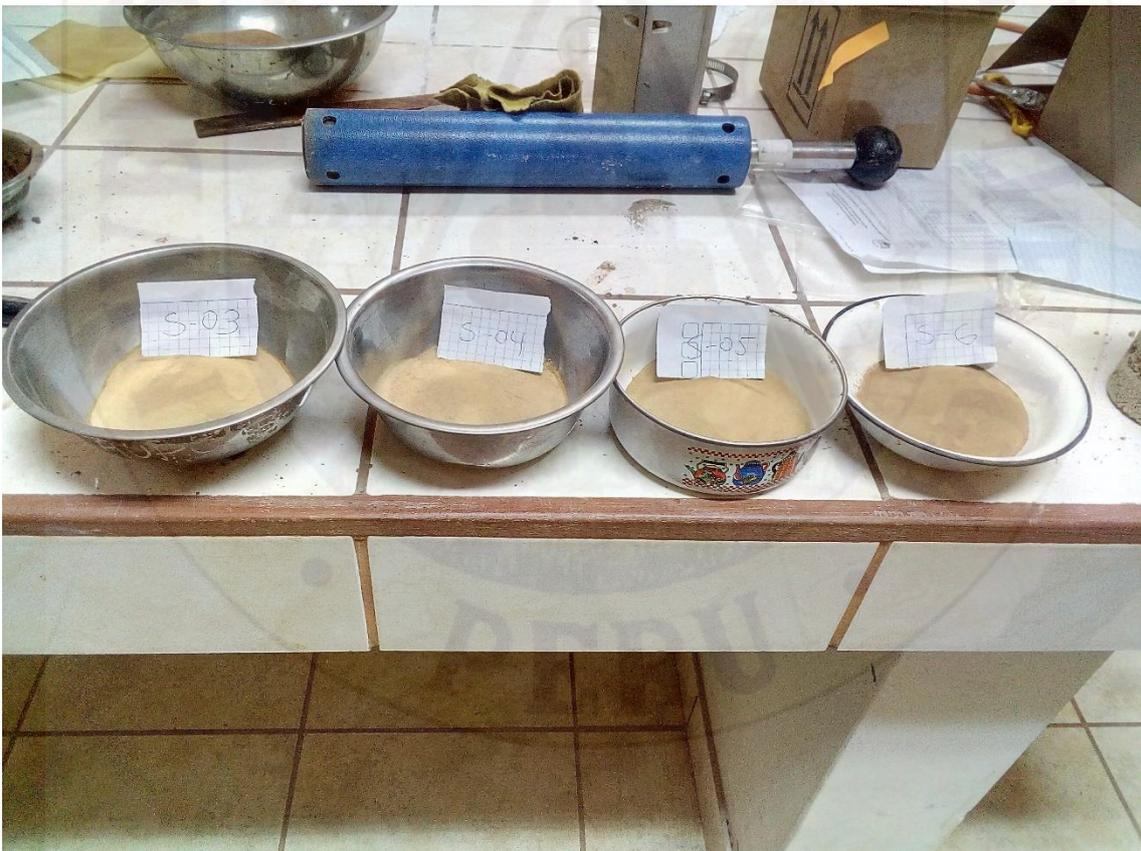
Figura 58: Muestras de suelo de las diferentes trincheras y que pasaron completamente por el tamiz de 0,5 mm. (malla N° 40 ASTM).
