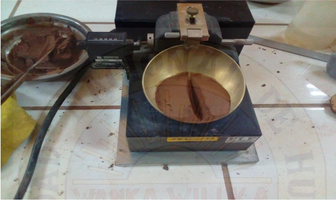
Figura 59: Ensayo de limite líquido de una de las muestras de suelo.
