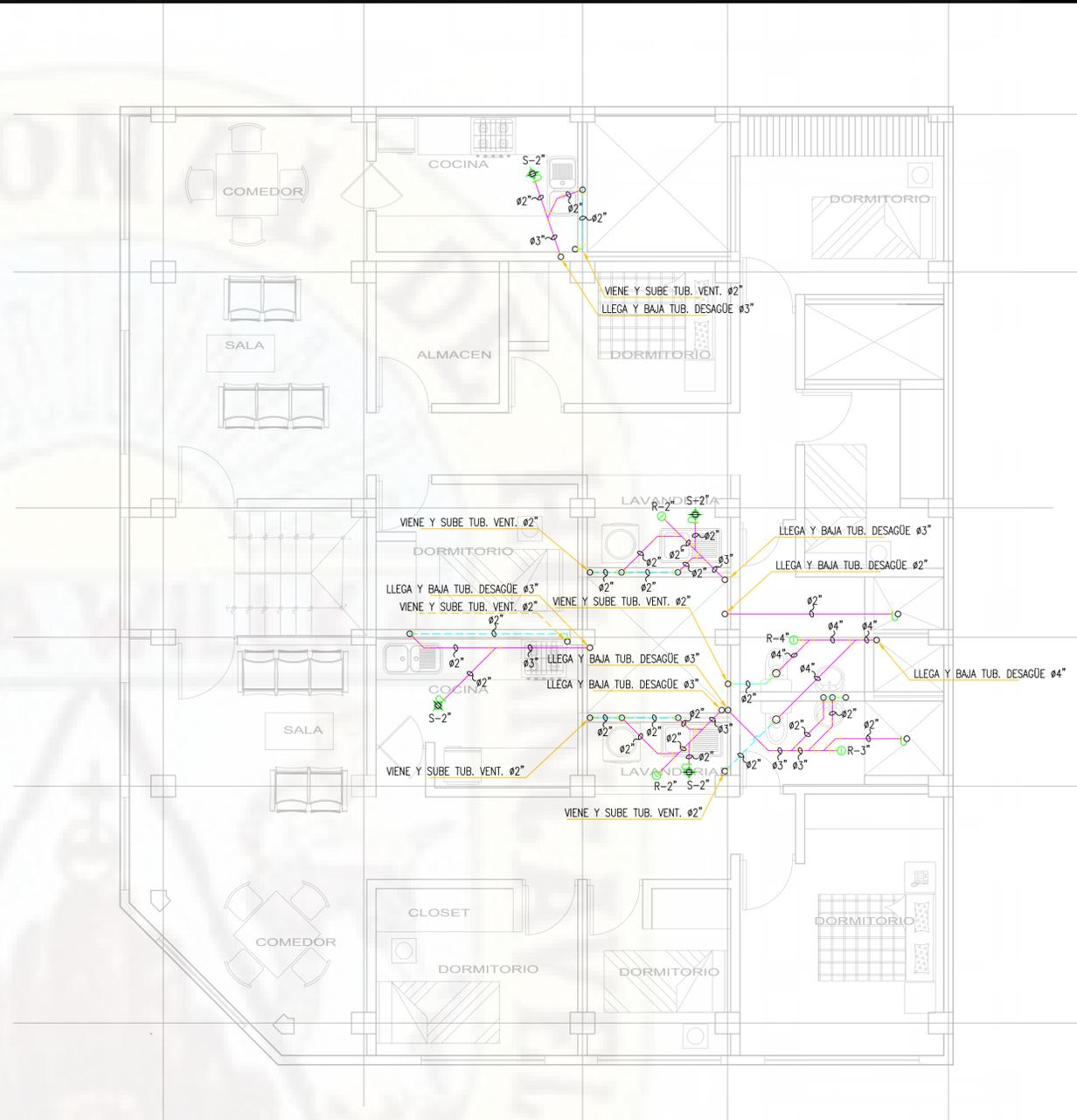
SEGUNDO PISO – RED DE DESAGÜE Y VENTILACIÓN
