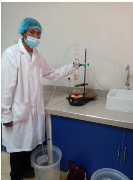
*Fotografía 3. Proceso de extracción de aceite por el método Soxhlet.*
