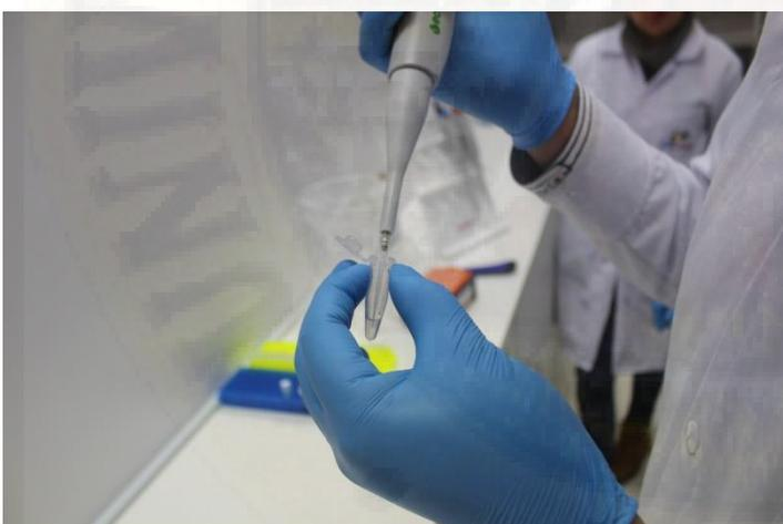
**Foto 186.** Muestra de alpaca, desparafinado y extraído el ADN, pipetear 5µl de muestra
