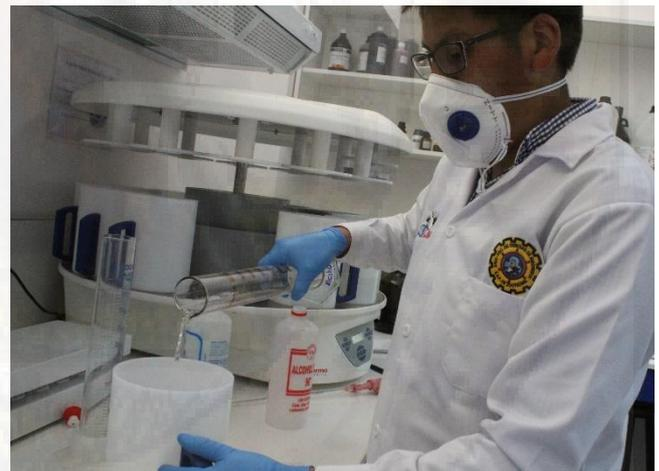
Foto 21. Llenado de los reactivos en las jarras del equipo MICRON STP - 120
