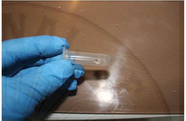
**Foto 45.** Rodajas de TEP en el fondo de un tubo ependorf de 1.5 ml
