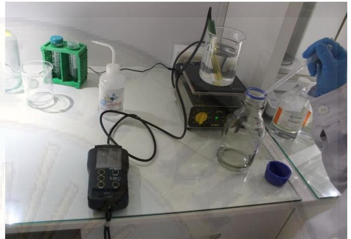
**Foto 165.** Con un PH metro, alcanzar el PH de 8, rebajar con ácido clorhídrico para estandarizar al valor deseado.
