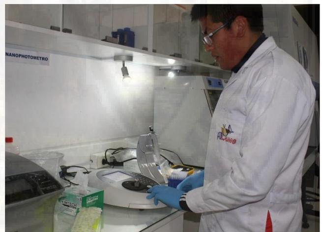
Foto 91. Encender el nanofotometro P-330, pulsando la tecla ON y programar para realizar los análisis de concentración y pureza de las muestras
