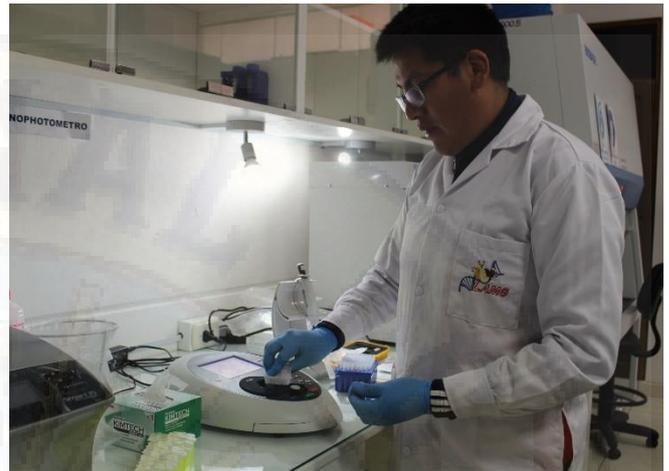
**Foto 99.** Retirar la tapa LID 10 y utilizar el kleenex para limpiar el interior de la tapa y la parte superior de la ventana de medición
