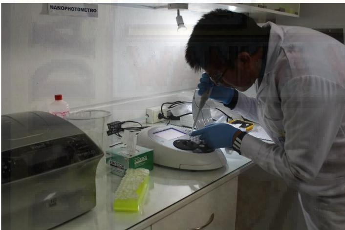
**Foto 94.** Verter lo pipeteado sobre el centro de la ventana de medición
