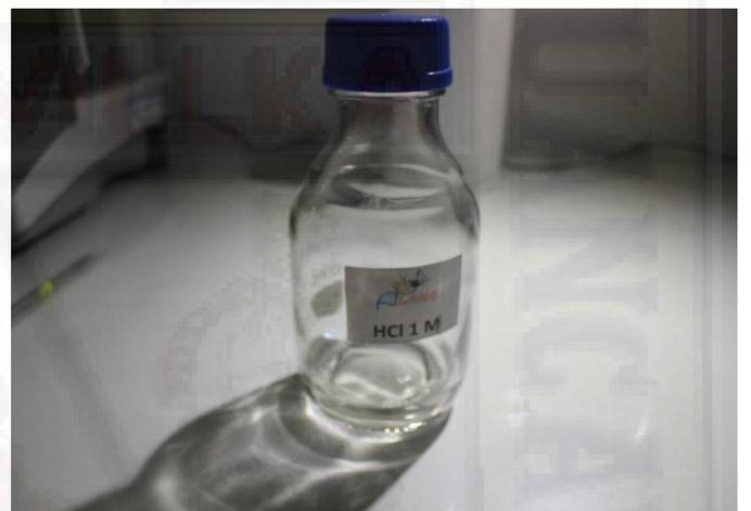
**Foto 167.** Ácido clorhídrico (HCL), utilizado para rebajar el alcalino, hasta llegar al PH=8.
