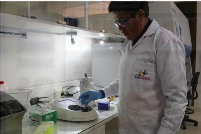
**Foto 100.** Para analizar una muestra, se tiene que realizar un Vortex (incluido en el Nanofotometro) para expandir el ADN sedimentado en la base del tubo eppendorf
