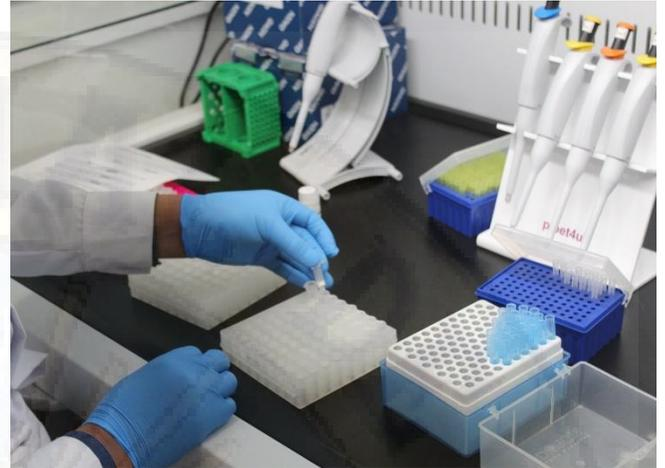
**Foto 79.** Transferir la columna de centrifugación en los nuevos tubos eppendorf de 2 ml.
