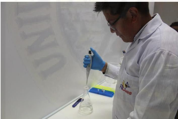
Foto 174. Agregar 10  $\mu$ L de GELRED al matraz con agarosa y TBE 0.5X y dejar entibiar.
