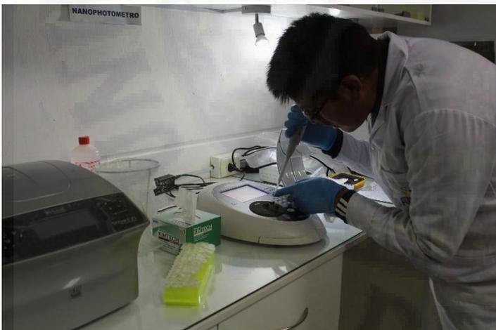
**Foto 102.** Verter lo pipetado sobre el centro de la ventana de medición
