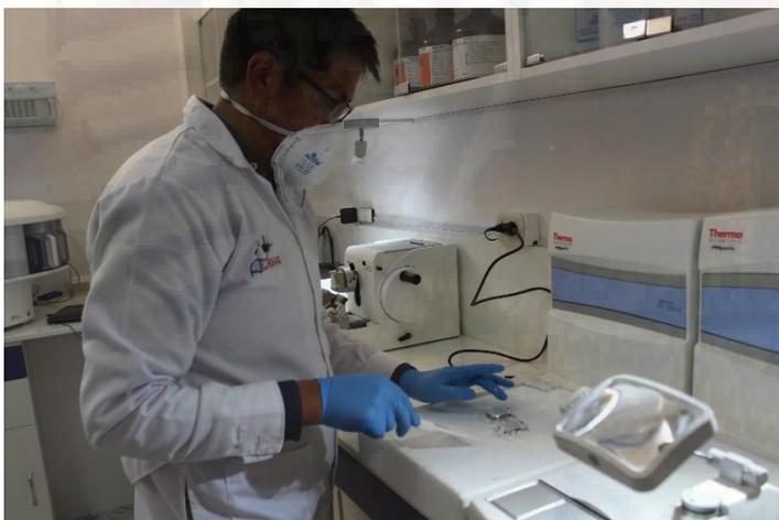
**Foto 42.** Muestras solidificándose en la crio consola del MICROM EC-350
