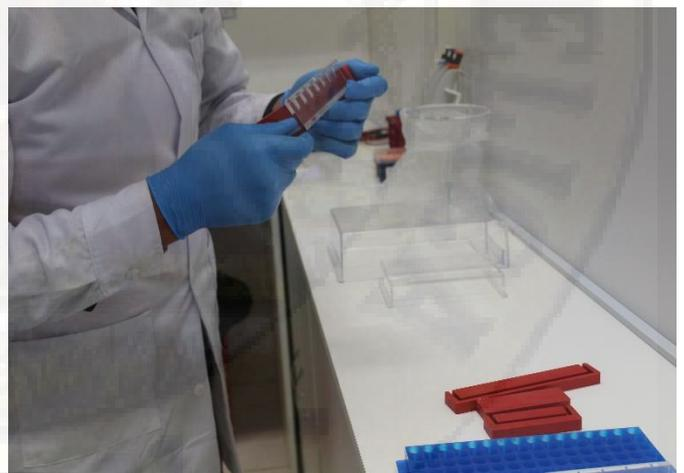
Foto 175. Armar la bandeja plástica, formadora del molde del gel de agarosa
