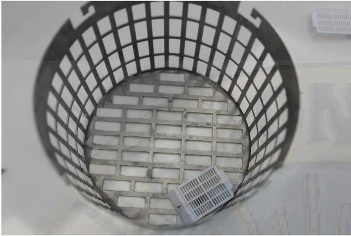
**Foto 28.** Inclusión del caset en la rejilla del equipo MICROM STP-120
