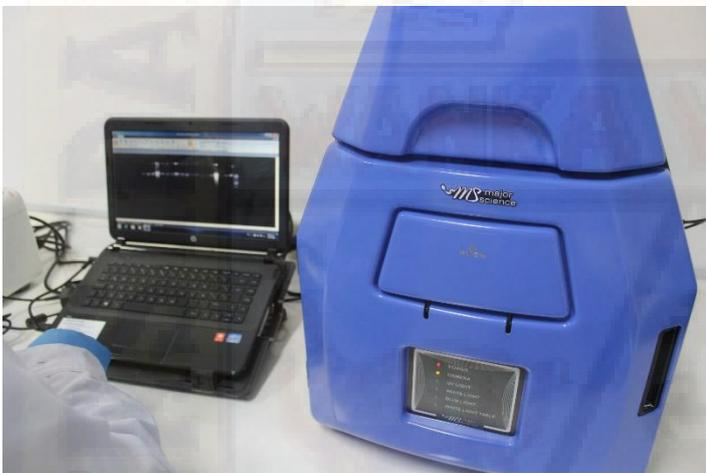
**Foto 196.** Cerrar la bandeja, encender LUZ UV y activar la INTENSIDAD DE UV, dar captura de imagen y guardar en la carpeta deseada.
