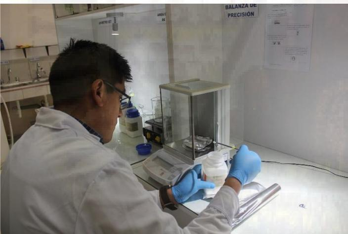
Foto 162. Pesar con papel aluminio los reactivos anteriores, 54gr de tris base, 27.5gr de ácido bórico, 3.72gr de EDTA y 1000 ml de agua ultrapura.
