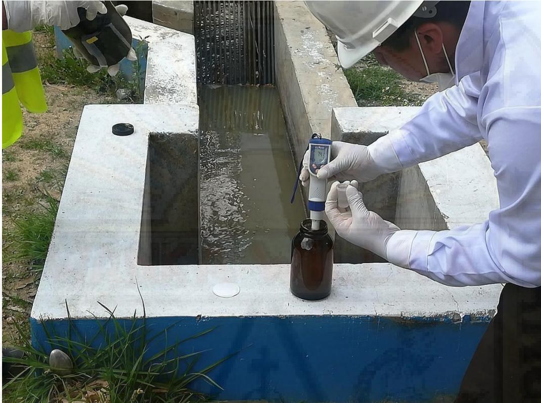
**Apéndice 12. Toma de muestra del afluente de la PTAR**
