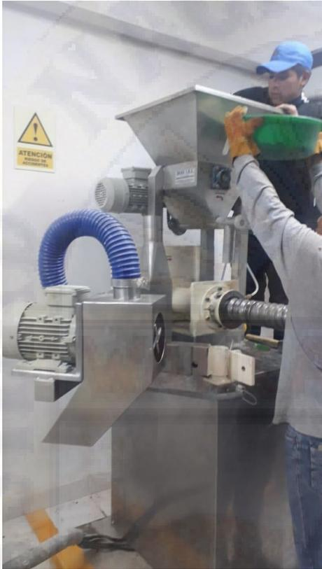
**Fotografía 1.** Proceso de extrusión.
