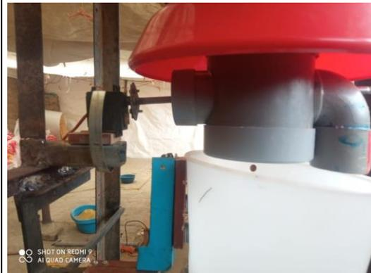
Instalación del motor que acciona el gusano que alimenta el contenedor de peso
