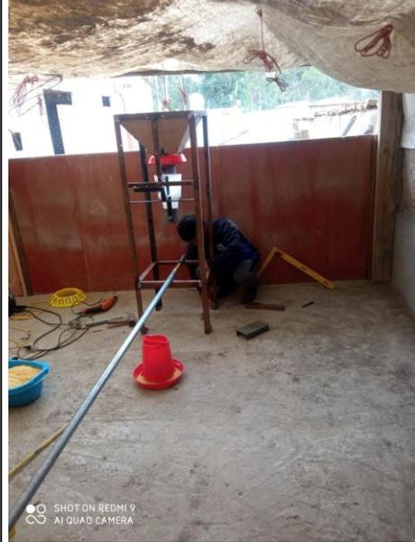
Instalando el tornillo sinfín dentro del tubo de soporte
