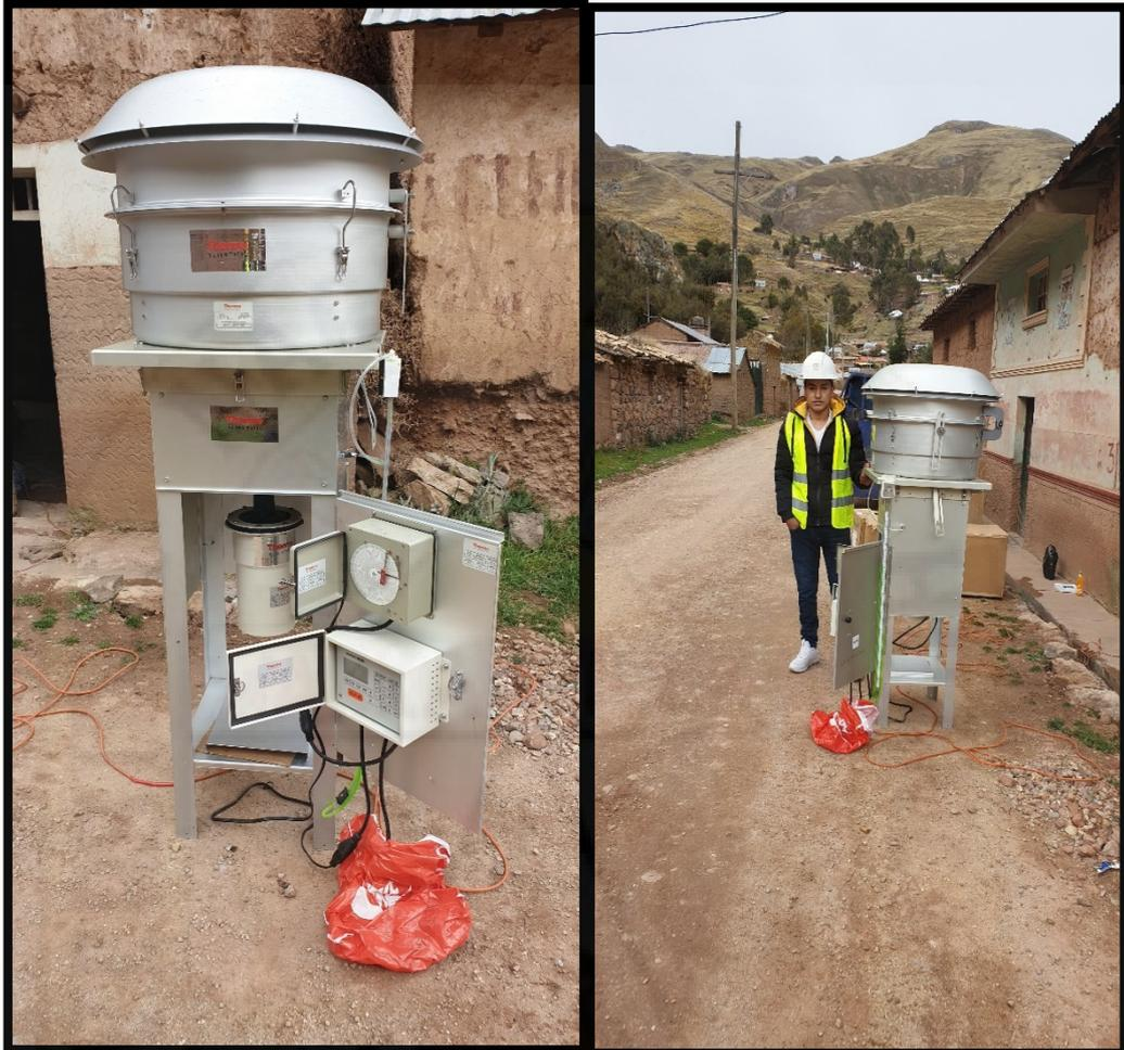
Figure 4 Equipo H-VOL instalado fuente: propia Figure 2 Medición de calidad de aire fuente:propia
