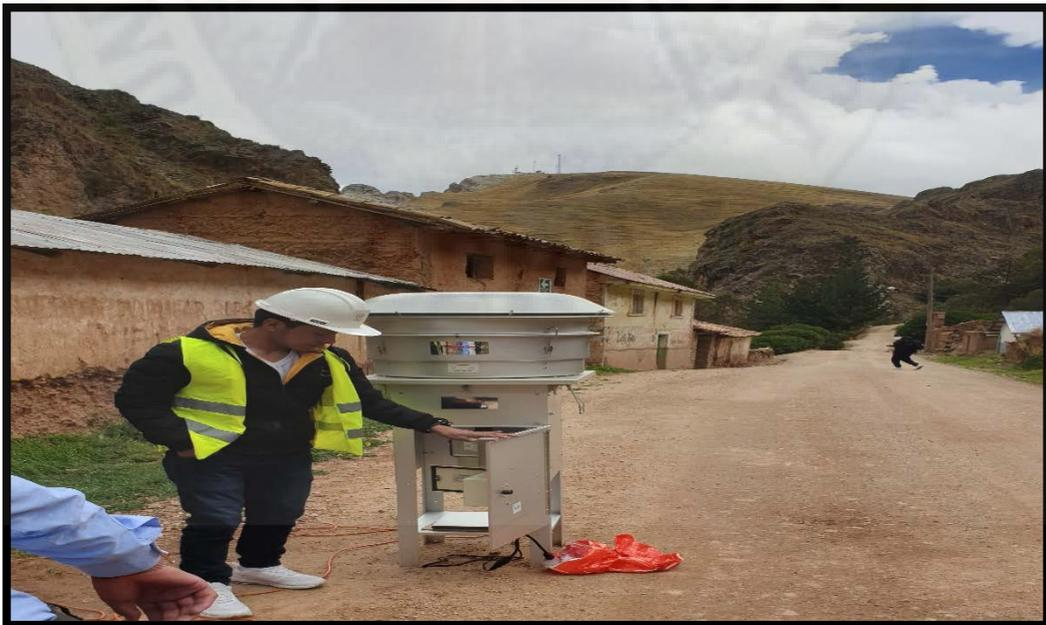
Figure 3 Medición de calidad de aire con el equipo H-VOL fuente:propia
